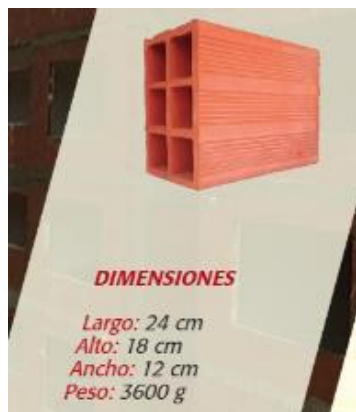
Figura 1 Dimensiones de ladrillo de 6H
