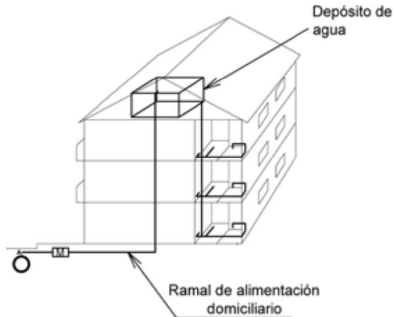
Figura 2.2. Sistema de abastecimiento domiciliario indirecto sin bombeo.
