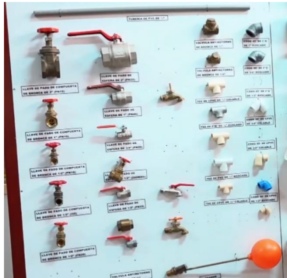
Figura 3.3. Tablero de accesorios de agua potable.
