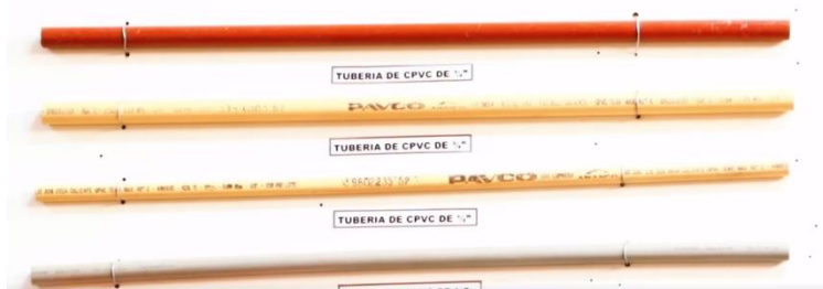
Figura 3.2. Tablero de tuberías de agua potable.
