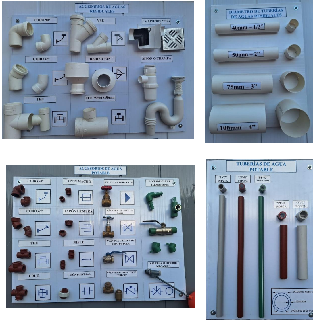
Figura 3.28. Tableros de tuberías y accesorios de instalaciones hidrosanitarias.
