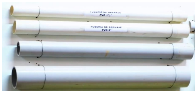
Figura 3.6. Tuberías de drenaje.
