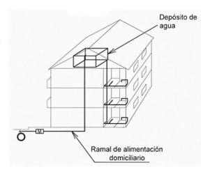
condiciones de presión y/o caudal de la red pública pueden ser discontinuas e insuficientes para abastecer a los diferentes puntos de consumo del inmueble.
