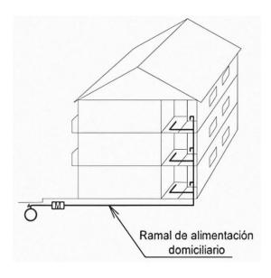
El Sistema Directo de Abastecimiento de Agua es aquel en el cual los puntos o artefactos sanitarios de utilización son conectados a una red de distribución alimentada directamente por la red pública de Agua potable. Para la selección de este Sistema de Presión de servicio y caudal suficientes en la red pública para satisfacer la demanda de los caudales máximos probables de los diferentes puntos de consumo.
