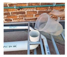
4) Medir el nivel del agua en el interior de las prolongaciones (tuberías) con una regla o metro.
