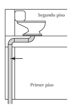
dirección en una bajante, estos deben ser realizados con piezas que formen un ángulo central de curvatura igual o inferior a 90°, de preferencia con curvas de radio largo o dos curvas de 45°.
