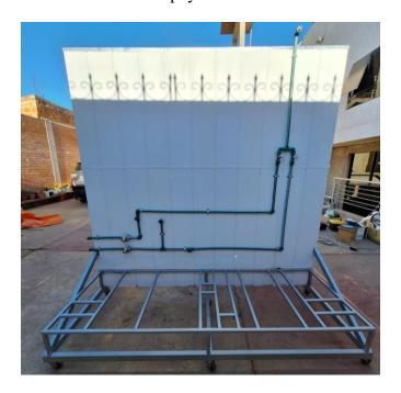
❖ Tubería y accesorios de PVC que se utilizó en la instalación del sistema de evacuación de aguas residuales.
