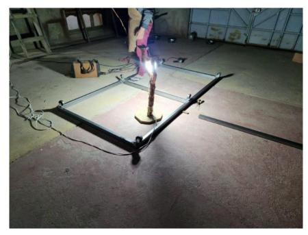
Unión de las dos partes de la estructura de metal y colocado de apoyos
