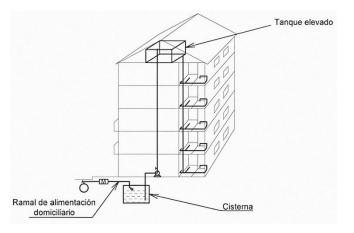
cuando las condiciones de presión y/o caudal de la red pública son insuficientes para alimentar a un tanque elevado en forma directa.
