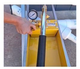
7) Llenar los conductos y asegurando la evacuación del aire por el punto más alto del tramo a ensayarse.
