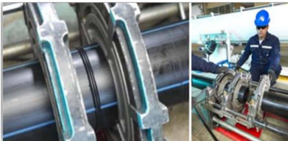
Figura 4. Equipo de unión por termofusión de tuberías PEAD. Fuente: Plastiforte, 2015, pág. 15
