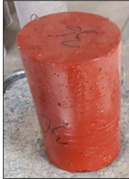
*Figura N°53: Probeta de Hormigón con Aditivo Sikaguard Antiácido Después de 120 Días de Sumersión.*
