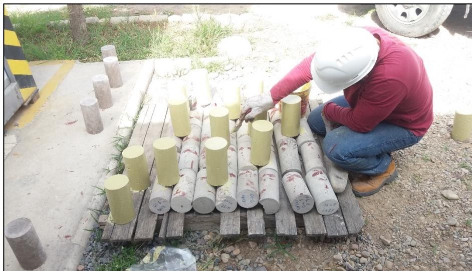
*Figura N°26: Impermeabilización de Probetas de Hormigón con Aditivo Sikaguard 63 CL.*
