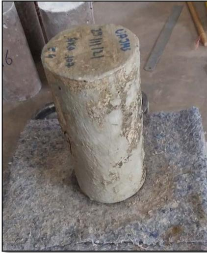
*Figura N°48: Probeta de Hormigón con Aditivo Sikatop 107 Seal Después de 90 Días de Sumersión.*
