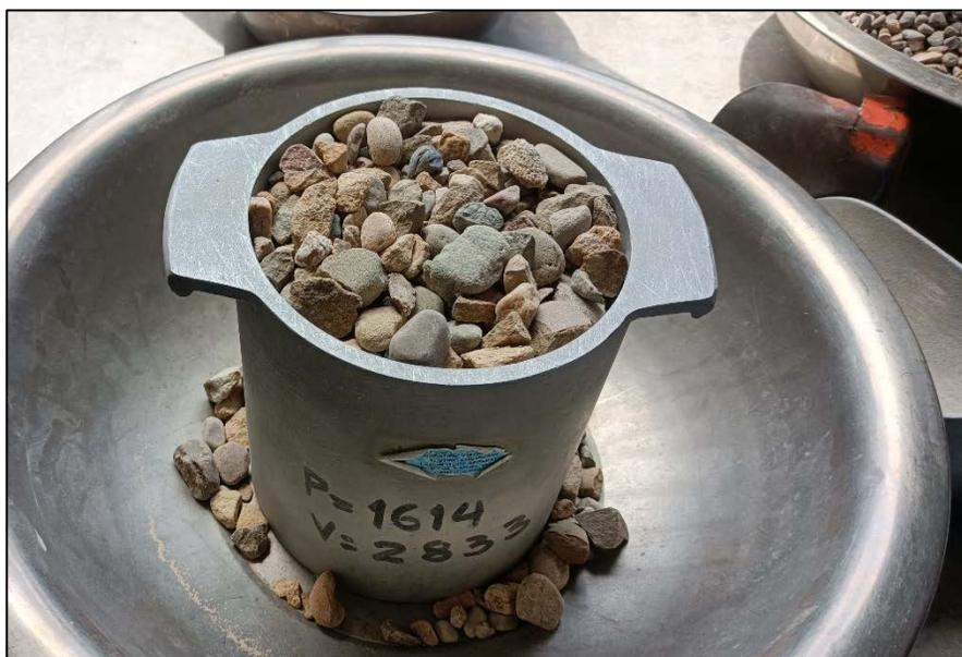
*Figura N°20: Realización de Ensayo de Peso Unitario del Agregado Grueso.*
