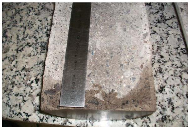
*Figura N°32: Profundidad de Penetración de Agua Bajo Presión.*
