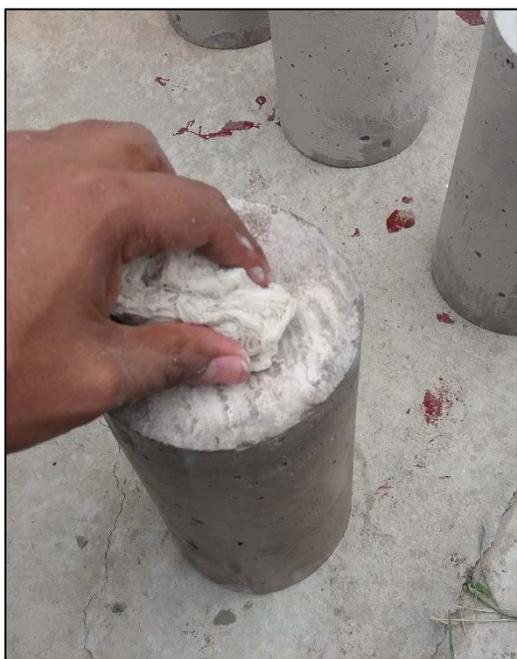
*Figura N°24: Humectado de Probetas.*
