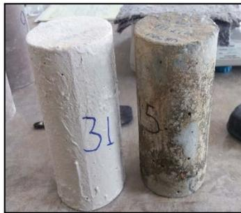
*Figura N°46: Probeta de Hormigón con Aditivo Sikatop 107 Seal Después de 30 Días de Sumersión.*
