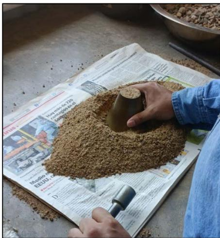
*Figura N°15: Ensayo de Peso Específico Superficialmente Seco del Agregado Fino*
