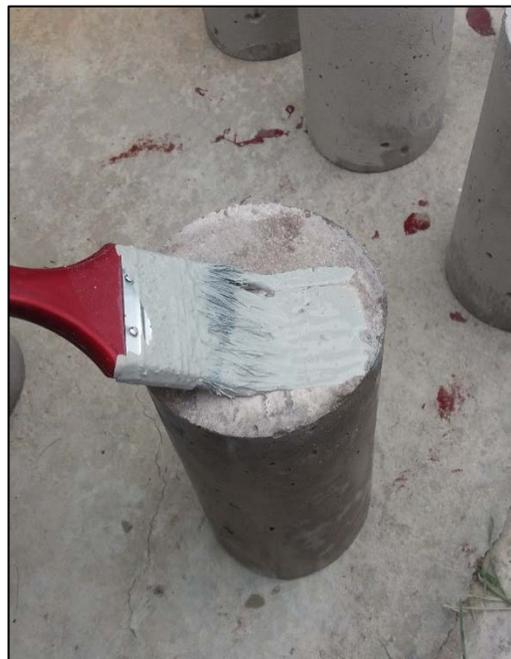
*Figura N°25: Colocado de Aditivo Sikatop 107 Seal.*
