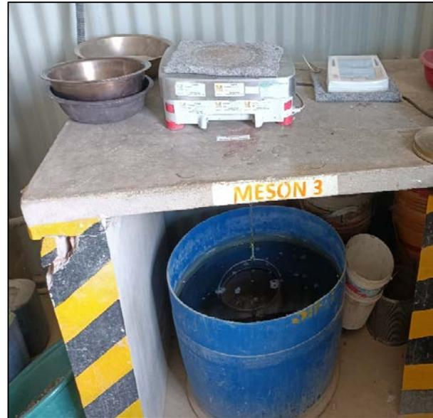
*Figura N°18: Pesado del Agregado Saturado*
