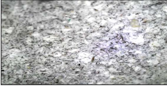
*Figura N°67: Imagen de Superficie de Probeta Con Aditivo Sika WT 200 P en Microscopio Después de 180 Días de Sumersión en Agua Residual Doméstica*
