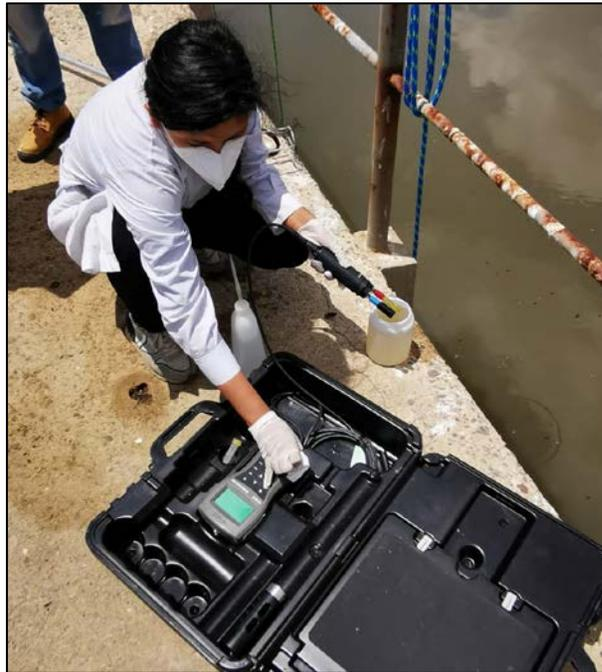
*Figura N°29: Lectura de Parámetros In Situ Con Equipo Multiparamétrico.*
