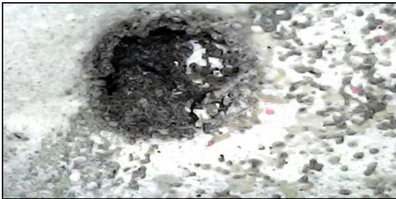
*Figura N°69: Imagen de Superficie de Probeta Con Aditivo Sikatop 107 Seal en Microscopio Después de 180 Días de Sumersión en Agua Residual Doméstica*
