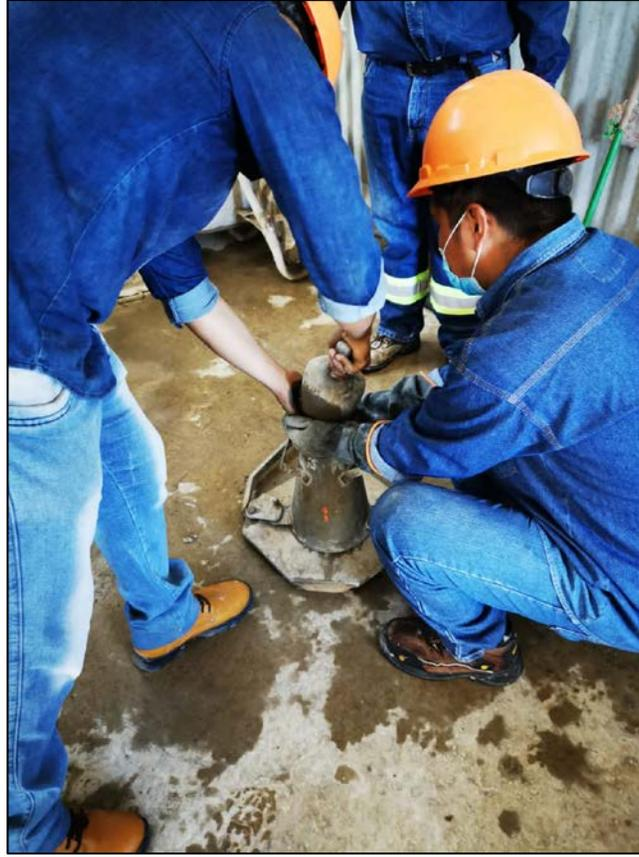
*Figura N°21: Realización del Ensayo del Cono de Abrams Para Verificar Asentamiento.*
