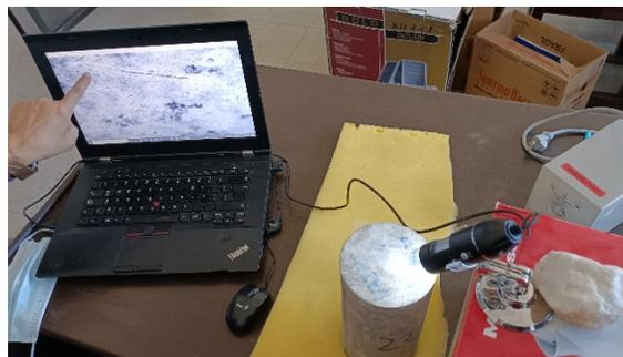
*Figura N°62: Análisis de Probetas de Hormigón en Microscopio*
