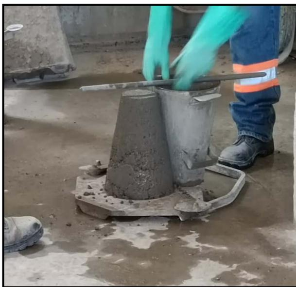
*Figura N°3: Ensayo de Cono de Abrams.*
