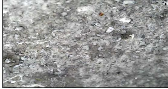
*Figura N°68: Imagen de Superficie de Probeta Con Aditivo Sika WT 200 P en Microscopio Después de 180 Días de Sumersión en Agua Residual Doméstica*
