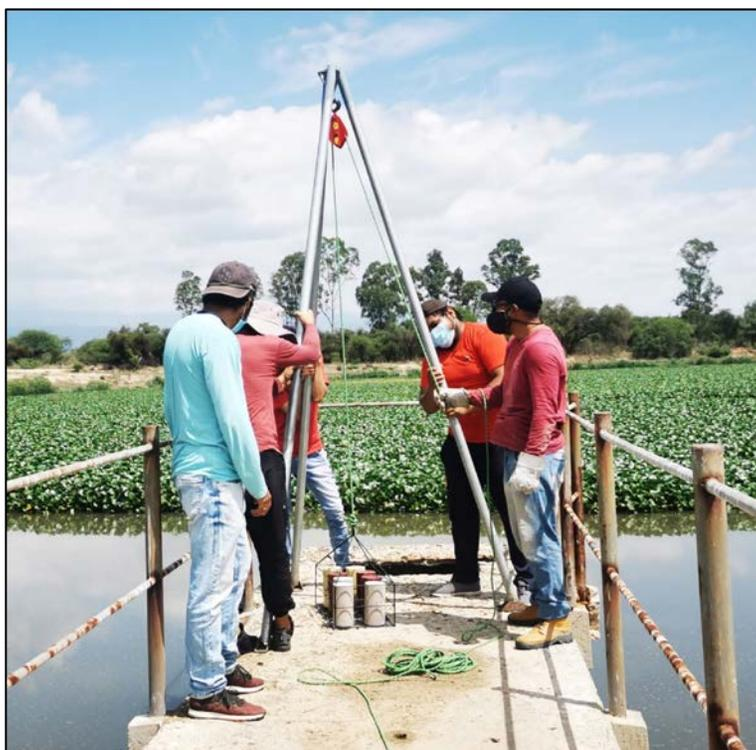
*Figura N°27: Sumersión de Jaulas con Probetas de Hormigón en Agua Residual Doméstica.*
