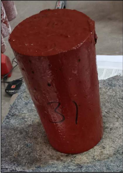
*Figura N°52: Probeta de Hormigón con Aditivo Sikaguard Antiácido Después de 90 Días de Sumersión.*
