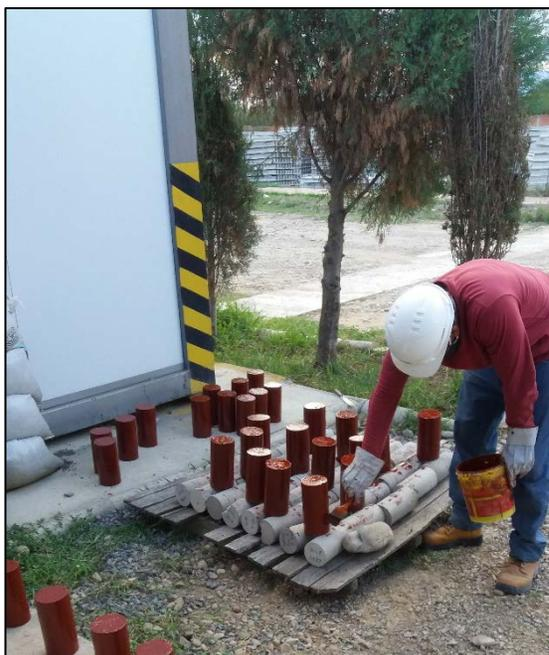
*Figura N°23: Colocado de Aditivo Impermeabilizante Sikaguard Antiácido.*
