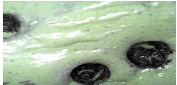
*Figura N°74: Imagen de Superficie de Probeta Con Aditivo Sikaguard 63 cl en Microscopio Después de 180 Días de Sumersión en Agua Residual Doméstica*
