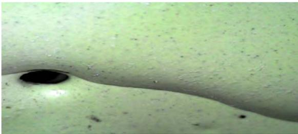
*Figura N°73: Imagen de Superficie de Probeta Con Aditivo Sikaguard 63 cl en Microscopio Después de 180 Días de Sumersión en Agua Residual Doméstica*
