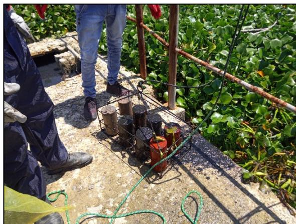
*Figura N°30: Extracción de Probetas de Hormigón.*
