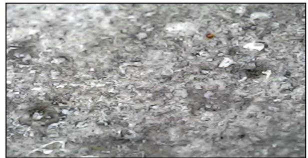
*Figura N°66: Imagen de Superficie de Probeta Sin Aditivo en Microscopio Después de 180 Días de Sumersión en Agua Residual Doméstica*
