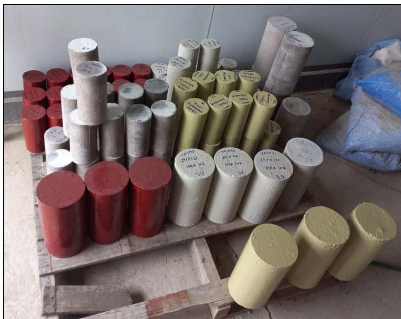
*Figura N°8: Probetas de Hormigón con sus Respective Aditivo Impermeabilizantes.*
