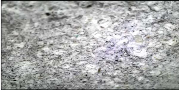
*Figura N°65: Imagen de Superficie de Probeta Sin Aditivo en Microscopio Después de 180 Días de Sumersión en Agua Residual Doméstica*
