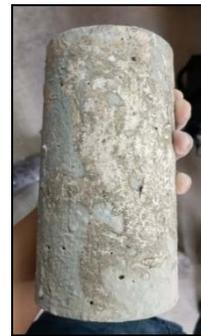
*Figura N°47: Probeta de Hormigón con Aditivo Sikatop 107 Seal Después de 60 Días de Sumersión.*
