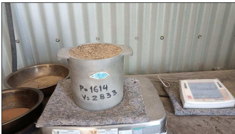
*Figura N°19: Pesado de Agregado Fino sin Compactar.*
