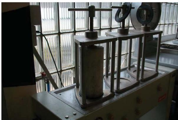
*Figura N°31: Ensayo de Penetración de Agua Bajo Presión.*
