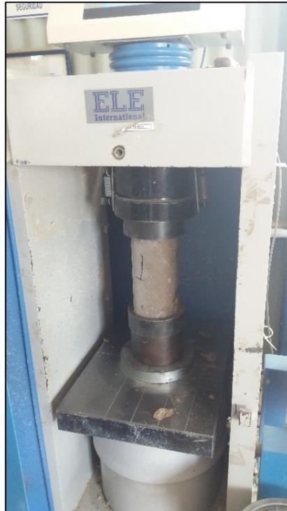
*Figura N°22: Ensayo a Compresión de Probetas de Hormigón.*
