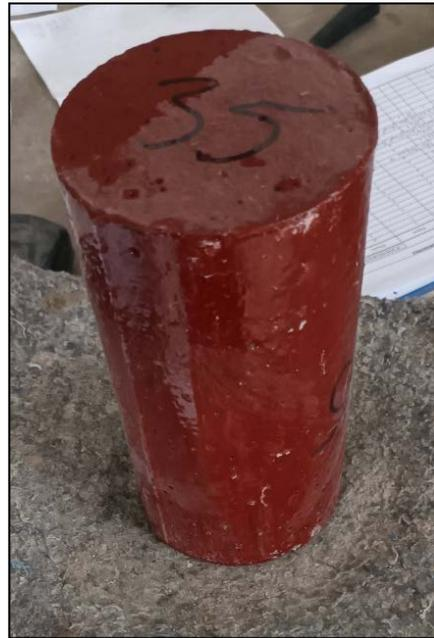
*Figura N°51: Probeta de Hormigón con Aditivo Sikaguard Antiácido Después de 60 Días de Sumersión.*
