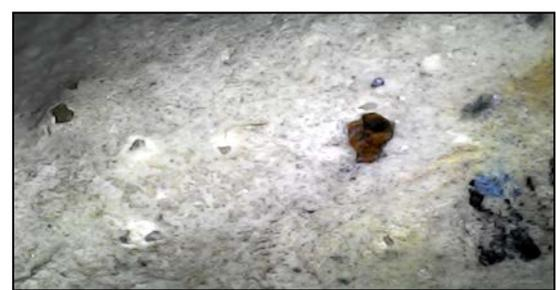
*Figura N°70: Imagen de Superficie de Probeta Con Aditivo Sikatop 107 Seal en Microscopio Después de 180 Días de Sumersión en Agua Residual Doméstica*
