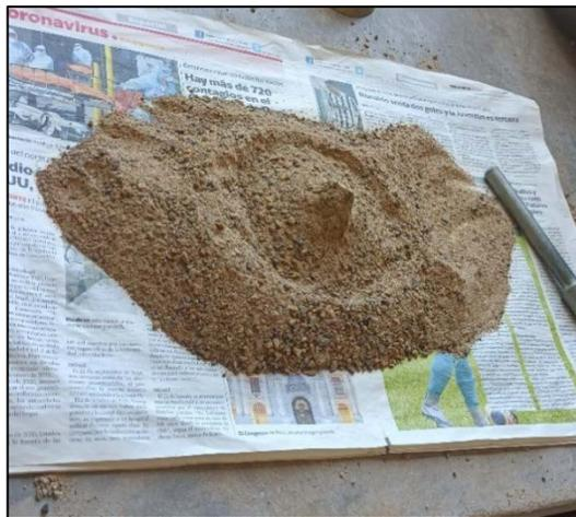
*Figura N°16: Ensayo de Peso Específico Superficialmente Seco del Agregado Fino*
