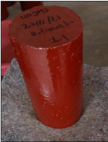
*Figura N°50: Probeta de Hormigón con Aditivo Sikaguard Antiácido Después de 30 Días de Sumersión.*
