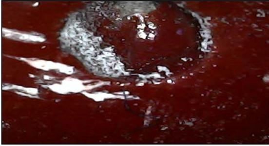
*Figura N°71: Imagen de Superficie de Probeta Con Aditivo Sikaguard Antiácido en Microscopio Después de 180 Días de Sumersión en Agua Residual Doméstica*
