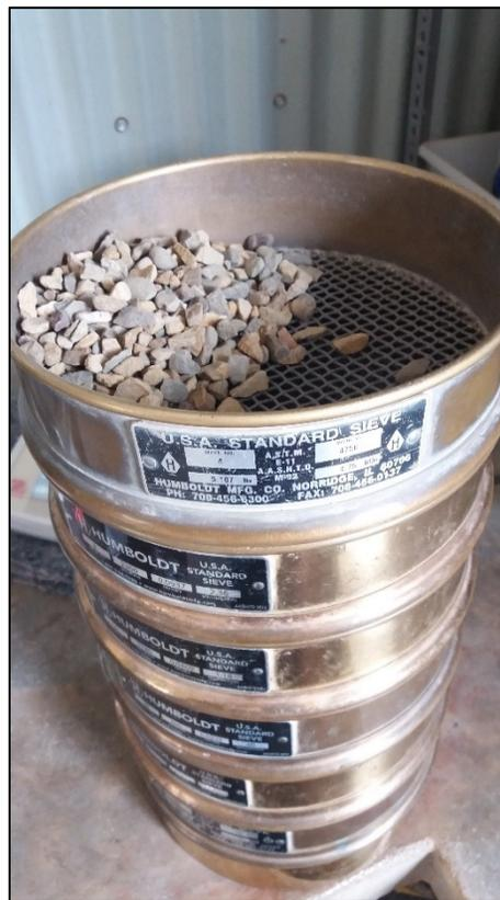
*Figura N°13: Tamizado de Agregado Grueso.*
