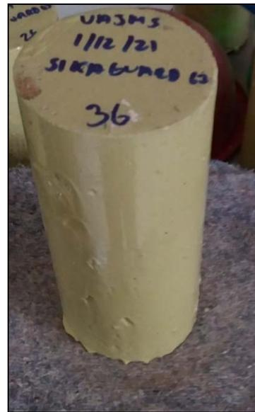
*Figura N°55: Probeta de Hormigón con Aditivo Sikaguard 63 CL Después de 60 Días de Sumersión.*
