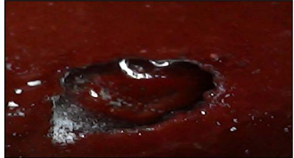
*Figura N°72: Imagen de Superficie de Probeta Con Aditivo Sikaguard Antiácido en Microscopio Después de 180 Días de Sumersión en Agua Residual Doméstica*
