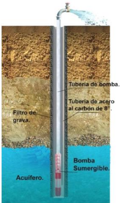
Figura 2 Extracción de agua subterránea mediante sistema de bombeo
