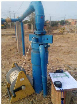
Figura 31 Lectura del nivel estático tomada en campo
