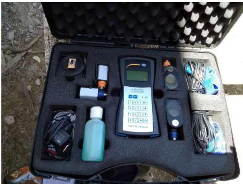
**Figura 12.** Caudalímetro por ultrasonido PCE-TDS 100HS.
