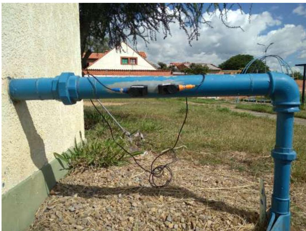
**Figura 16.** *Aforo de caudal en el pozo los Álamos.*
