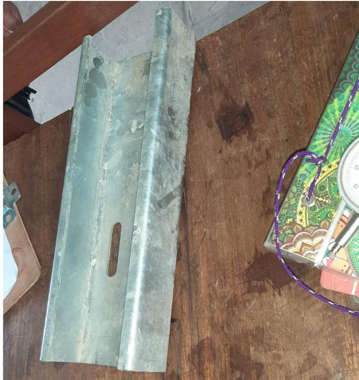
FOTOGRAFIA 11: Componente de la barrera: Separador
