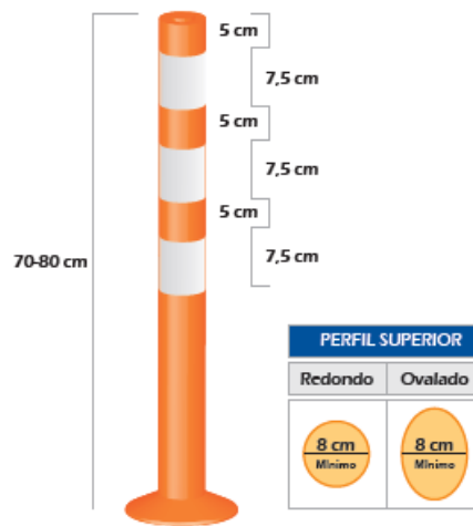
Figura 4.12 Dimensionamiento de las cintas reflectoras del hito
