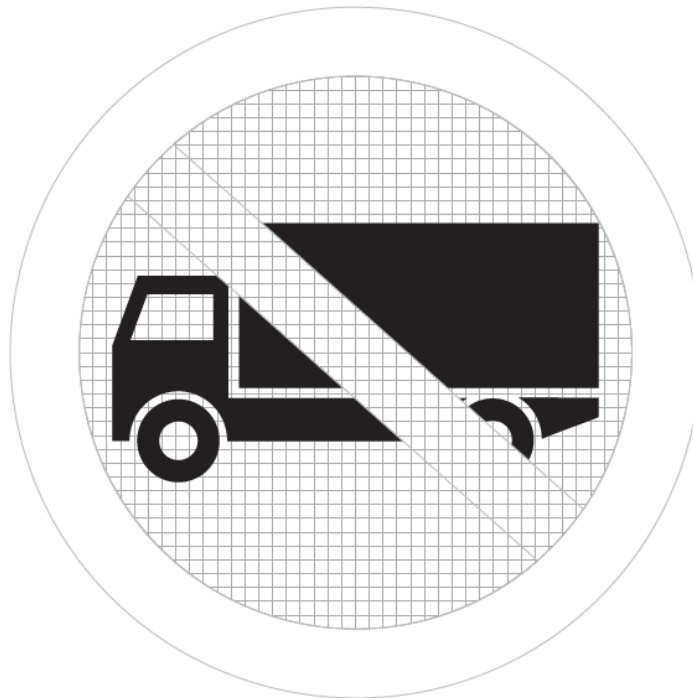
Figura 4.25 Señal vertical de prohibición de vehículos pesados
