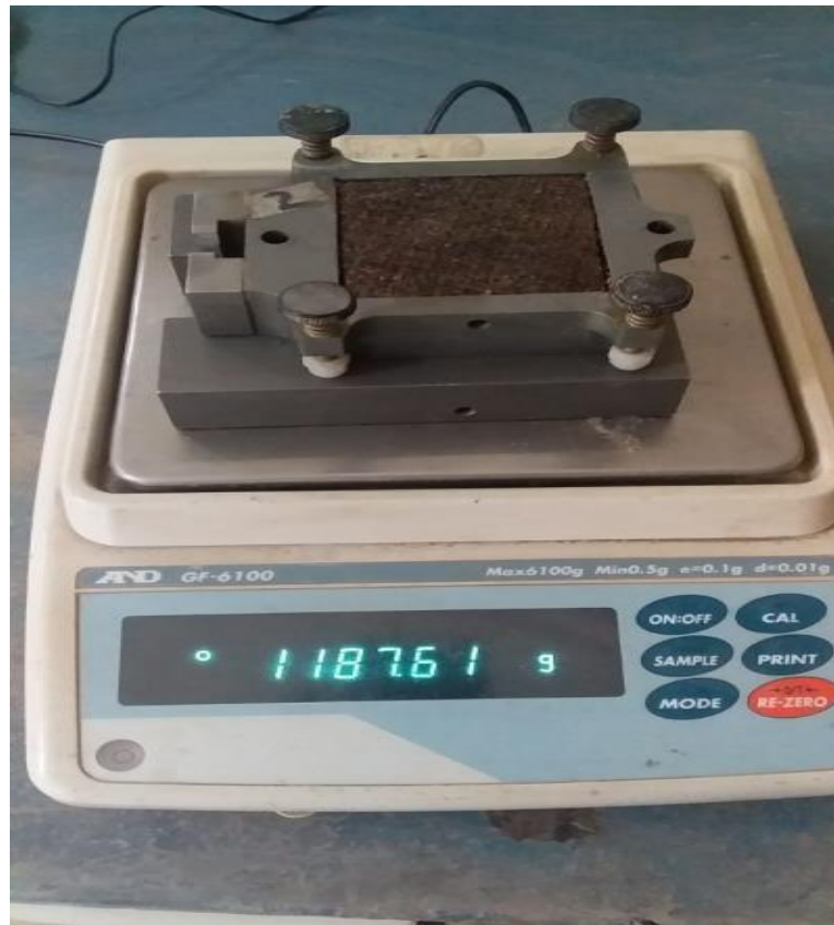
Imagen 10 Pesado de la muestra antes de colocar al equipo de corte directo
