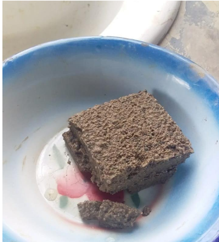
Imagen 11 Falla a la resistencia al corte en el ensayo de corte directo en condiciones consolidadas drenadas.
