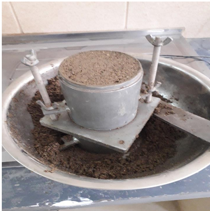
Imagen 6 Enrazado de muestra compactada en el molde T99 ensayo compactación.
