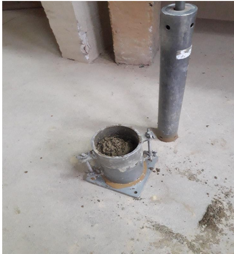
Imagen 5 Pistón y molde T99 para el ensayo de compactación estándar
