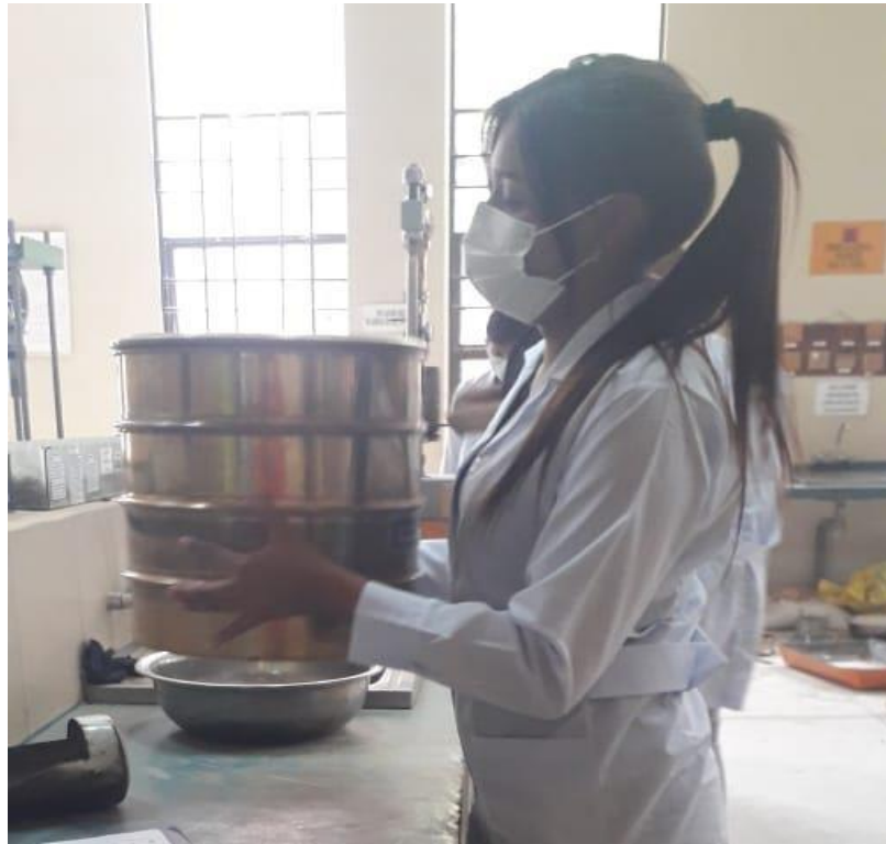
Imagen 3 Tamizado de la muestra para la granulometría
