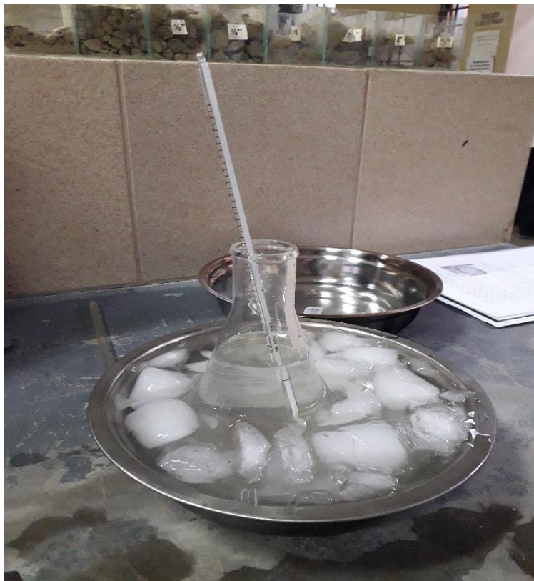
Imagen 4 Calibración del frasco volumétrico para peso específico de los sólidos
