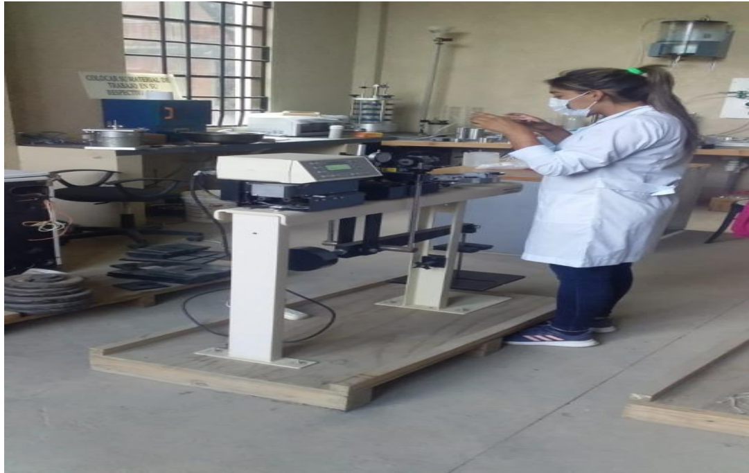
Imagen 9 leyendo en el ensayo de corte directo.
