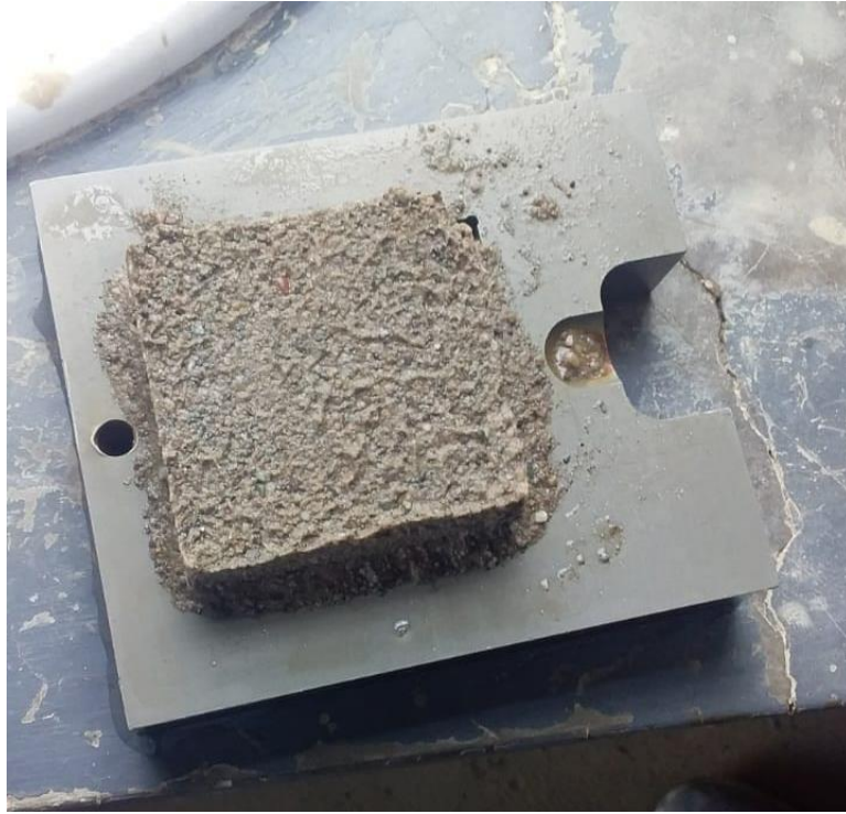
Imagen 11 extraccion de la muestra de suelo del ensayo de corte directo
