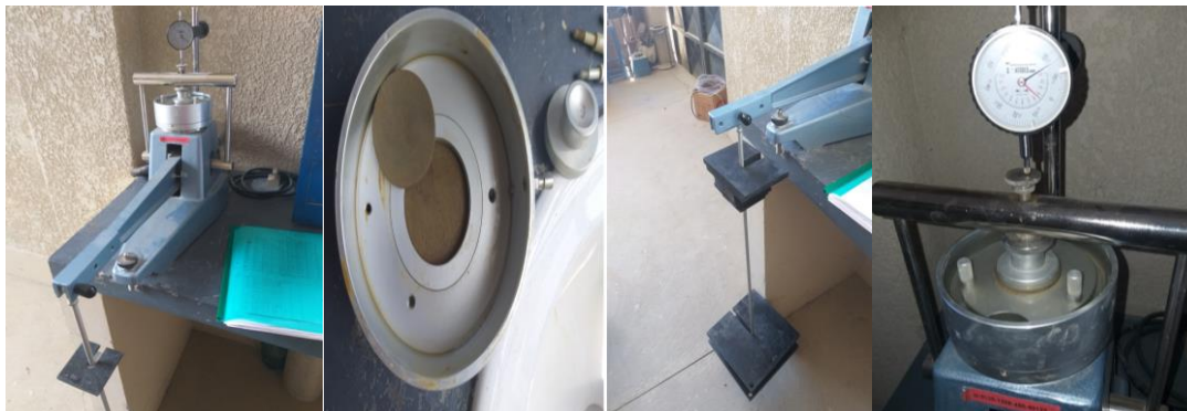
1-Equipo de consolidómetro, piedras porosas, cargas y deformímetro a emplear
