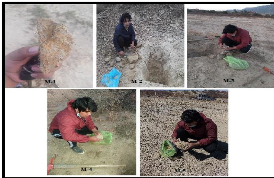
Figura 49. Extracción de muestras inalteradas
