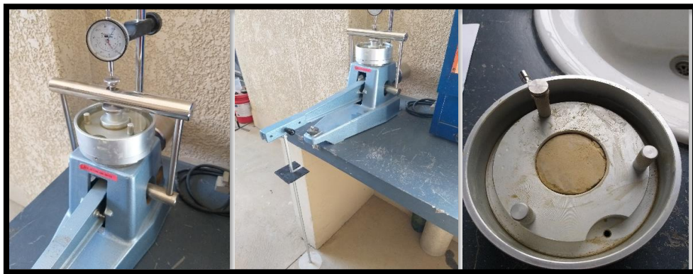
Figura 20. Consolidómetro del laboratorio de la U.A.J.M.S.
