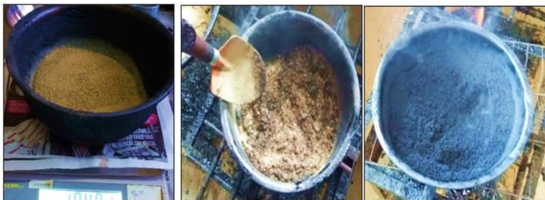
Figura 3.27 Dosificación y obtención de las matrices asfálticas finas
