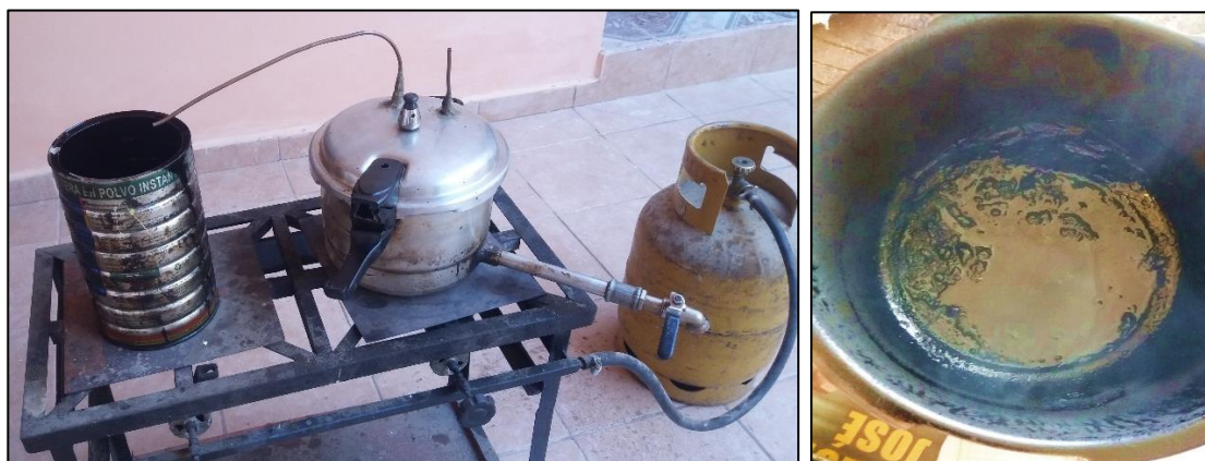
Figura 3.20 Equipo empírico para caracterizar el asfalto espumado
