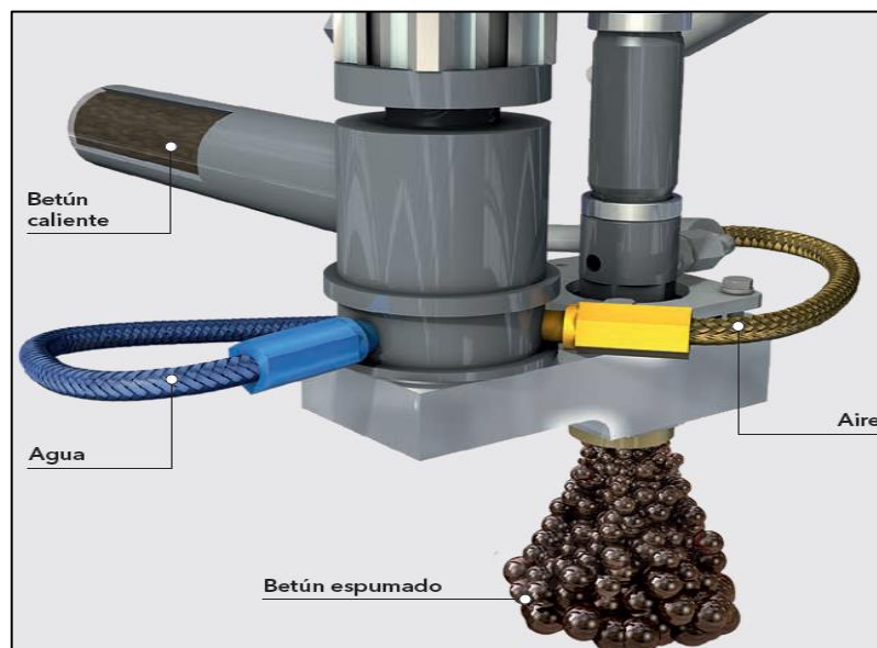
Figura 2.4 Esquema de producción de asfalto espumado
