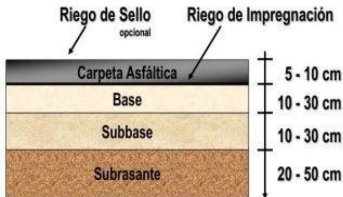
Figura 2.1 Estructura del pavimento flexible
