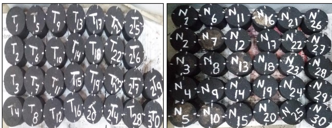
Figura 3.46 Matrices finas con asfalto espumado
