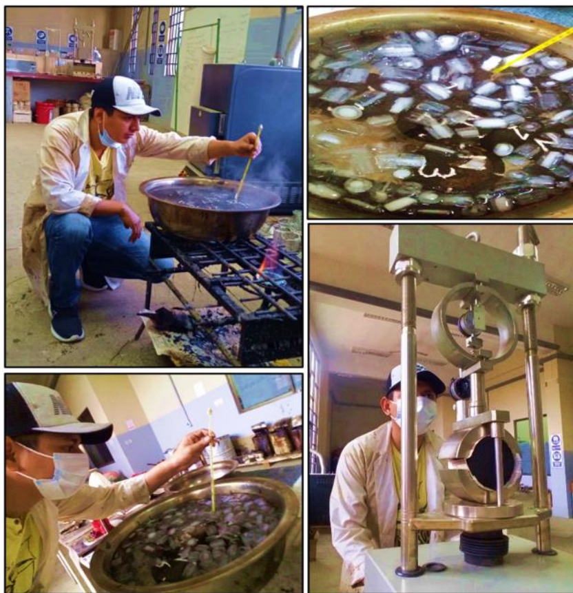
Figura 3.47 Control de temperatura para las roturas
