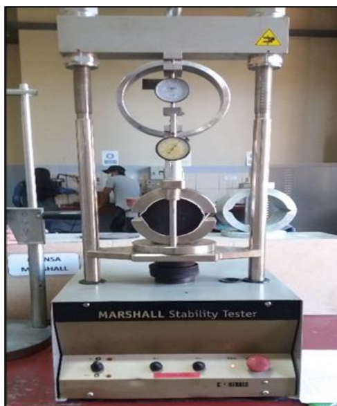
Figura 3.33 Rotura en la prensa Marshall
