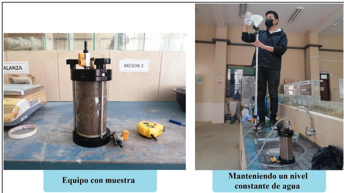
Figura 3.15 Ensayo de permeabilidad
