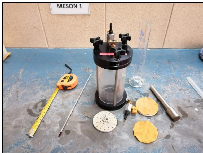
Figura 3.14 Materiales para el ensayo de permeabilidad
