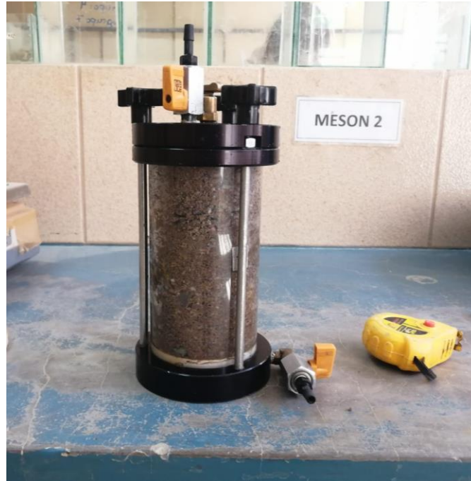
Permeámetro con muestra, al cual se le medirá la longitud de muestra con la ayuda de un flexómetro.
