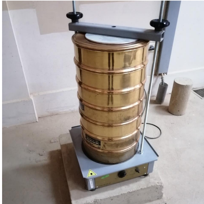
Tamizado de la muestra, con la ayuda de la tamizadora.
