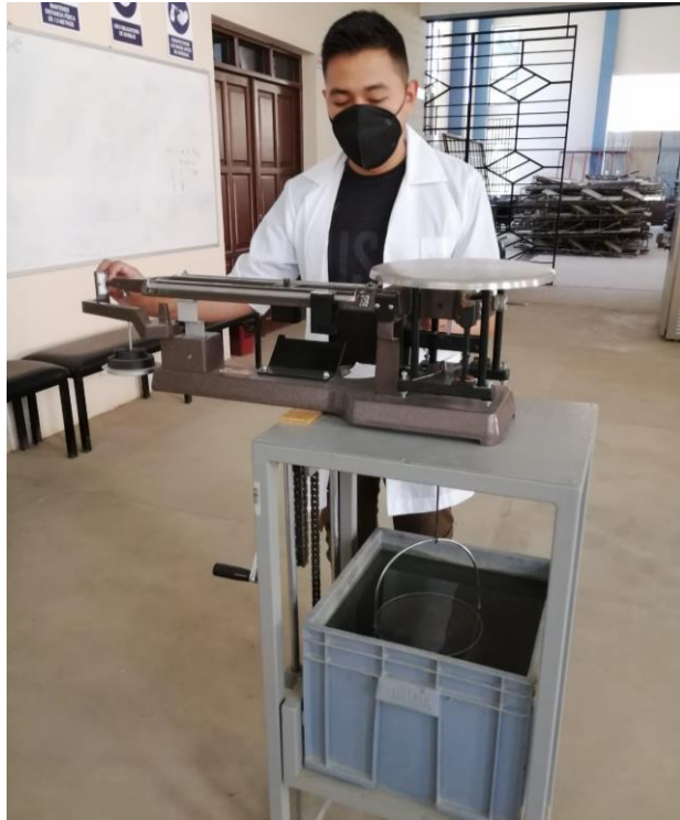
Obtención del peso sumergido de la muestra.
