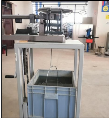
Figura A1.7 Peso sumergido de la muestra
