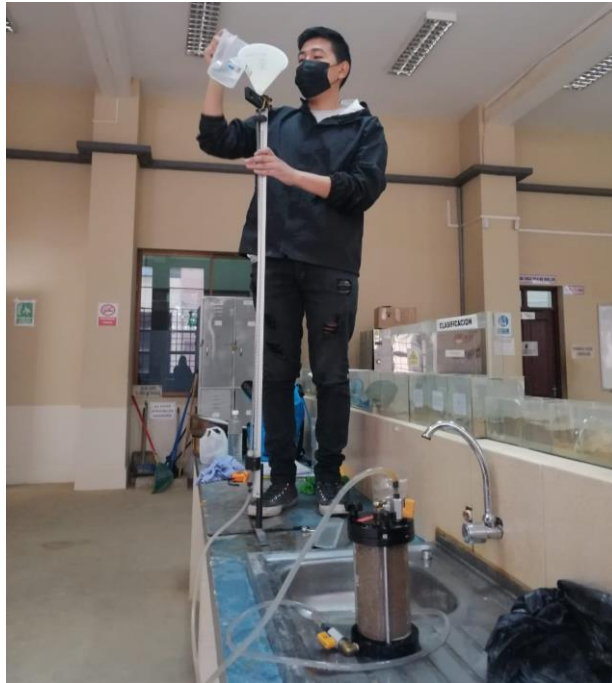
Circulación del agua a través de la muestra, manteniendo un nivel constante.
