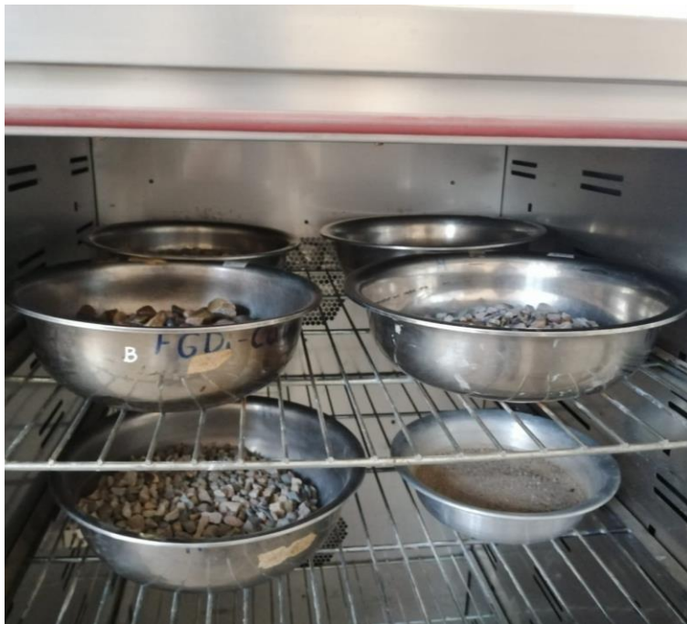
Muestras dentro del horno por 24 horas, para la obtención del peso seco de la muestra.
