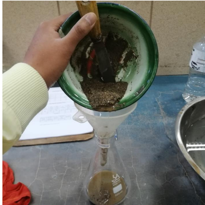
Introducción del suelo al frasco volumétrico.
