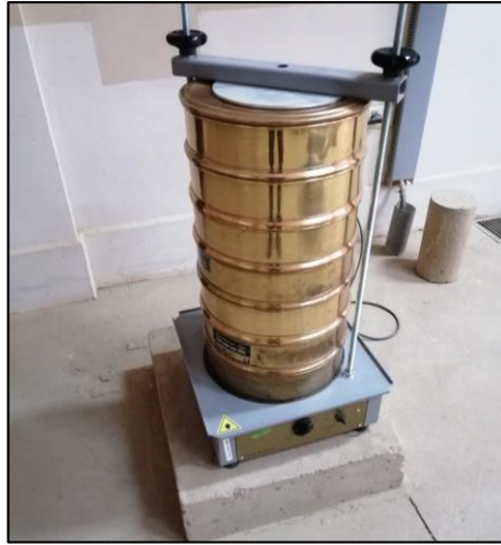
Figura A1.3 Tamizado de la muestra
