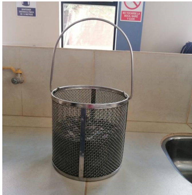
Canastillo con muestra luego de la obtención del peso sumergido.
