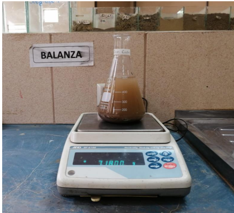
Obtención del Peso del frasco con suelo y agua.
