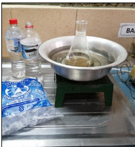
Figura A1.5 frasco con suelo dentro del baño maría
