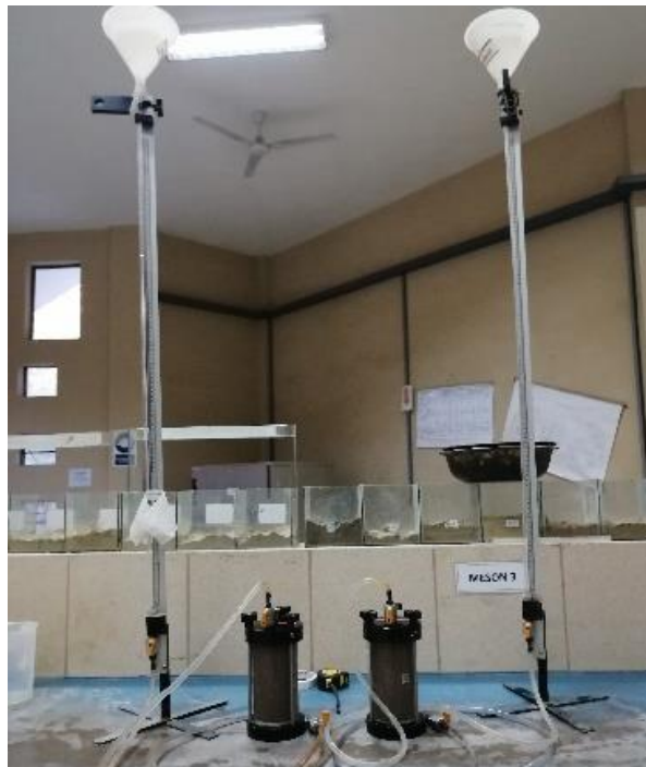
Permeámetros listos para el ensayo.
