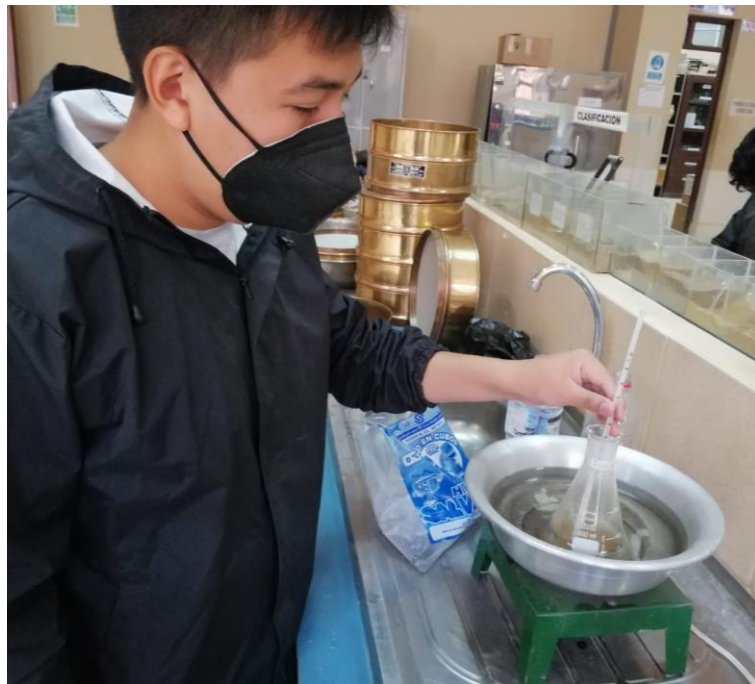
Frasco con suelo sometiéndose a efectos de temperatura dentro de un baño maría, hasta que alcance una temperatura de 60 °C.
