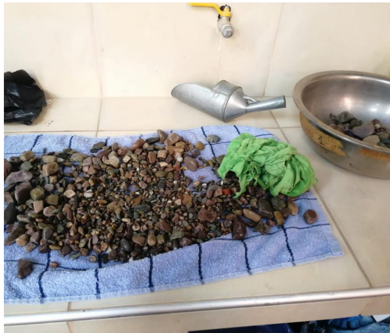
Luego del saturado de la muestra por 24 horas, se realiza en secado superficialmente.
