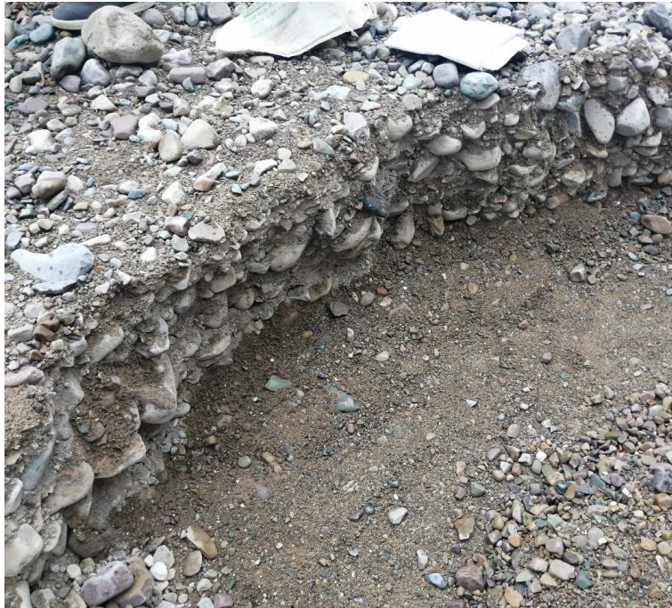
Suelo granular compuesto de grava y arena con poco contenido de fino.
