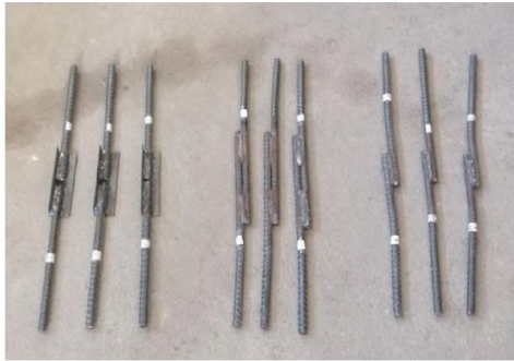
Fotografía 4.5: Probetas listas para soldadura
