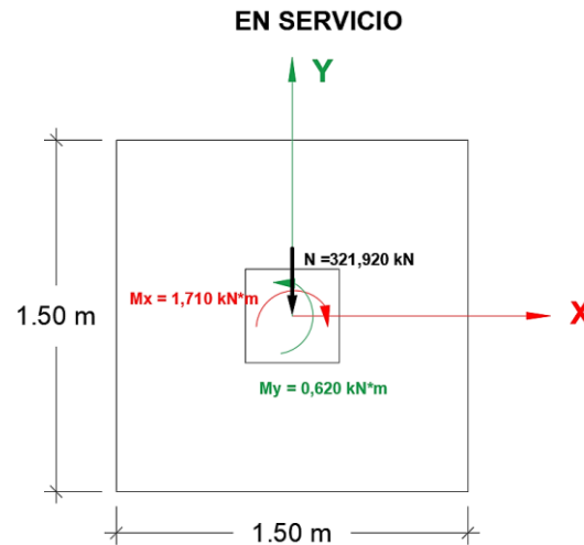
Figura 3.42: Zapata Aislada esfuerzos en servicio
