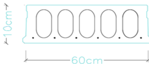
Figura 4.5 Distribución de los cordones en la losa hueca
