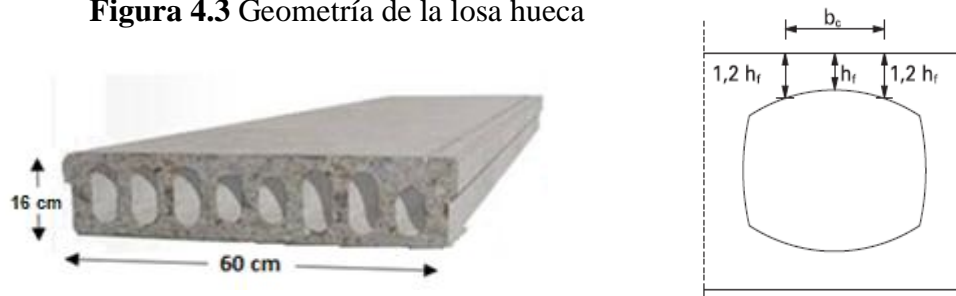
Figura 4.3 Geometría de la losa hueca
