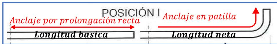
*Ilustración de anclaje en barras corrugadas en posición I [Figura].* Recuperado de
