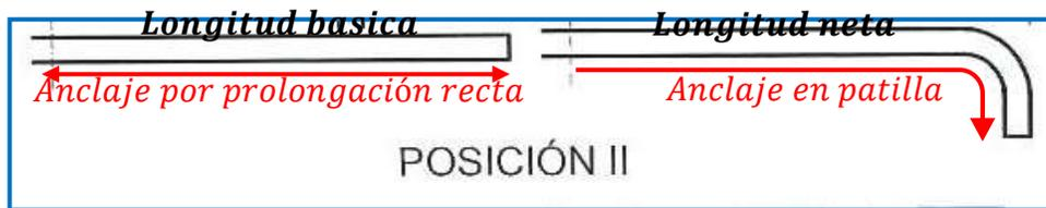
*Ilustración de anclaje en barras corrugadas en posición II [Figura].* Recuperado de <http://todoedificacion.blogspot.com/2012/03/anclaje-de-armaduras.html>
