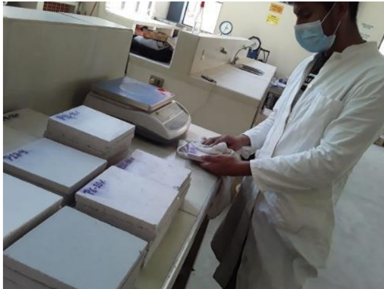
Fotografía 3.28 Secado de las muestras saturadas con franelas
