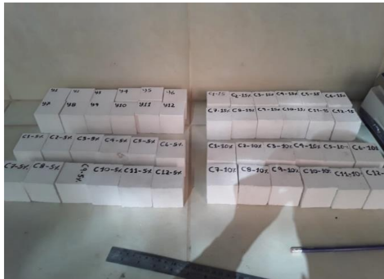
Fotografía 3.21. Muestras para ensayo a compresión
