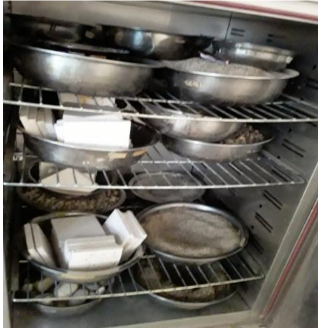
Fotografía 3.30. Muestras saturadas introducidas en el horno para el secado
