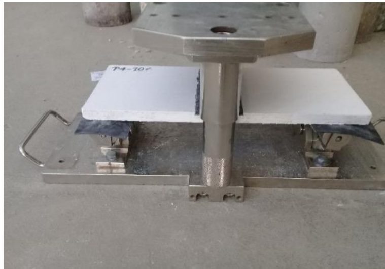
Fotografía 3.18. Equipo para ensayo a flexión
