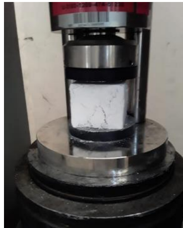
Fotografía 3.24. Muestra de yeso con celulosa ensaya a compresión
