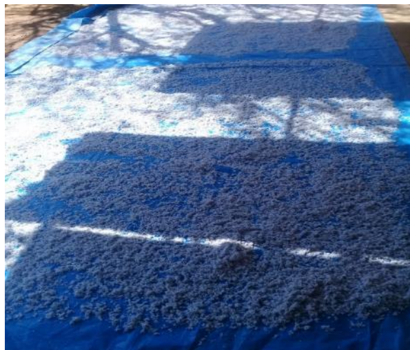
Fotografía 3.14. Proceso de secado de la celulosa
