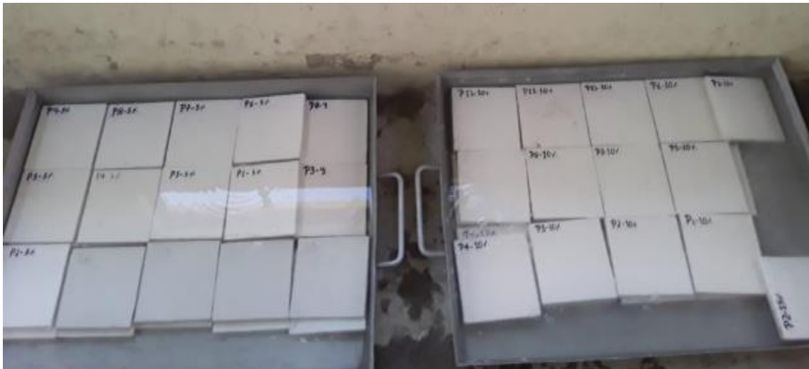
Fotografía 3.27. Muestras sumergidas en bandejas de agua
