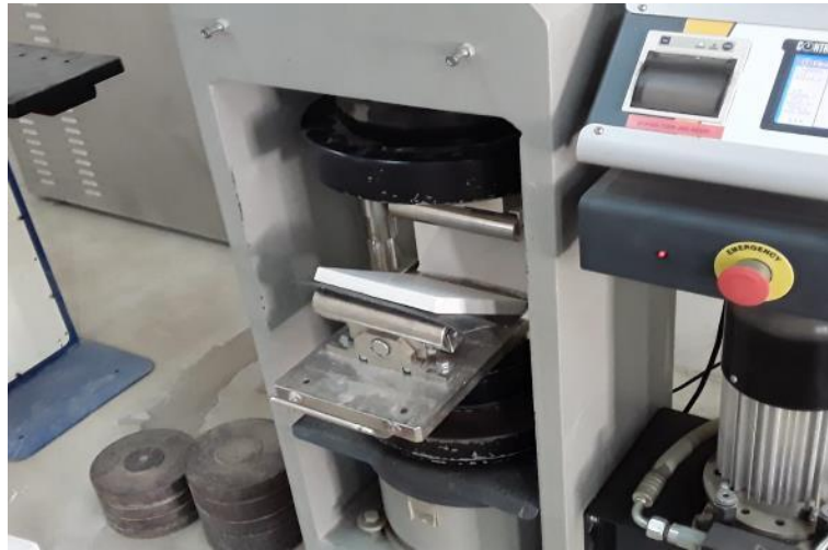
Fotografía 3.2. Ensayo a flexión en laboratorio
