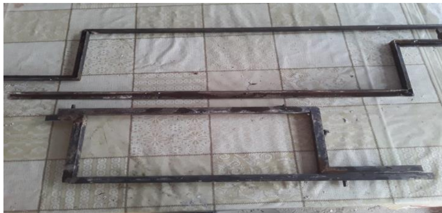
Fotografía 3.1. Moldes para el vaciado de las muestras
