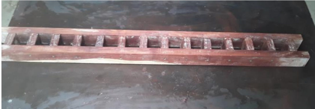
Fotografía 3.5. Molde de madera para el ensayo de compresión
