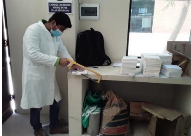
Fotografía 3.25. Recorte de las muestras ensayadas a flexión
