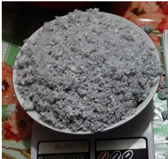
Fotografía 3.15. Peso saturado de la celulosa
