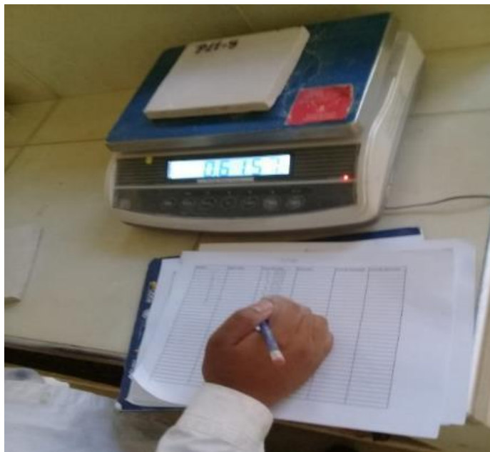
Fotografía 3.29. Registro del peso saturado de las muestras
