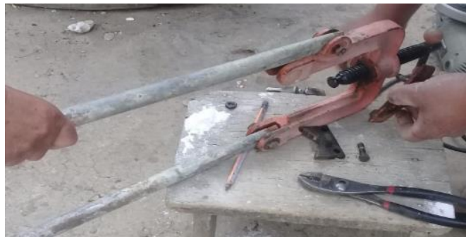
Fotografía 3.6. Armado de la prensa mecánica con los tubos galvanizados
