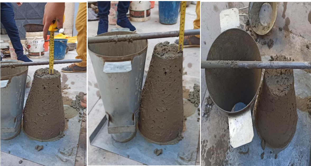
Prueba de asentamiento.
