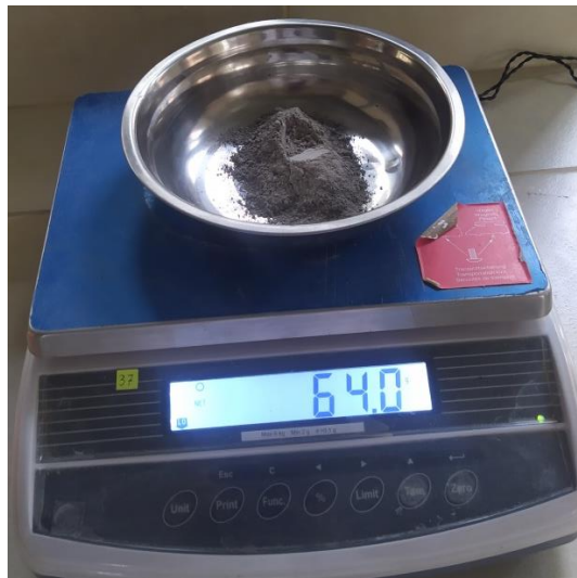
Pesaje de cemento durante el ensayo de peso específico.
