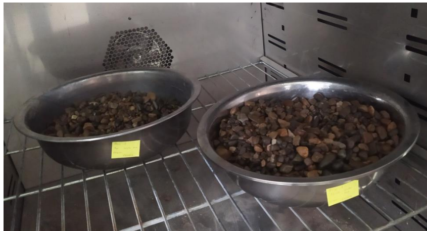
Muestras de agregado grueso puestas a secar en el horno para ensayo de peso unitario de Santa Ana.
