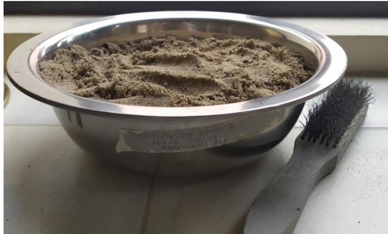
Bandeja metálica con agregado fino de Santa Ana para usar en granulometría.
