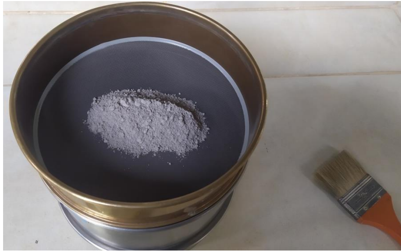
Tamizado de muestra de cemento durante el ensayo de módulo de finura.
