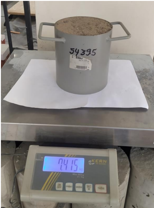
Molde cilíndrico con agregado fino compactado de Santa Ana pesado en balanza en ensayo de peso unitario.
