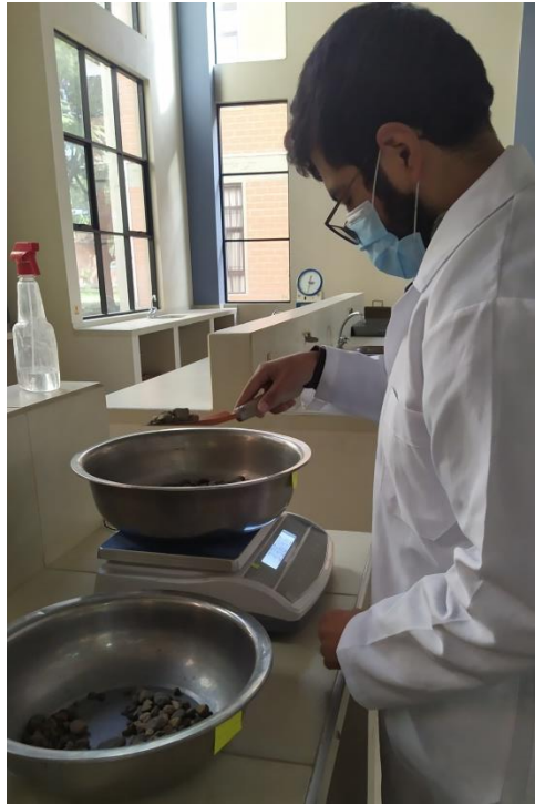
Pesaje de agregado grueso para ensayo de peso específico de Santa Ana.
