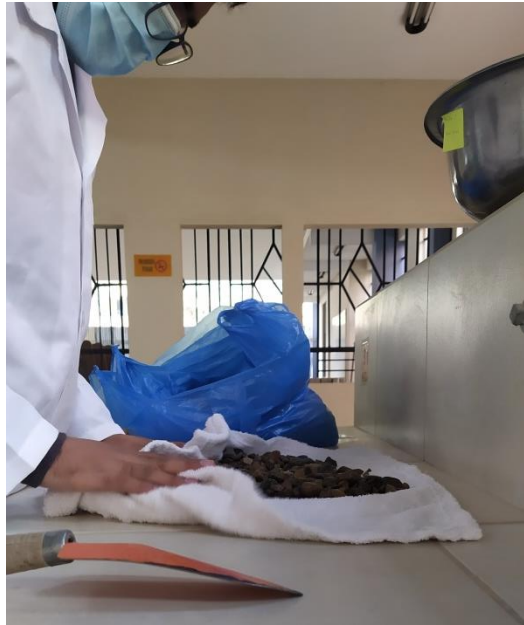
Secado superficial de agregado grueso de Sella para utilizar en ensayo de peso específico.
