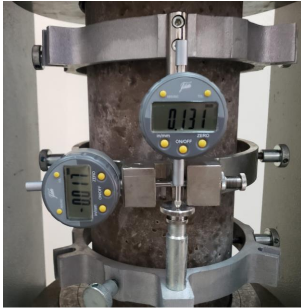
Probeta con deformómetro el cual registra la deformación de la probeta en la máquina de compresión.
