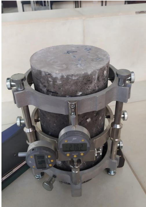
Compresómetro colocado a la probeta - Sella.
