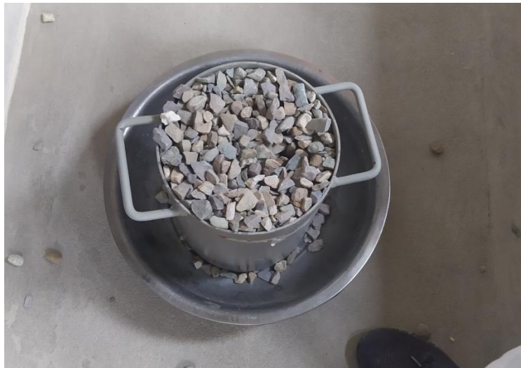
Agregado grueso en molde cilíndrico de 10 litros para determinar peso unitario de Bella Vista.
