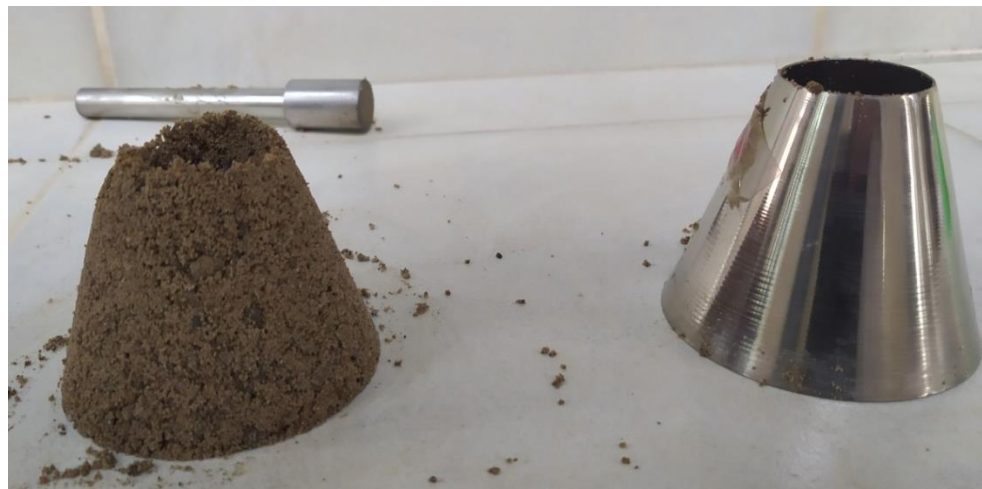
Ensayo del peso específico del agregado fino de Santa Ana.
