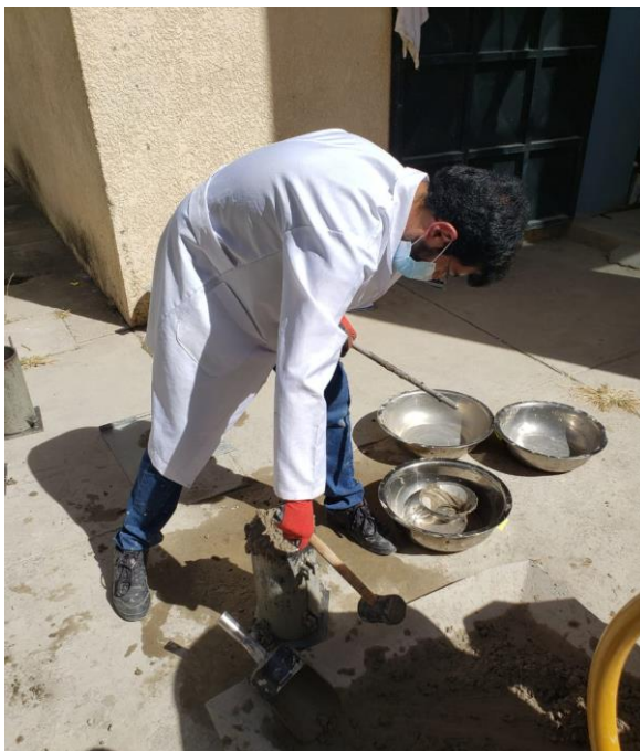
Uso del combo para reducir la cantidad de vacíos durante elaboración de probetas.
