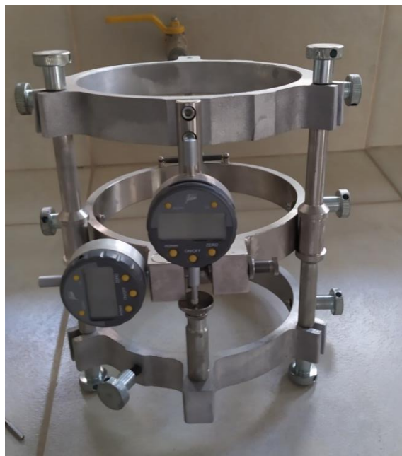
Compresómetro con extensómetro y deformómetros incorporados, perteneciente al laboratorio de hormigón de la U.A.J.M.S.
