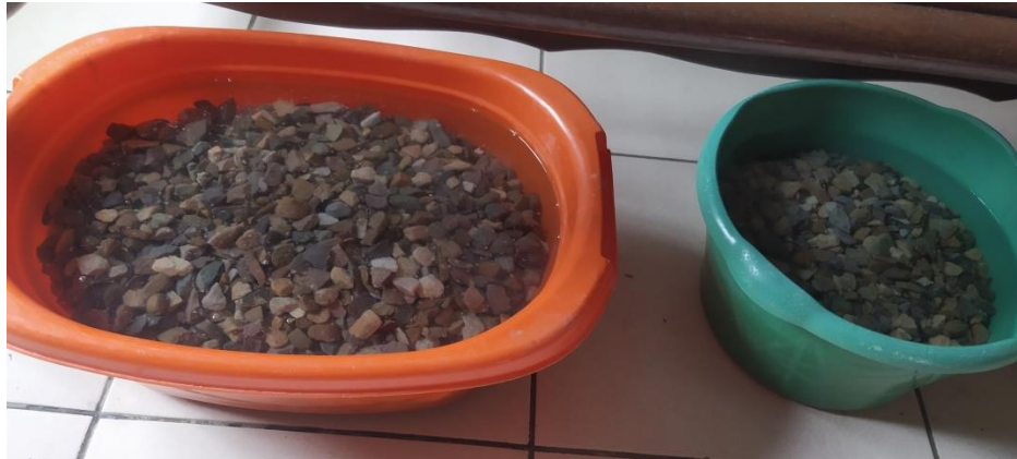
Muestras de agregado grueso de Bella Vista sumergidas en agua para ser saturadas.
