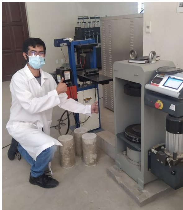
Probetas de hormigón antes de ser utilizadas para rotura – Santa Ana.
