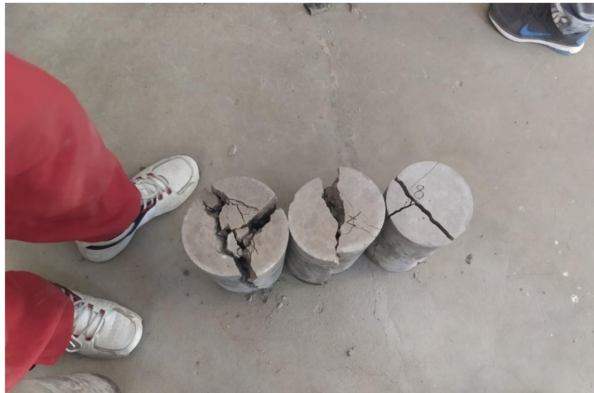
Probetas de hormigón rotas luego del ensayo a compresión.
