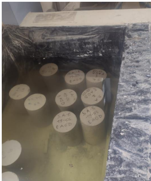
Curado de probetas de hormigón con agregados de Santa Ana.
