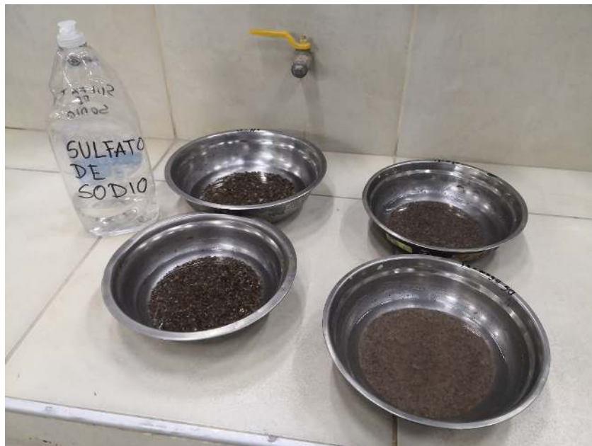
Figura 5 Agregado fino sumergido en Sulfato de Sodio (Fuente: Elaboración Propia)
