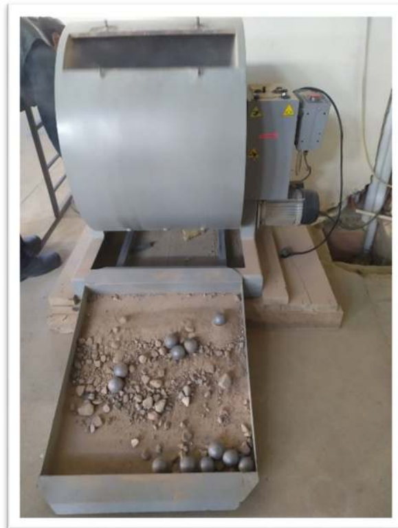
Figura 4 Máquina de Abrasión de los Ángeles (Fuente: Elaboración Propia)
