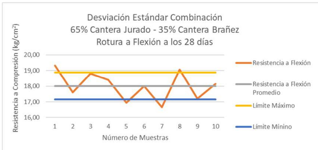
Figura 38 Gráfico de Desviación Estándar de la Resistencia a Flexión – Combinación: 65% Cantera Jurado - 35% Cantera Brañez (Fuente: Elaboración Propia)
