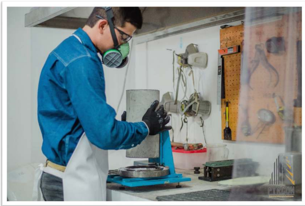
Figura 9 Refrentado de Cilindros Concreto (Fuente: Laboratorio de Control de calidad en la construcción | PYRCON. (s. f.). http://www.pyrcon.com.mx/ )
