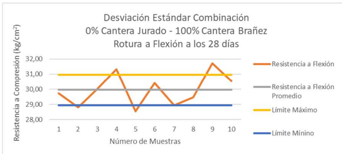
Figura 40 Gráfico de Desviación Estándar de la Resistencia a Flexión – Combinación: 0% Cantera Jurado - 100% Cantera Brañez (Fuente: Elaboración Propia)
