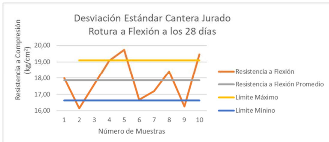
Figura 35 Gráfico de Desviación Estándar de la Resistencia a Flexión – Cantera Jurado (Fuente: Elaboración Propia)
