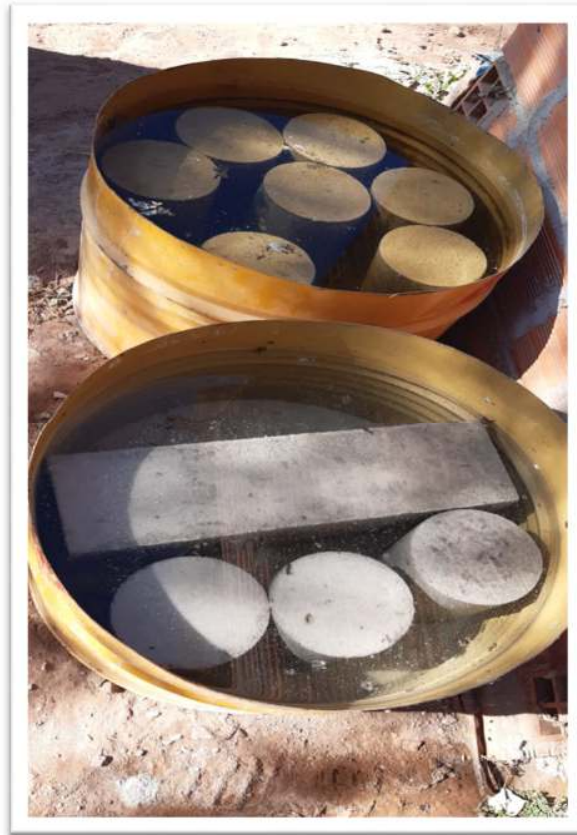
Figura 24 Curado de Cilindros y Vigas de Concreto (Fuente: Elaboración Propia)
