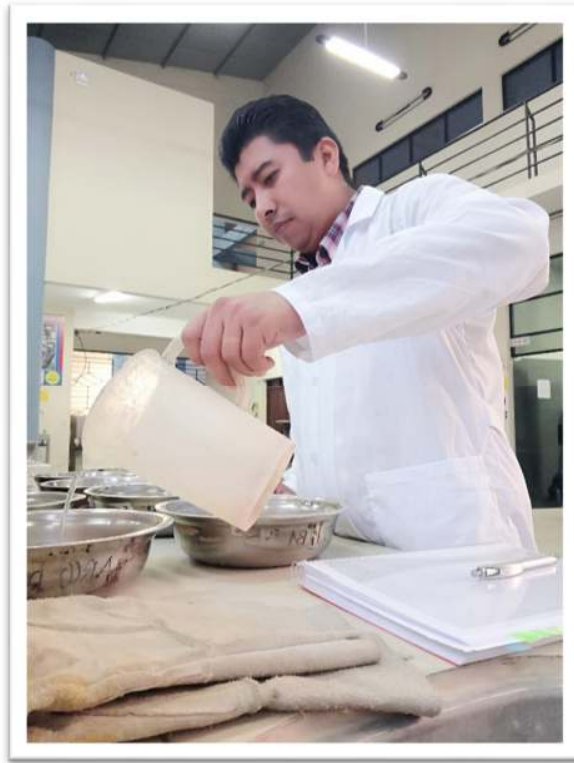
Anexo 9 Desintegración de los áridos mediante el método el sulfato de sodio
