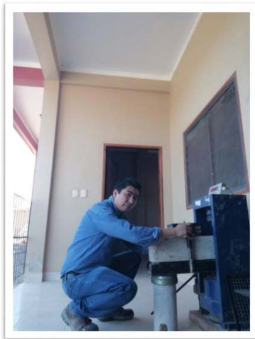
Anexo 26 Flexo-Tracción de Vigas (Fuente: Elaboración Propia)
