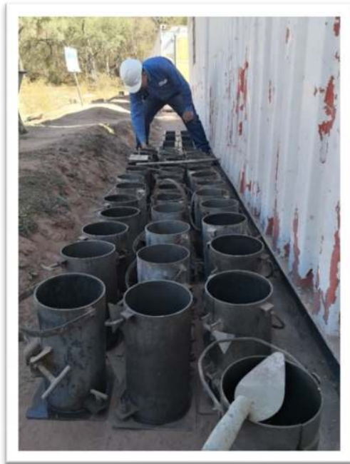
Anexo 16 Moldeo de Cilindros (Fuente: Elaboración Propia)
