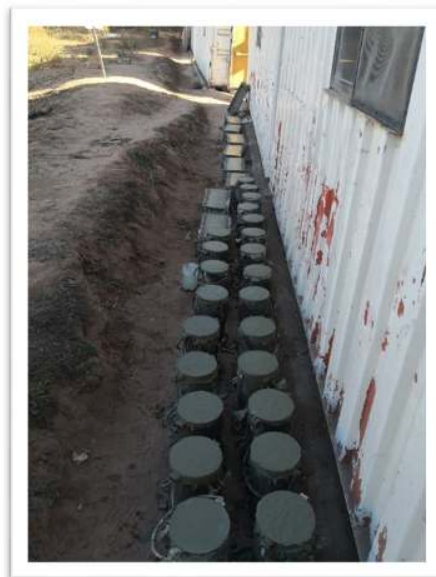
Anexo 18 Moldeo de Cilindros (Fuente: Elaboración Propia)
