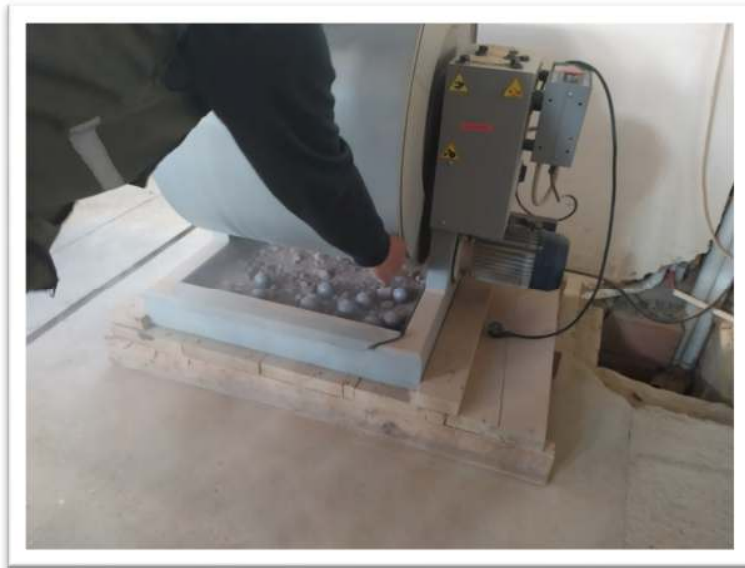
Anexo 5 Ensayo de Desgaste mediante la Maquina de los Ángeles
