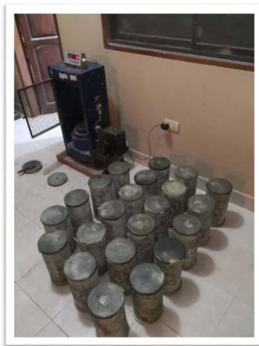
Anexo 22 Refrentado de Probetas (Fuente: Elaboración Propia)
