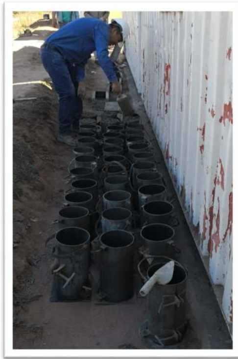
Anexo 17 Moldeo de Cilindros (Fuente: Elaboración Propia)
