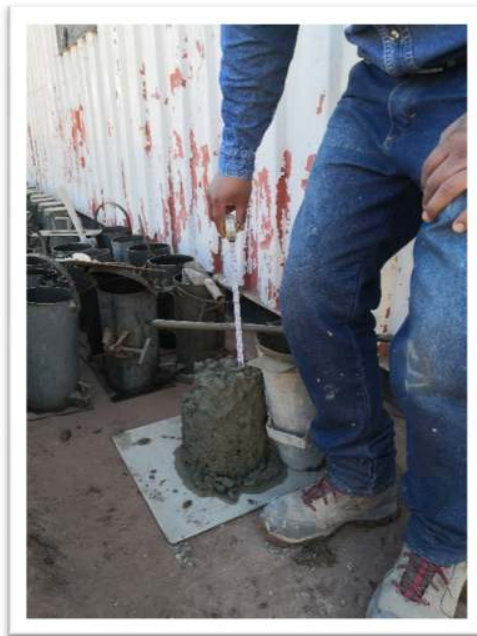
Anexo 14 Control de Asentamiento del Hormigón Mediante el Cono de Abrams (Fuente: Elaboración Propia)
