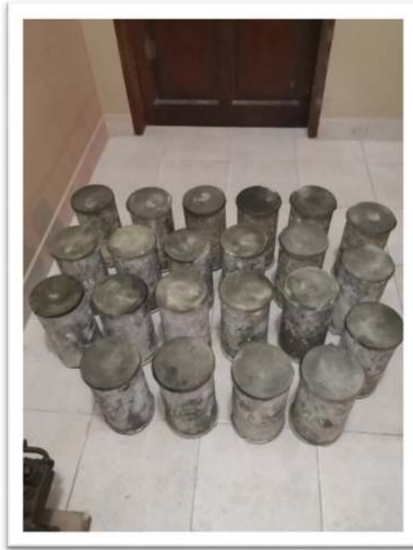
Anexo 21 Refrentado de Probetas (Fuente: Elaboración Propia)
