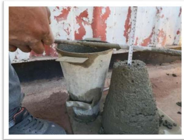
Anexo 11 Control de Asentamiento Del Hormigón Mediante El Cono de Abrams (Fuente: Elaboración Propia)
