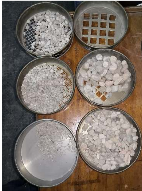
Anexo 3 Granulometría Agregado Grueso (Fuente: Elaboración Propia)
