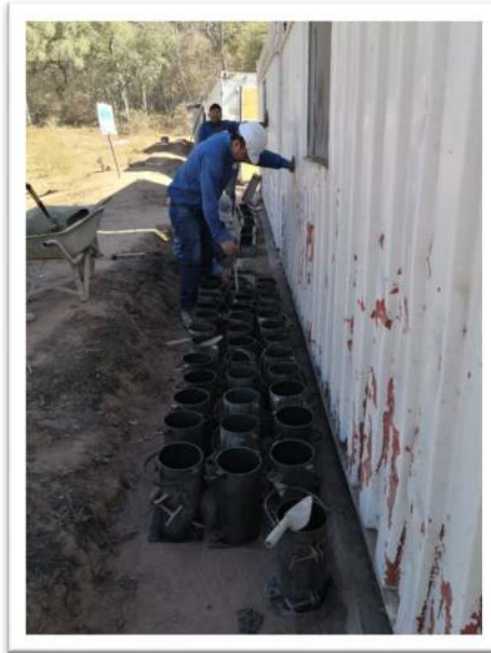
Anexo 15 Moldeo de Cilindros (Fuente: Elaboración Propia)
