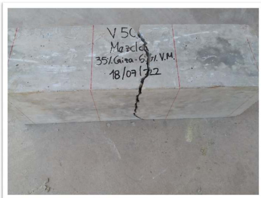
Anexo 28 Flexo-Tracción de Vigas (Fuente: Elaboración Propia)
