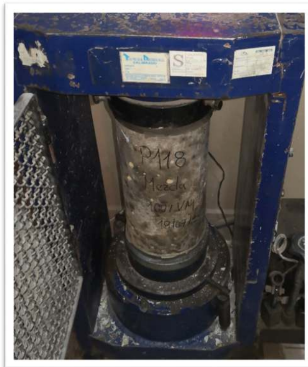
Anexo 24 Compresión de Cilindros (Fuente: Elaboración Propia)
