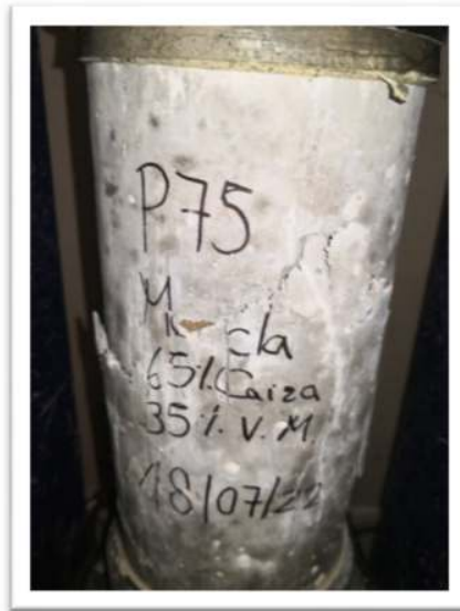
Anexo 23 Compresión de Cilindros (Fuente: Elaboración Propia)
