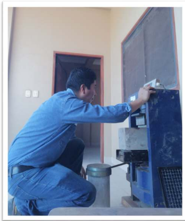
Anexo 27 Flexo-Tracción de Vigas (Fuente: Elaboración Propia)
