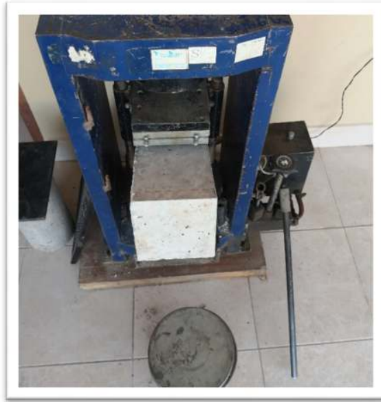
Anexo 25 Flexo-Tracción de Vigas (Fuente: Elaboración Propia)
