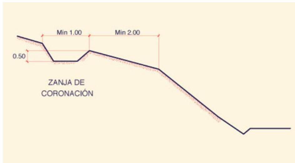
Figura N° 11. Detalle típico de una zanja de coronación
