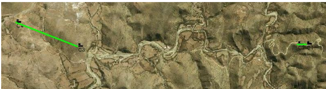
Imagen N° 7. Líneas bases de cierre de la poligonal abierta
