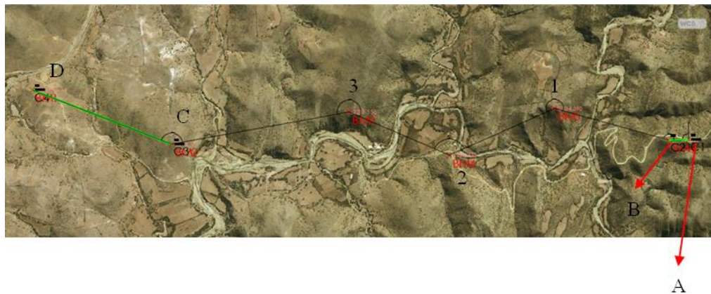
Imagen N° 8. Poligonal para hacer el ajuste en base a las líneas de cierre
