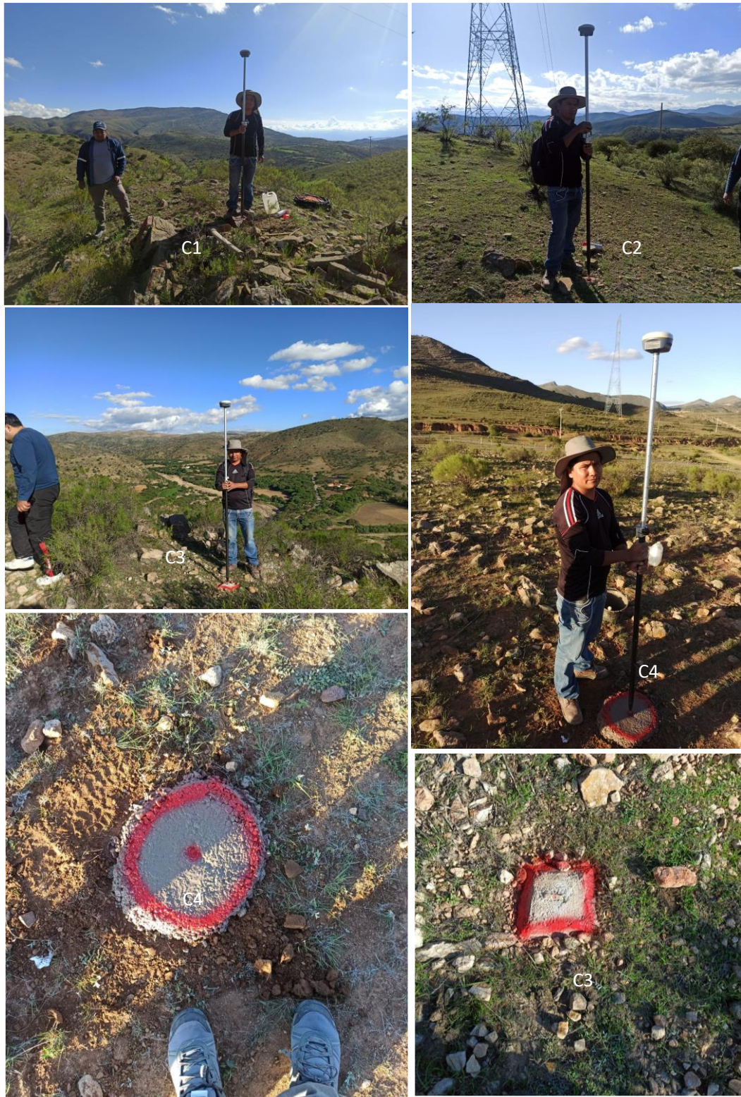
Imagen N° 6. Imágenes de obtención de puntos de control en campo
