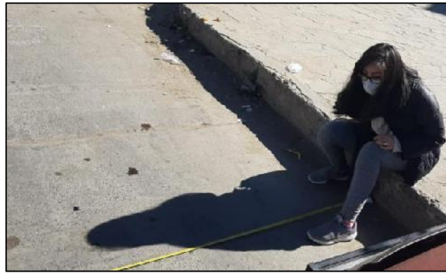
Figura 3.5 Medición ancho de accesos rotonda 1
