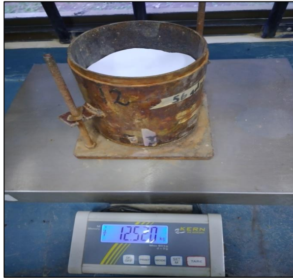
Figura 3.25: Peso del Molde cilíndrico CBR más suelo húmedo
