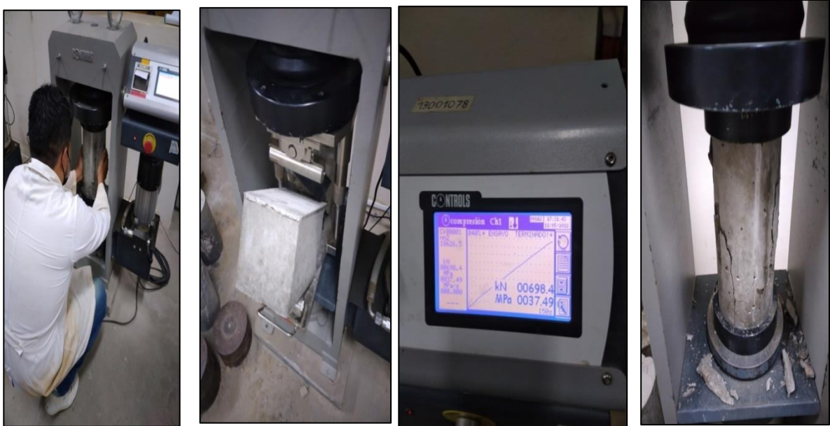
Figura 3.38: Ensayo de compresión en probetas cilíndricas ( D = 15 \text{ cm} ; L = 30 \text{ cm} ) y flexión en vigas ( 15 \text{ cm} \times 15 \text{ cm} \times 50 \text{ cm} )
