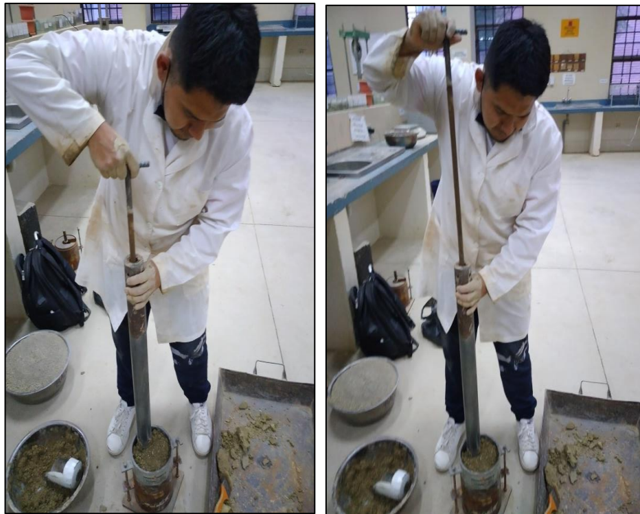
Figura 3.24: Compactación del molde CBR a 12, 25 y 56 golpes
