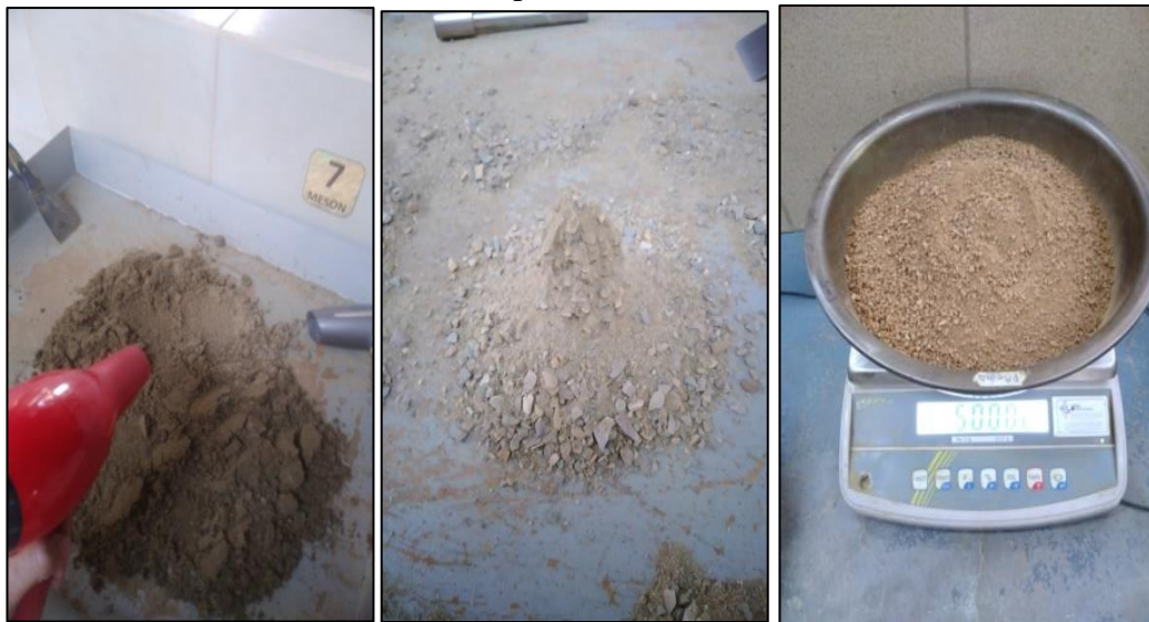
Figura 3.29: Determinación del peso específico del agregado fino, secado superficialmente
