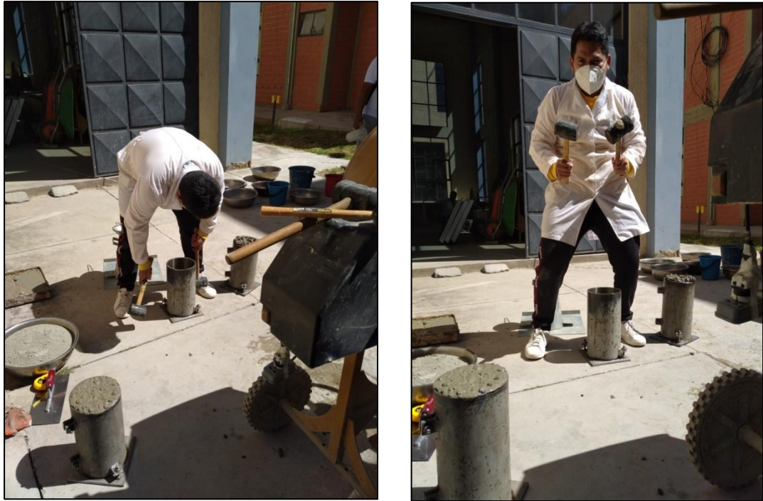
Figura 3.35: Eliminación de aire atrapado en probetas
