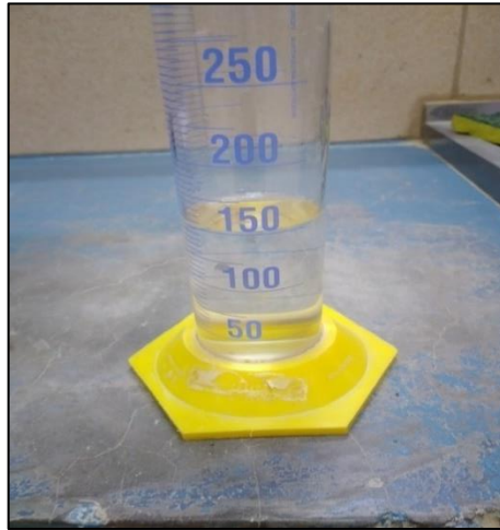
Figura 3.18: Probeta para el cálculo del volumen de agua en el ensayo de compactación de suelos
