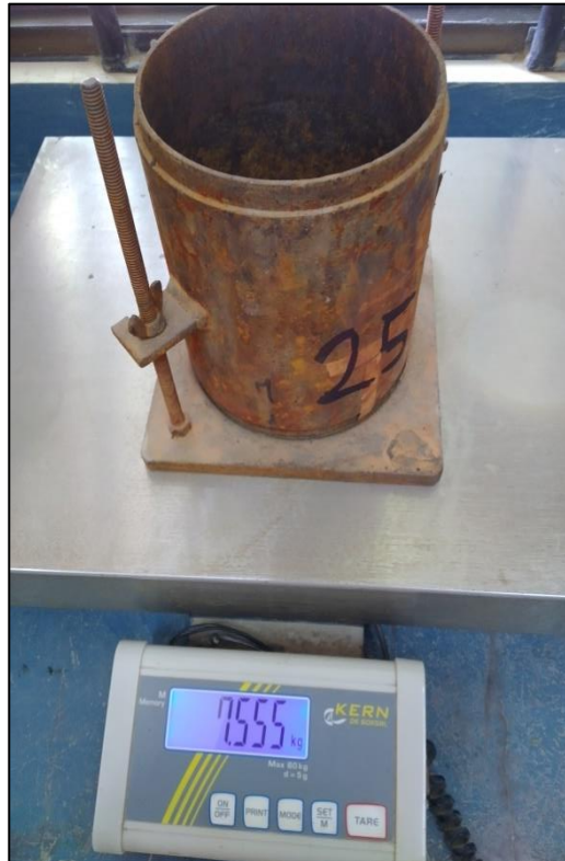
Figura 3.21: Peso e identificación del Molde cilíndrico CBR de 25 golpes
