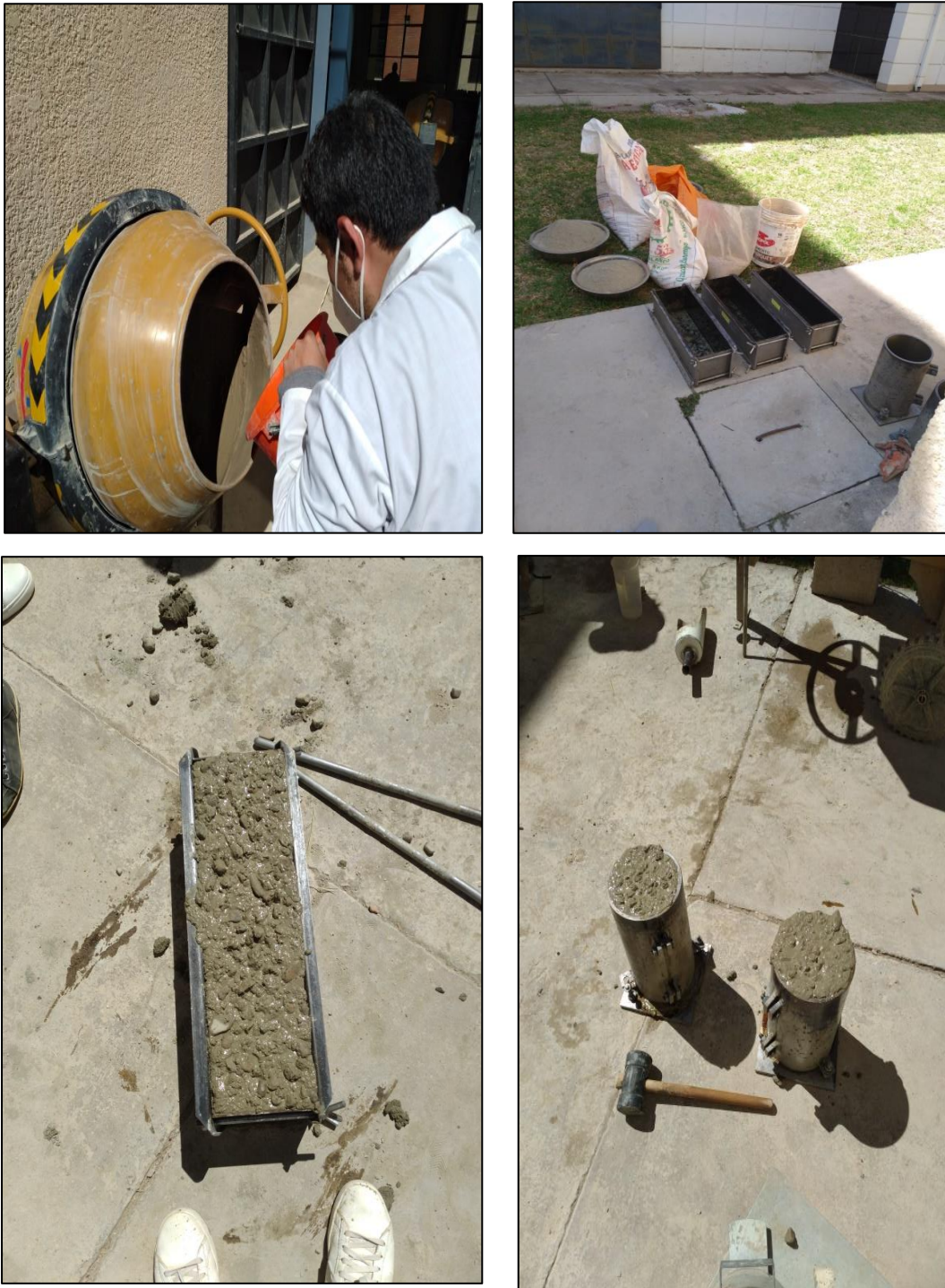
Figura 3.34: Dosificación de probetas y vigas
