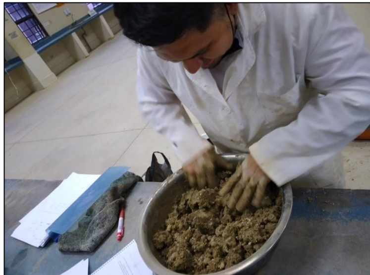
Figura 3.22: Mezclado del volumen del agua y el suelo para ensayo de CBR
