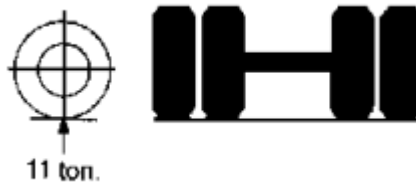
Figura 2.5: Ejes simples de 4 Neumáticos de 11000 kg
