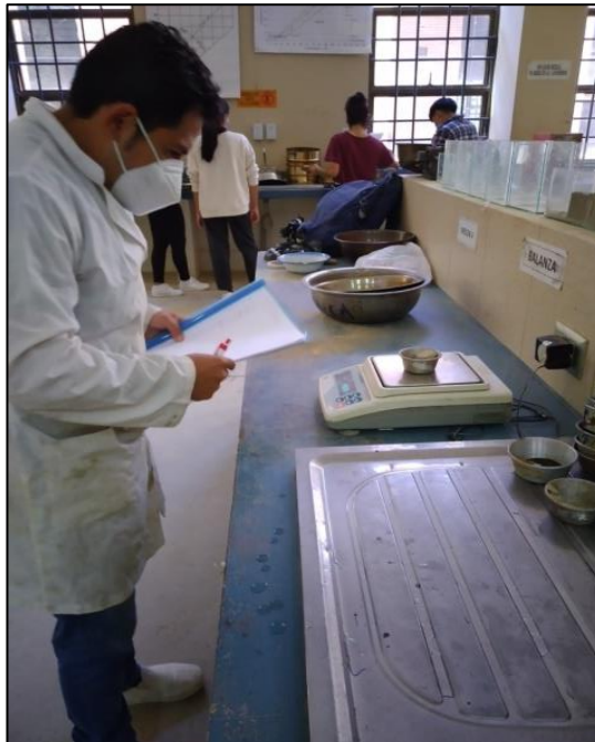
Figura 3.15: Dato de peso de suelo seco más tara en balanza, después de estar en el horno 24 horas, ensayo límite líquido
