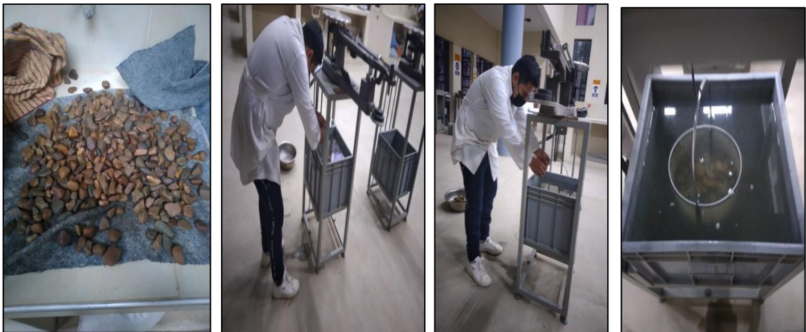
Figura 3.31: Ensayo peso específico del agregado grueso, secado superficialmente y peso sumergido
