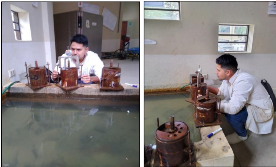
Figura 3.26: Lectura con el extensómetro sobre moldes cilíndricos ensayo CBR
