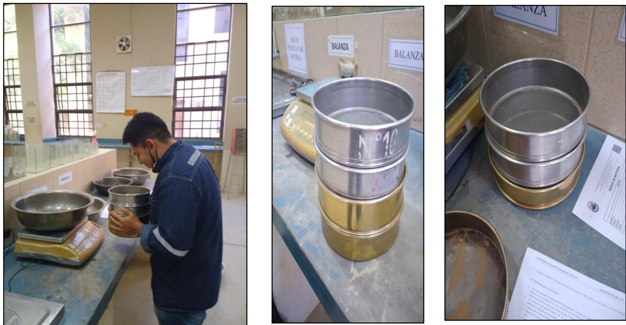
Figura 3.11: Tamizado del material fino por tamiz N°10,40 y 200
