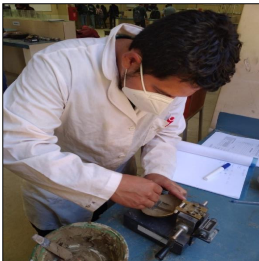
Figura 3.13: Hendidura y Número de golpes con el equipo de Casagrande
