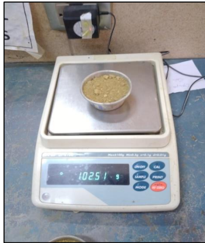
Figura 3.8: Ensayo contenido de humedad, peso suelo húmedo más tara (2.1), muestra de suelo Barrio El Trigo Av. La Paz
