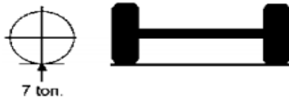
Figura 2.4: Ejes simples de 2 Neumáticos de 7000 kg
