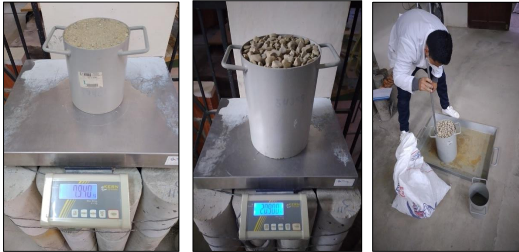
Figura 3.32: Ensayo peso unitario y compactado del agregado grueso y fino
