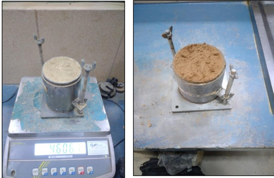
Figura 3.20: Peso suelo húmedo más molde cilíndrico base T-99
