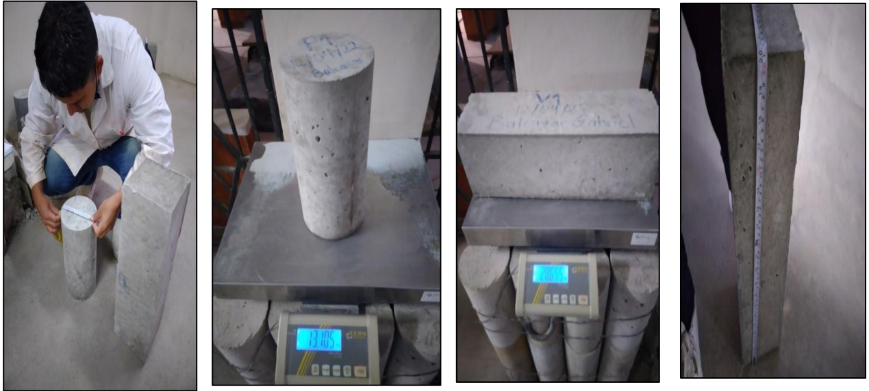
Figura 3.37: Probeta cilíndrica y viga rectangular con dimensiones según ASTM 192 AASHTO T 126)
