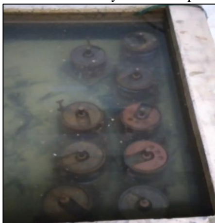
Figura 3.27: Moldes cilíndricos ensayo CBR en piscina para su saturación
