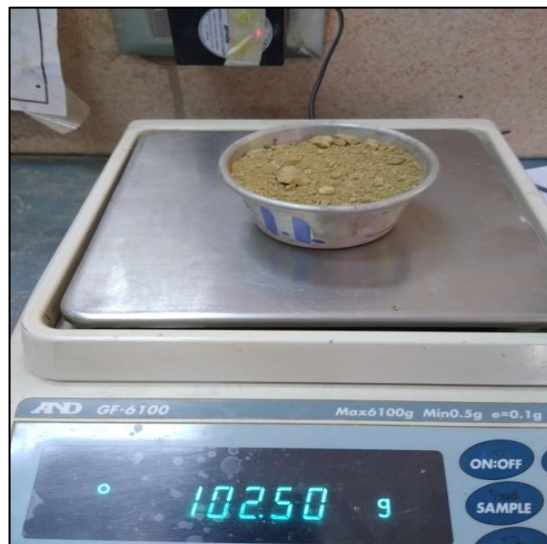
Figura 3.7: Ensayo contenido de humedad, peso suelo húmedo más tara (1.1), muestra de suelo Barrio Tarijeños en Progreso Av. Gran Chaco
