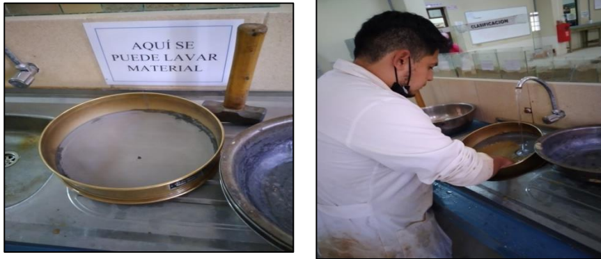
Figura 3.10: Lavado del material fino por el tamiz N°200
