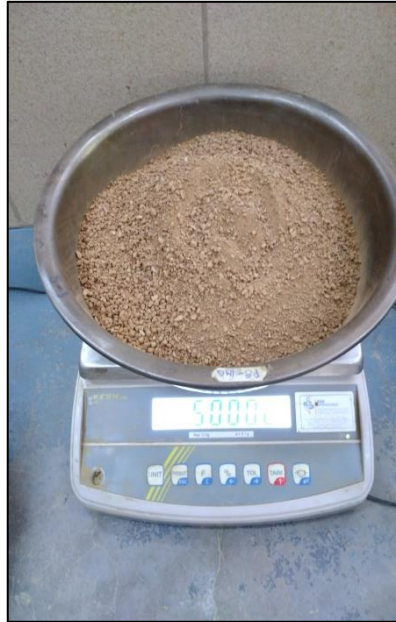
Figura 3.23: Peso del suelo en balanza 5 kg para ensayo de CBR
