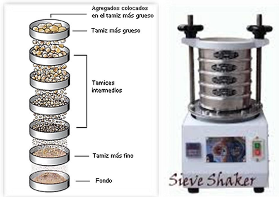
Figura 3.8. Juego de tamices y vibrador para el análisis por cribado
