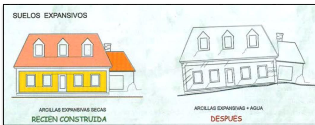
Figura 2.7. Problemas de los suelos expansivos
