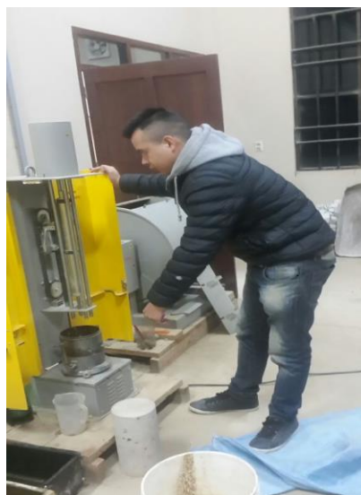
Figura 3.16. Montaje de muestra en el compactador automático
