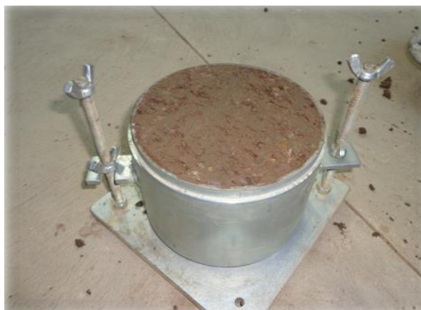
Figura 3.13. Ensayo de compactado manual
