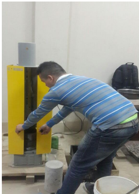
Figura 3.15. Manejo del compactador automático
