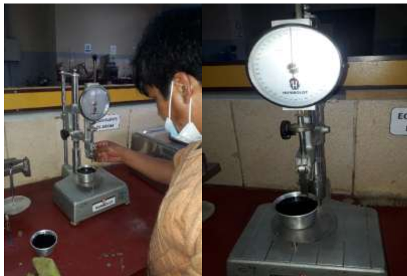
Figura N°3.19 Equipo y medición del punto de penetración
