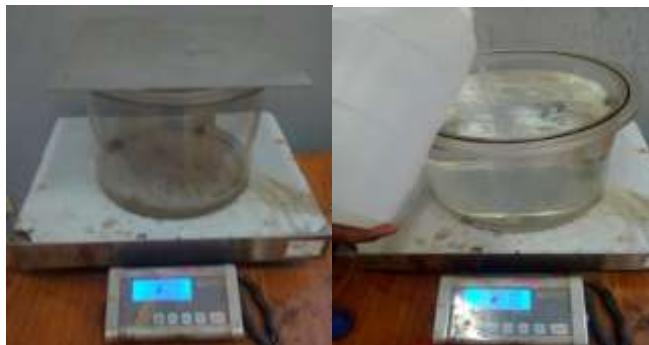
Figura N°3.46 Peso del picnómetro a capacidad vacío y lleno
