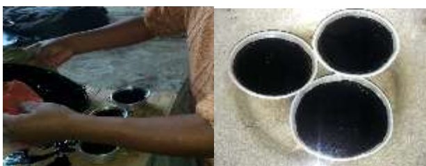
Figura N°3.18 Colocado del cemento asfáltico en el recipiente
