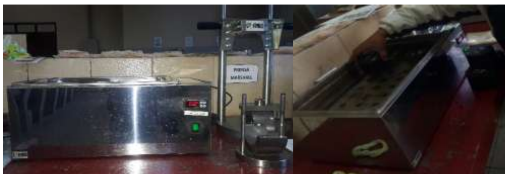
Figura N°3.42 Briqueta sumergida a 60^{\circ}\text{C}
