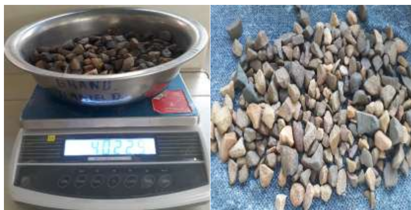
Figura N°3.4 Pesaje del material retenido en el tamiz N° 4
