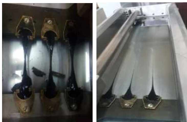
Figura N°3.30 Observación del punto de ductilidad
