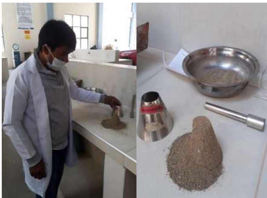
Figuras N°3.8 Verificación de la condición de la muestra saturada superficialmente seca
