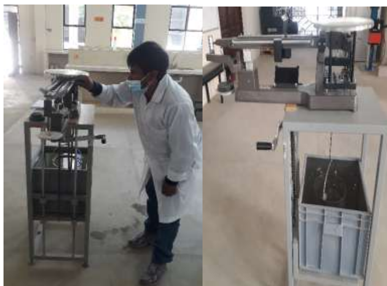
Figura N°3.6 Peso de la muestra dentro del agua y uso del cesto
