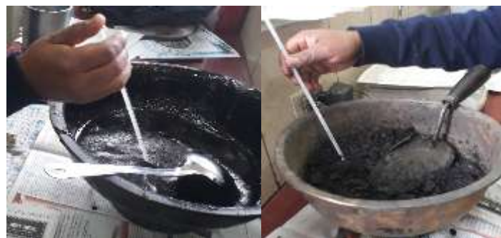
Figura N°3.35 homogenización de la mezcla y control de la temperatura
