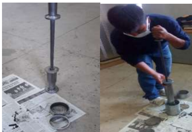
Figura N°3.37 Equipo y compactación de briquetas
