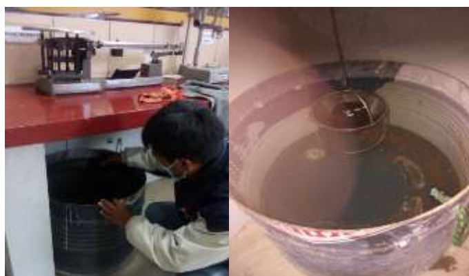
Figura N°3.40 Peso briqueta sumergido
