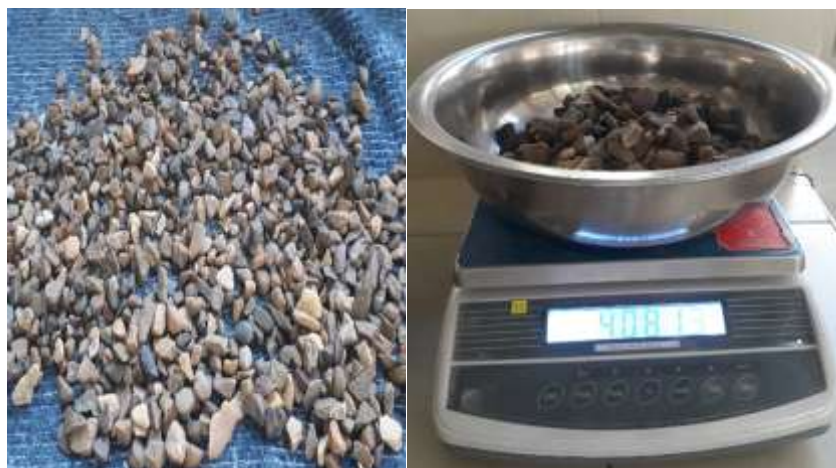
Figura N°3.13 Peso y muestra de las partículas fracturadas
