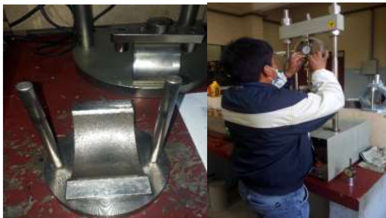
Figura N°3.43 Mordaza y calibración del dial de Marshall
