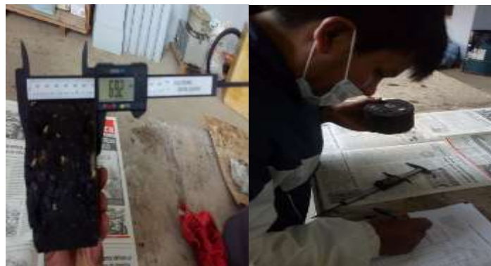
Figura N°3.41 Medición de las dimensiones de las briquetas
