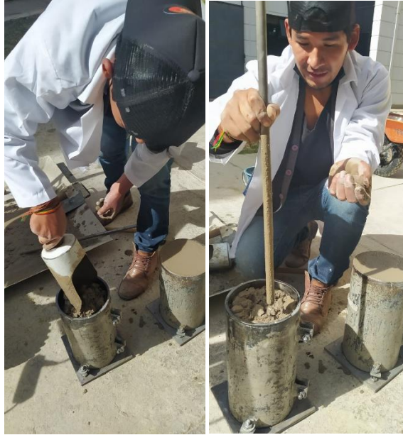
Figura 3.45. Vaciado del hormigón en los moldes
