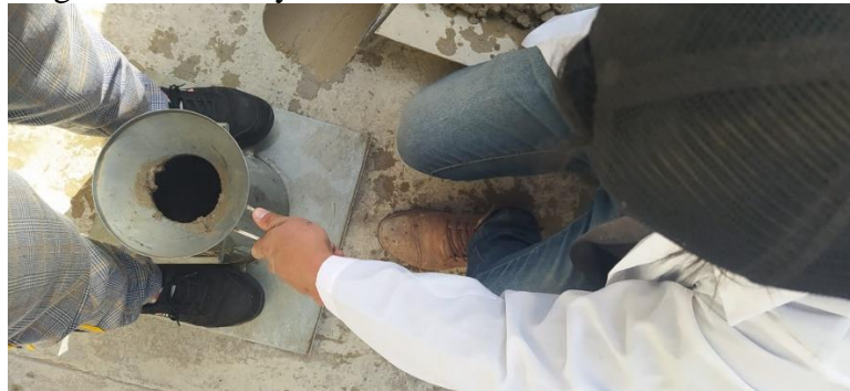
Figura 3.44. Ensayo del asentamiento de cono de Abrams
