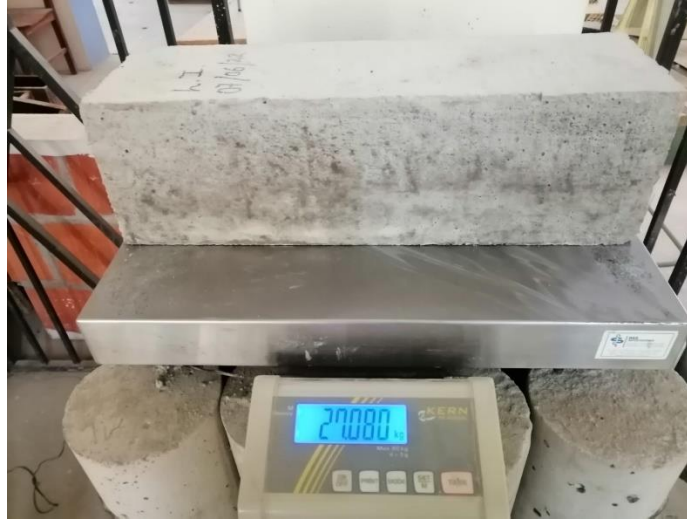
Figura 3.47. Pesado de los moldes
