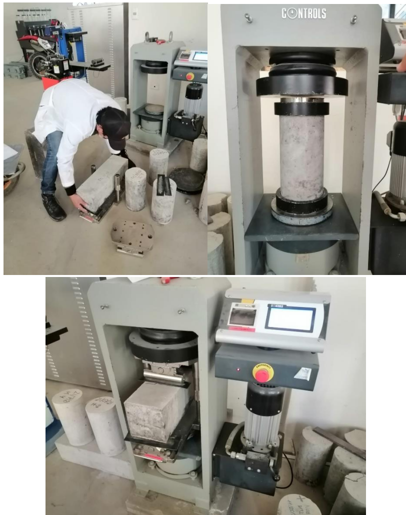
Figura 3.48. Rotura de probetas cilíndricas y vigas
