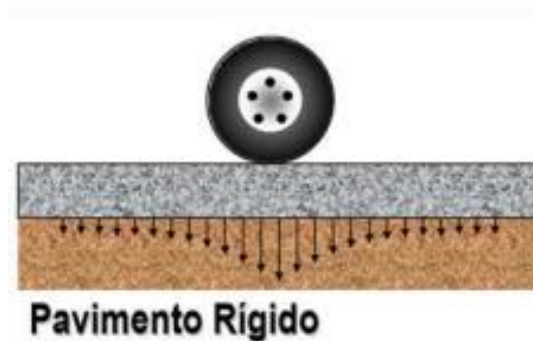
Figura 2.1. Transmisión de carga a la carpeta estructural
