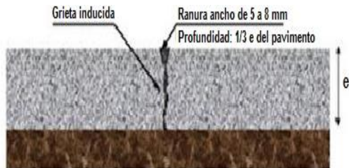
Figura 2.15. Detalle de junta transversal de contracción
