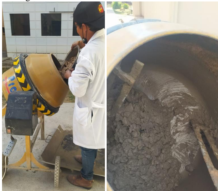
Figura 3.42. Vaciado de material a la mezcladora
