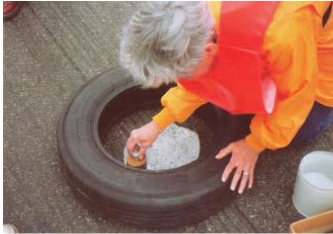
Figura.2.4. Círculo de arena. Equipo Participante A8 Experimento Internacional AIPCR (1995)
