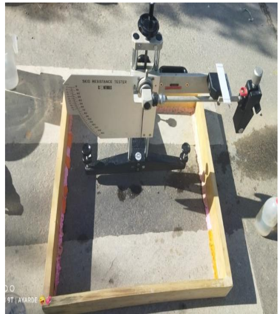
Figura. 3.12. Armado y nivelación del péndulo británico.
