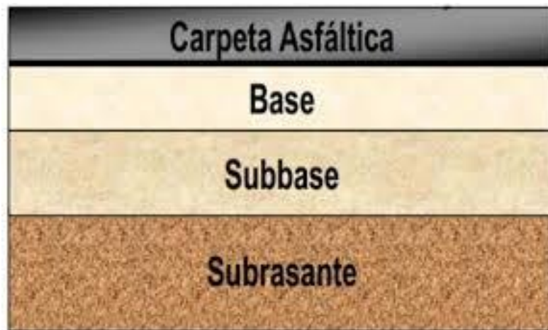
Figura. 2.1. Capas del pavimento flexible.
