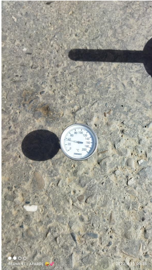
Medición de la temperatura del asfalto.
