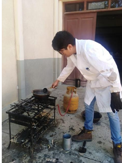
Imagen 6 Vertido de cemento asfáltico al material granular (160°C)
