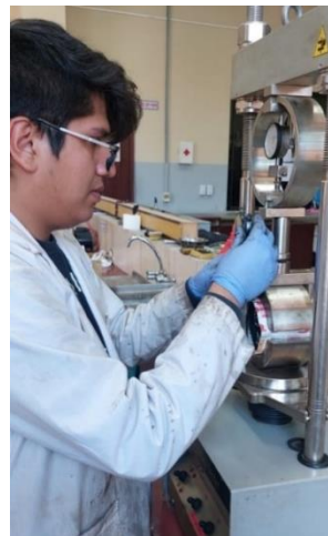
Imagen 13 Colocado de briquetas en la mordaza Marshall
