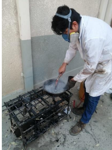
Imagen 14 Mezclado de materiales en la elaboración de briquetas
