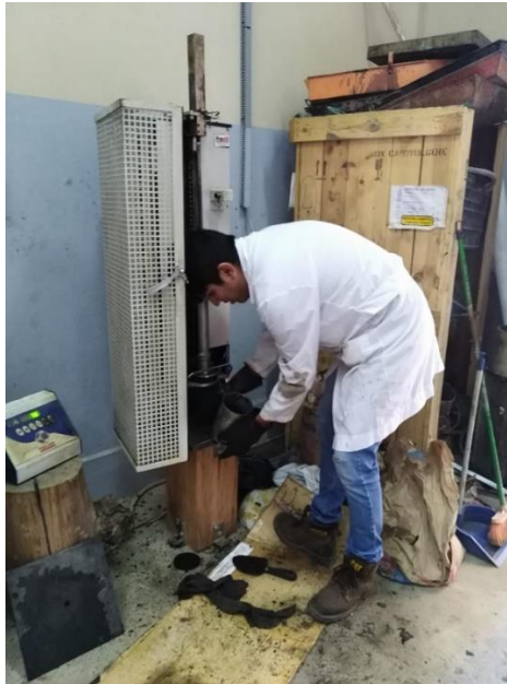
Imagen 10 Volteo de briquetas
