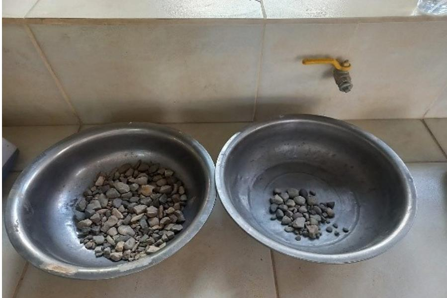
Leyenda: En la figura se muestra en una bandeja las partículas con caras fracturadas y en la otra bandeja las partículas sin caras fracturadas del agregado grueso.
