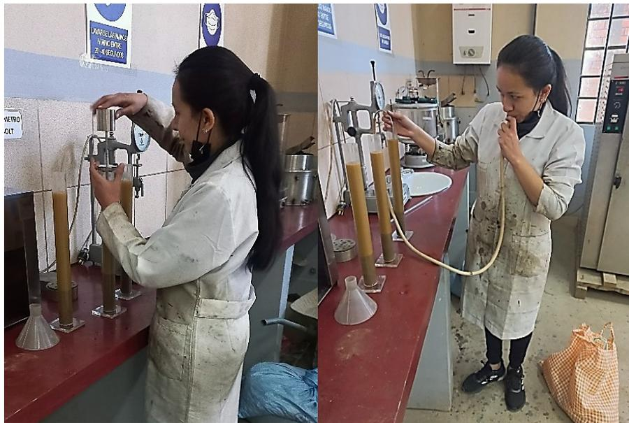
Leyenda: Realizando el ensayo equivalente de arena.
