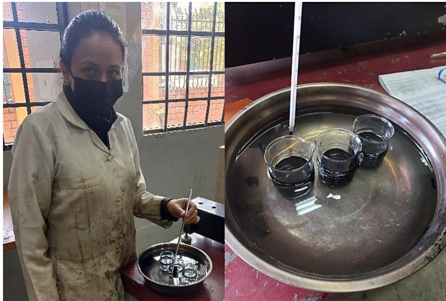
Leyenda: Tomando la temperatura del ensayo peso específico del cemento asfáltico.
