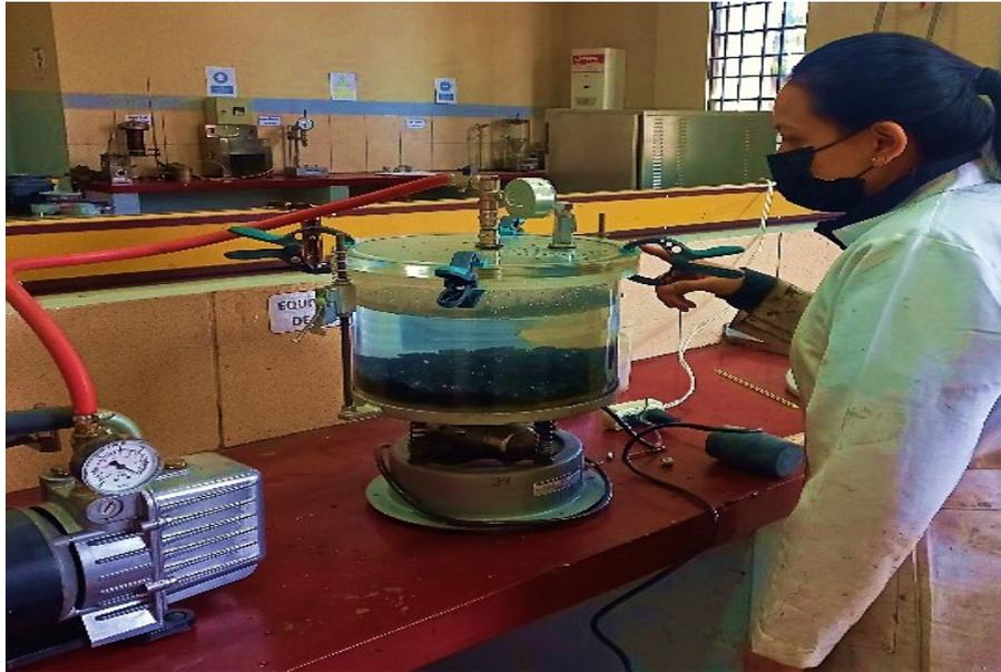
Leyenda: Realización del ensayo rice determinación de la gravedad específica máxima de la mezcla sin compactar.
