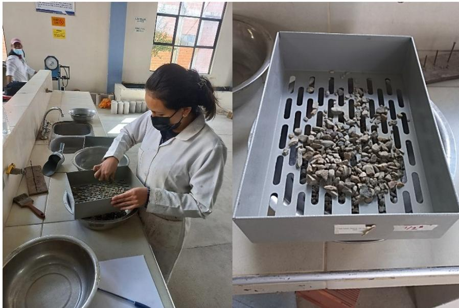
Leyenda: Tamizado del agregado grueso para la realización del ensayo.
