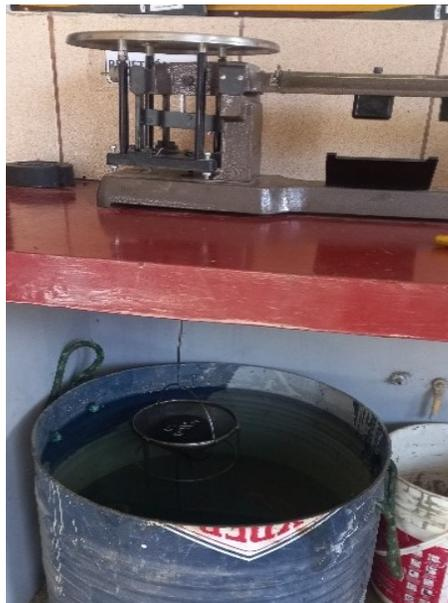
Leyenda: Obtención de datos del pesado de la briqueta totalmente sumergida en agua.
