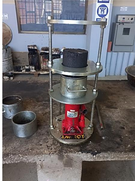
Leyenda: Extracción de la briqueta con la ayuda de un gato hidráulico.
