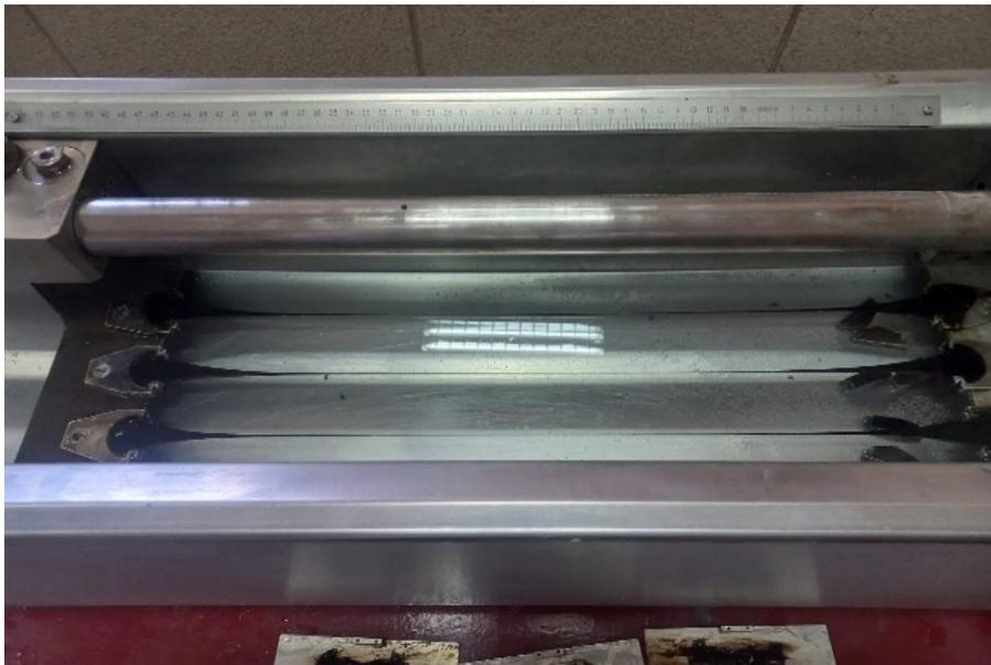
Leyenda: Medición del ensayo de ductilidad del cemento asfáltico.
