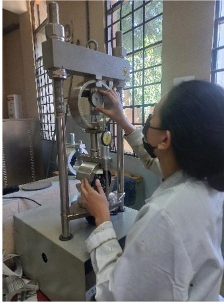
Leyenda: Realización de la rotura de la briqueta en el equipo Marshall.
