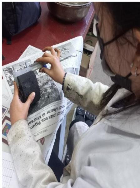
Leyenda: Se tomaron cuatro medidas de las alturas de las briquetas, para luego realizar un promedio y utilizarlo en el llenado de las planillas del ensayo Marshall.
