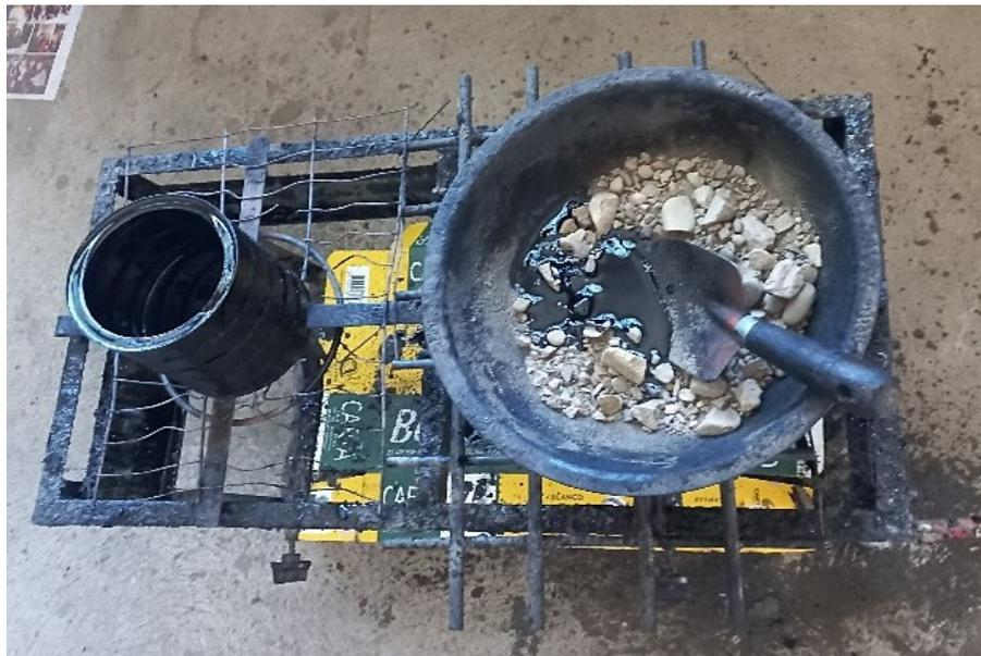
Leyenda: Proceso del mezclado del cemento asfáltico y los agregados.
