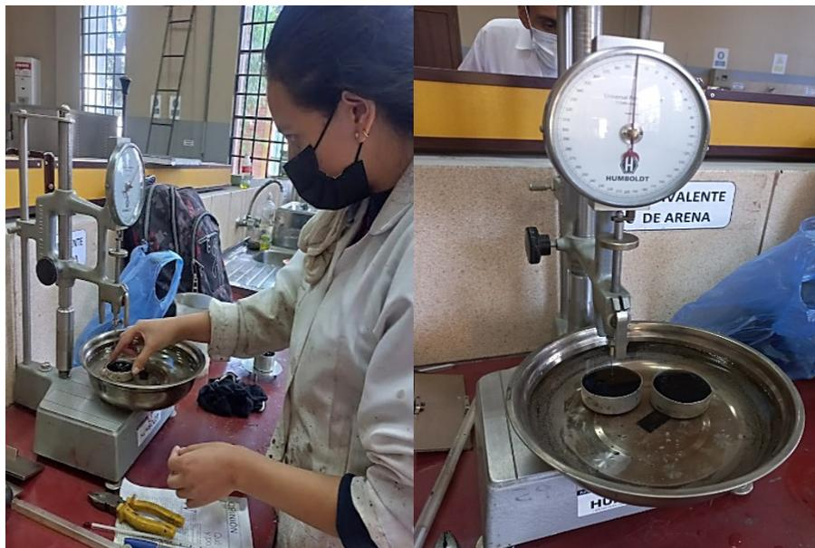
Leyenda: Medición de la penetración del cemento asfáltico
