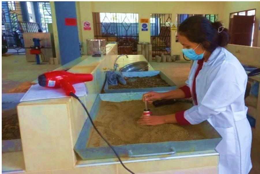
Leyenda: Verificando la humedad de la muestra para empezar el ensayo.
