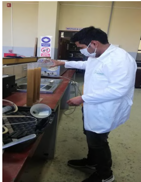
Figura A.2. Ensayo de equivalente de arena
