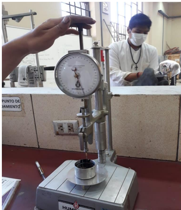
Figura B.10. Ensayo de penetración
