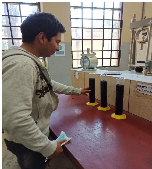
Figura B.2. Emulsión asfáltica después de 5 días
