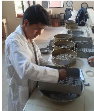
Figura 26. Seleccionando material aplanado con el calibrador de aplanamiento
