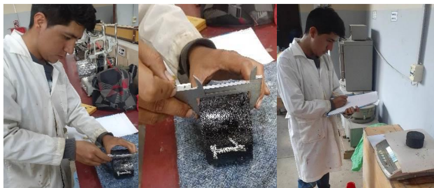
Figura 43. Determinación de altura y peso de las briquetas
