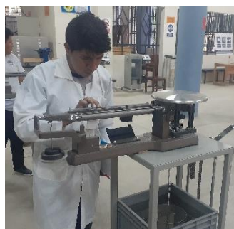
Figura 16. Determinación del peso de la muestra sumergido
