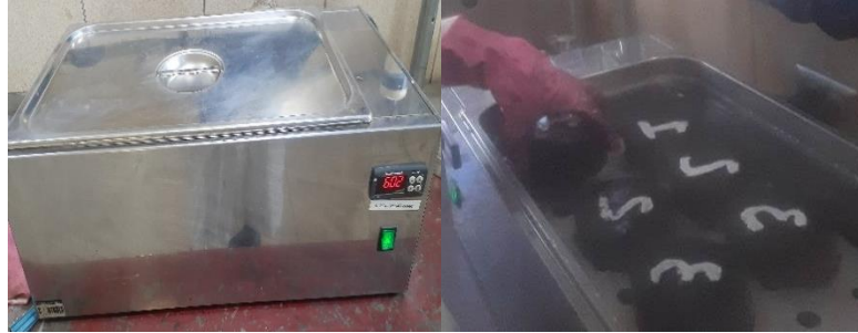
Figura 47. Colocar las briquetas en baño maría a 60°C por 30 min
