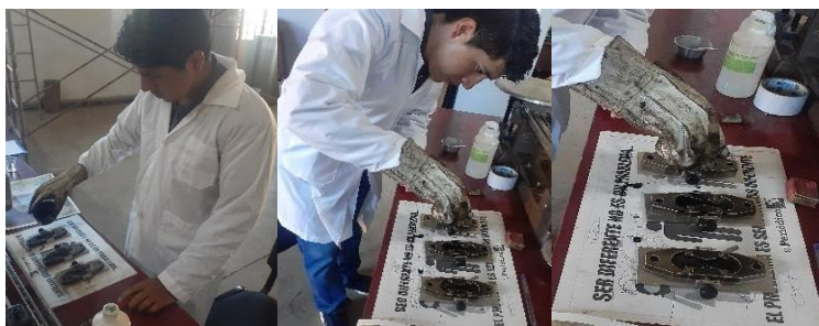
Figura 30. Vertir cemento asfáltico en moldes, enfriar y colocar en baño maría
