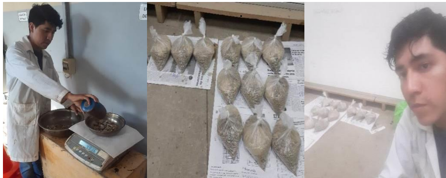
Figura 41. Pesar los agregados las cantidades requeridas
