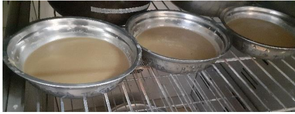
Figura 20. Sacar la muestra del matraz y dejar secar en horno, luego pesar
