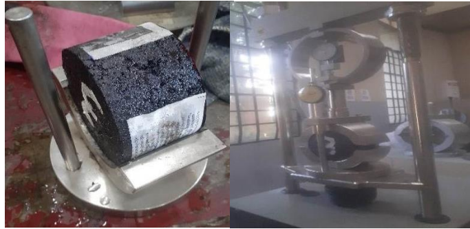
Figura 48. Colocar las briquetas en mordaza y dial de deformación para la fluencia
