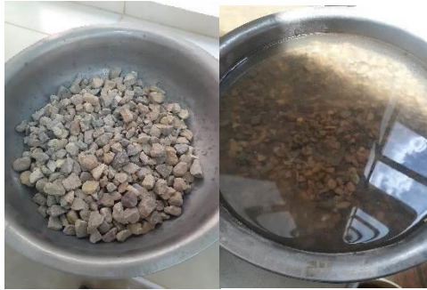
Figura 14. Lavar y dejar saturar con agua por 24 hr
