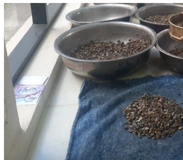
Figura 15. Secado superficialmente seco de la muestra
