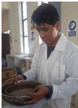
Figura 25. Tamizar el material por tamiz N°12 para luego secar en horno y pesar
