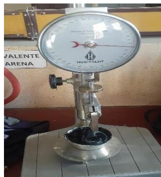
Figura 36. Penetración de las muestras con el penetrómetro
