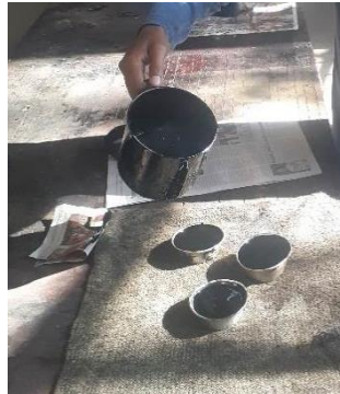
Figura 34. Colocar cemento asfáltico en las muestras
