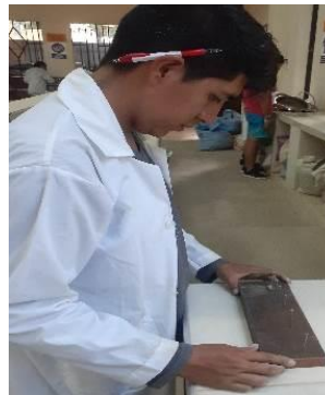
Figura 27. Seleccionando material alargado con el calibrador de alargamiento
