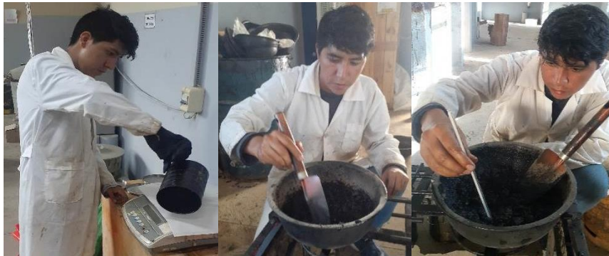
Figura 42. Mezclar los agregados y cemento asfáltico a temperatura requerida
