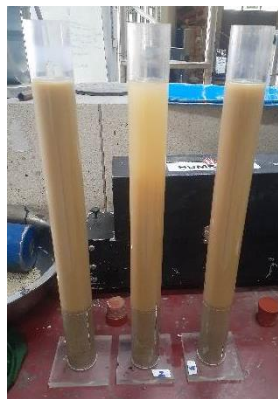
Figura 29. Obtener datos mediante lectura de altura de las probetas
