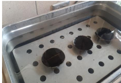
Figura 35. Colocar las muestras en baño maría a 25°C por 30min
