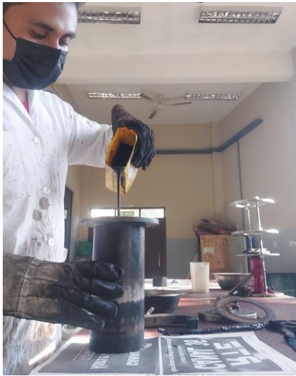
Colocado del asfalto diluido al cilindro de prueba del equipo de destilación
