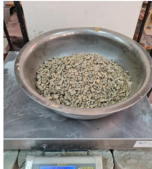
Pesado del agregado del retenido por cada tamiz
