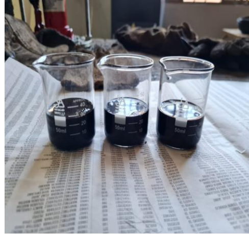
Colocación de cemento asfáltico en los Frascos volumétricos
