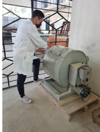
Introducción del agregado a la máquina de desgaste a los ángeles
