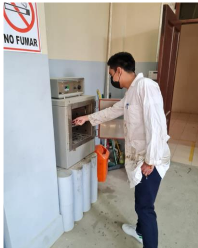
Introducción de los platillos al horno giratorio donde permanecerán durante 5 hrs a una temperatura de 163°C
