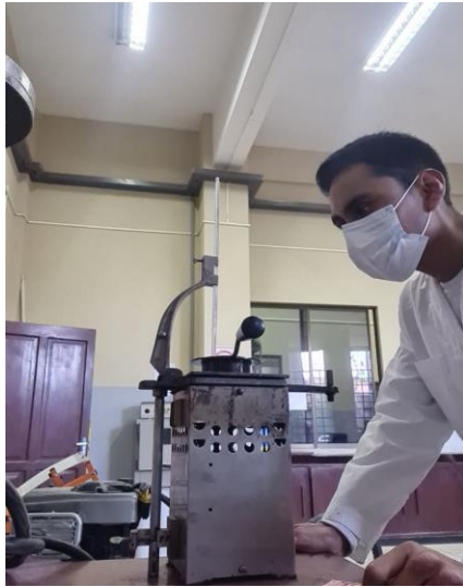
Controlando la temperatura a la que se encuentra nuestro cemento asfáltico
