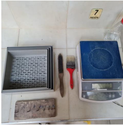
Materiales para realizar la prueba de partículas alargadas y laminaridad en el agregado pétreo
