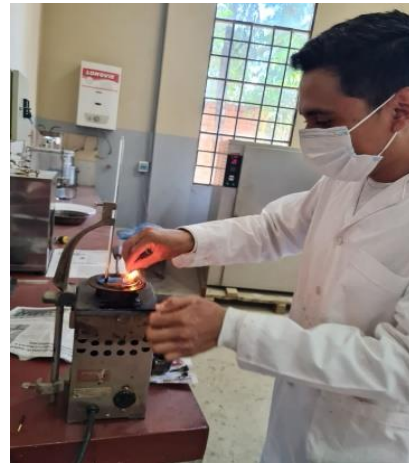
Aplicación de la llama de prueba para poder determinar el punto de inflamación del cemento asfáltico a través de la lectura del termómetro cuando se genere un destello azul
