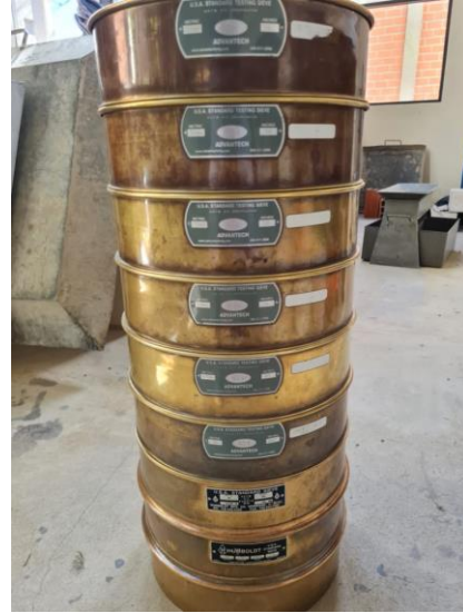
Juego de tamices para realizar la granulometría
