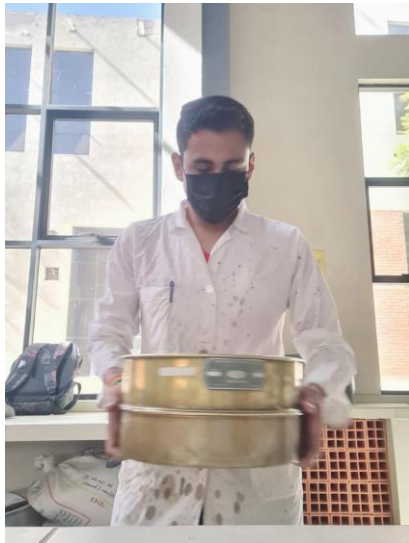
Tamizando el agregado pétreo
