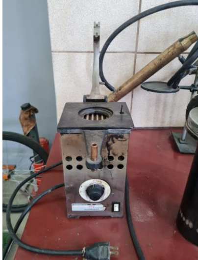
Hornalla para realizar la prueba de punto de inflamación
