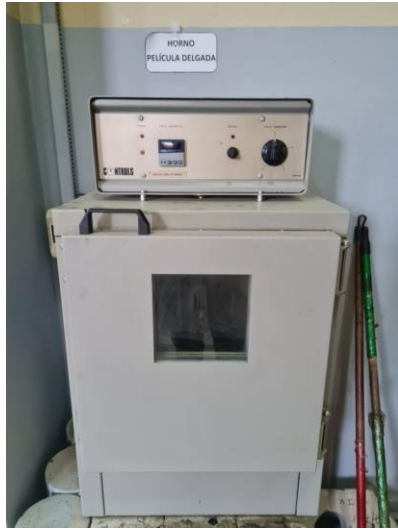
Horno giratorio para el ensayo de película delgada
