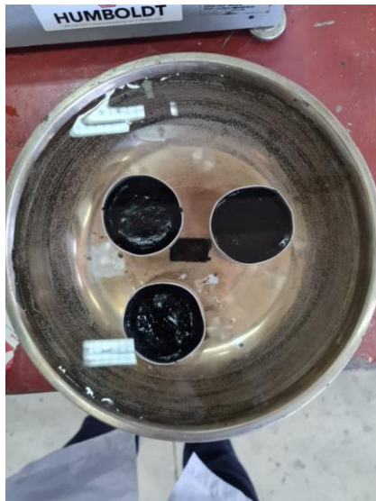
Acondicionando la muestra a una temperatura de 25 °C en baño maría
