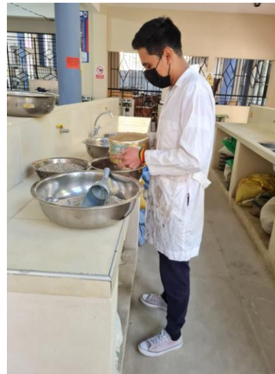
Tamizado de la muestra después del desgaste de los ángeles para proceder a lavar el mismo y secarlo en un horno durante 24 hrs
