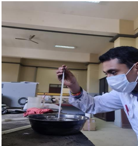
Acondicionamiento de los frascos con asfalto a una temperatura de 25°C
