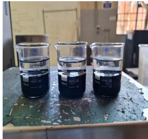
Peso de frasco + agua + cemento asfáltico
