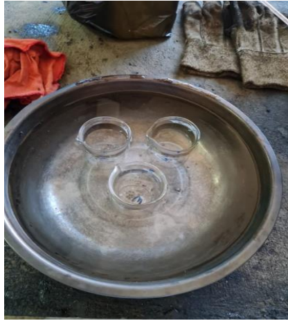
Calibración de los frascos con agua destilada y a una temperatura de 25°C
