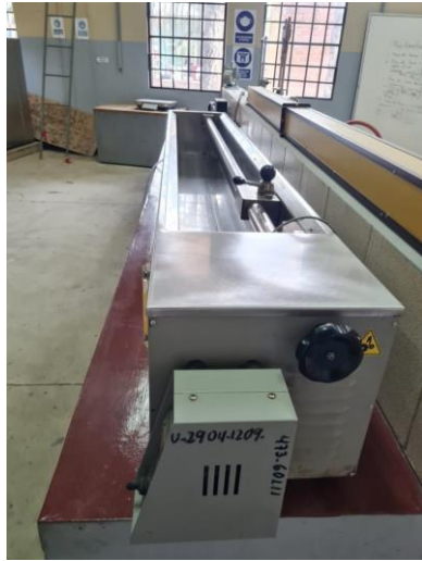
Equipo para realizar el ensayo de Ductilidad
