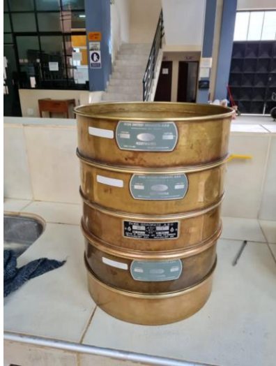
Juego de tamices para realizar la prueba de caras fracturadas del agregado pétreo
