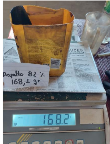
Preparación del asfalto diluido
