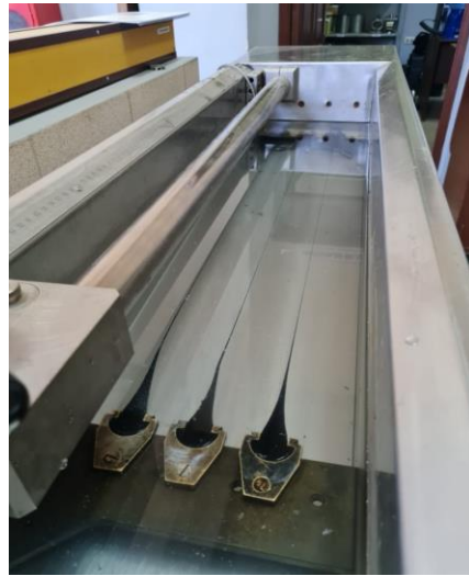
Estiramiento de las muestras de cemento asfáltico por el ductilímetro
