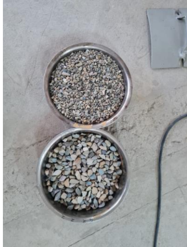
Muestra de agregado pétreo tipo “B” y “D” para la prueba desgaste de los ángeles
