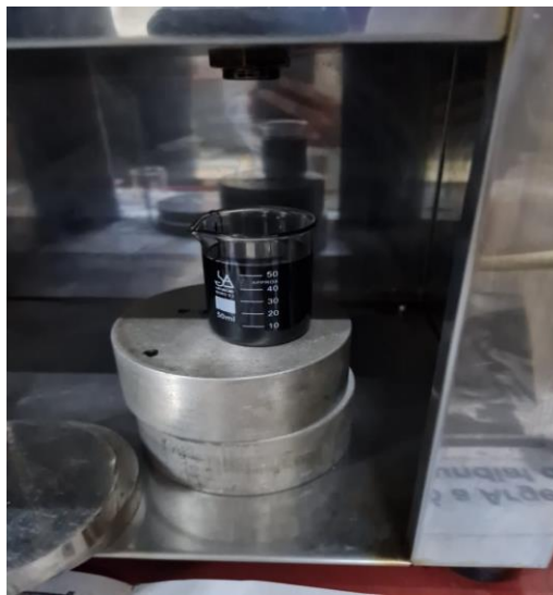
Cemento asfáltico fluyendo hacia un frasco calibrado de 60 ml
