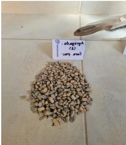
Agregado pétreo de dos caras fracturadas
