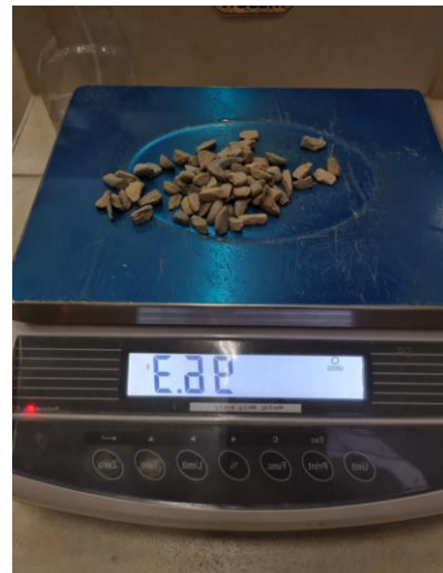
Peso de los agregados pétreos alargados
