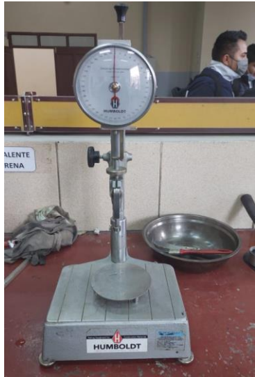
Equipo de penetración
