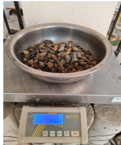
Peso de muestra secada al horno durante 24 hrs para obtener peso seco en la prueba de peso específico
