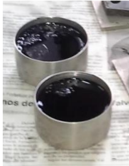
Colocado del cemento asfáltico en las cápsulas
