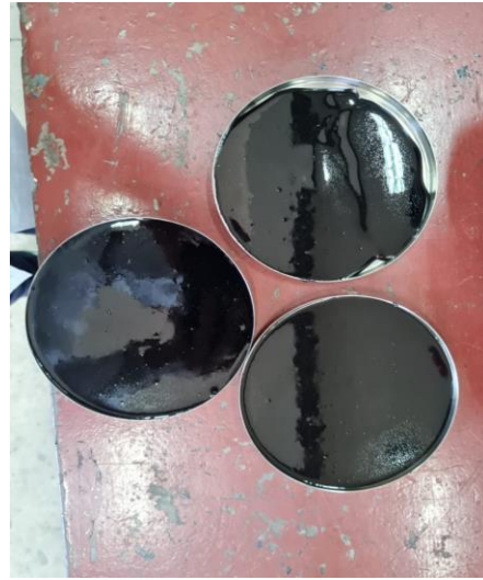
Ensayo de película delgada. Pesaje de asfalto antes de entrar al horno
