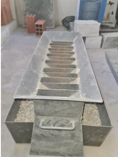
Cuarteo de los agregados pétreos para realizar ensayos de granulometría
