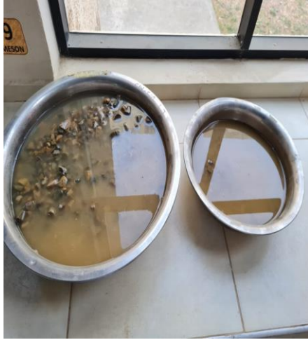
Saturación de muestra para el peso específico del agregado pétreo tipo “B” y “D”
