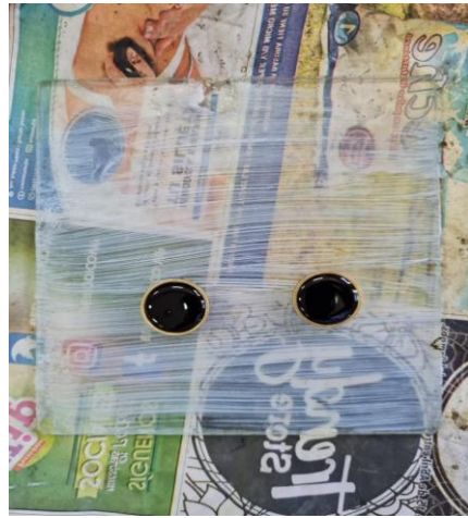
Colocado y enrazado de cemento asfaltico en los anillos
