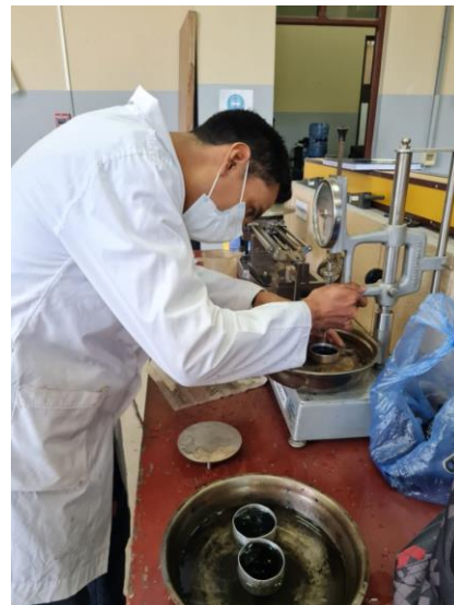
Lectura de la penetración de la aguja en la muestra
