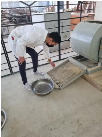
Muestra obtenida después del desgaste de los ángeles
