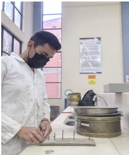
Clasificación de las partículas alargadas por una regla graduada
