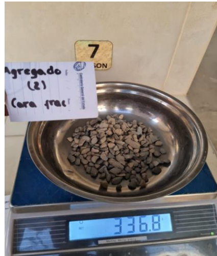
Peso de los agregados pétreos con dos caras fracturadas
