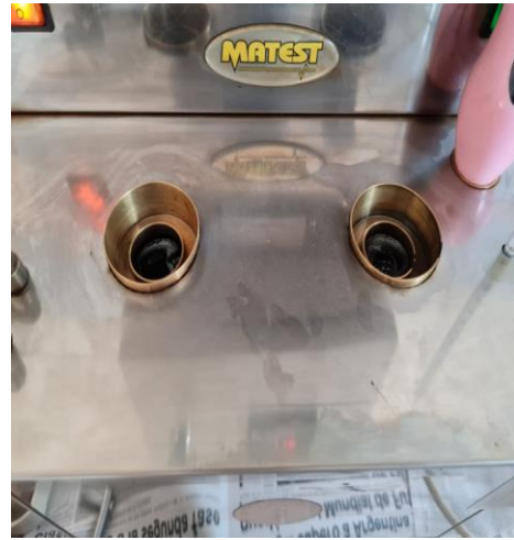
Ensayo de Viscosidad Saybolt Furol. Colocando el asfalto en la cámara de acondicionamiento del asfalto a 135°C
