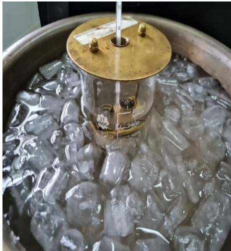
Enfriamiento de la muestra hasta unos 5°C por 30 minutos
