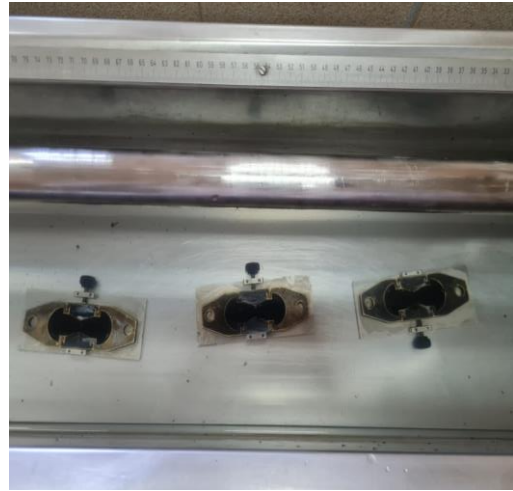
Ensayo de Ductilidad, acondicionamiento de las briquetas y asfalto a una temperatura de 25°C
