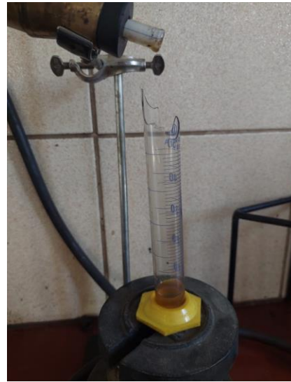
Destilado obtenido después de someter el asfalto diluido a una temperatura
