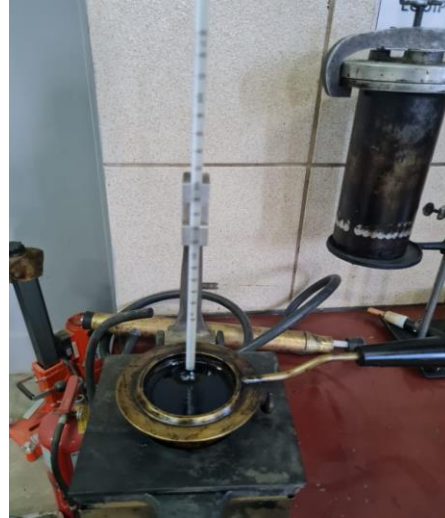
Colocación del cemento asfáltico en la copa abierta de Cleveland
