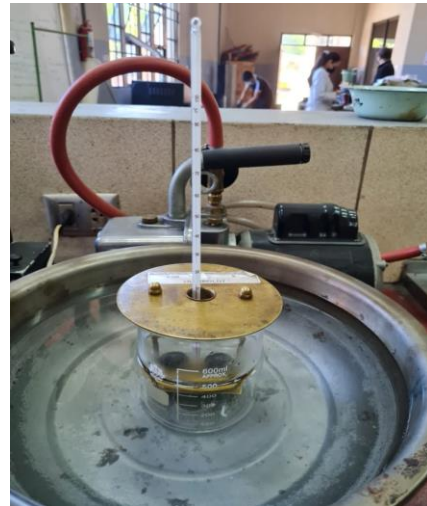
Incremento de temperatura a través de una hornilla eléctrica y determinación de la temperatura a la que las bolillas choquen con la placa
