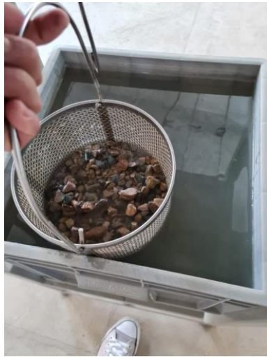
Peso de muestra sumergido
