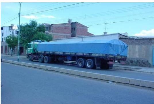
SR → Vehículo comercial articulado, compuesto normalmente de una unidad tractora y un semi remolque o remolque de 2 ejes o más.
