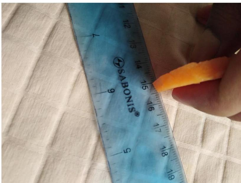
Se realizó prueba de cortado del zapallo en partes más pequeñas, de forma cónica aproximadamente de 5 mm. Sin embargo, el método resulta ser ineficaz debido a que el zapallo se quemaba rápidamente sin terminar de secar apropiadamente.
