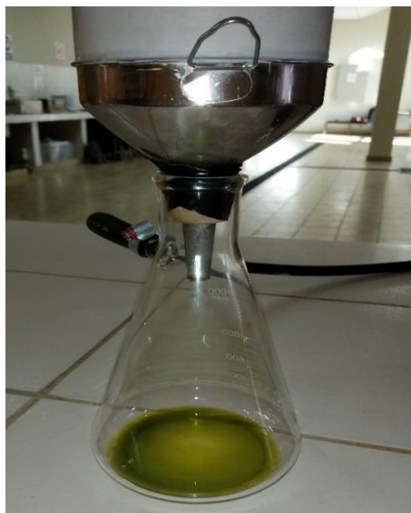
Fuente: Elaboración propia, 2022 Figura 2-17 Filtración al vacío el aceite extraído de la pulpa de palta
