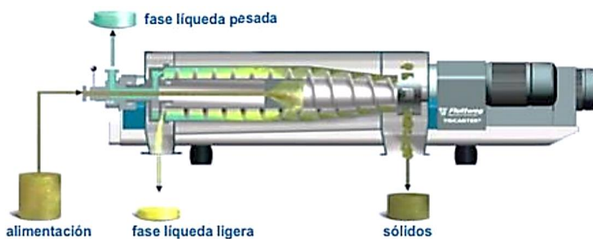
Figura 1-19 Flujo de los líquidos y sólidos en una Tecnología Flottweg
