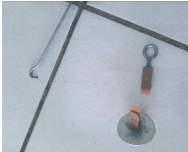
Figura 3- 10 Momento de ruptura del bioplástico obtenido
