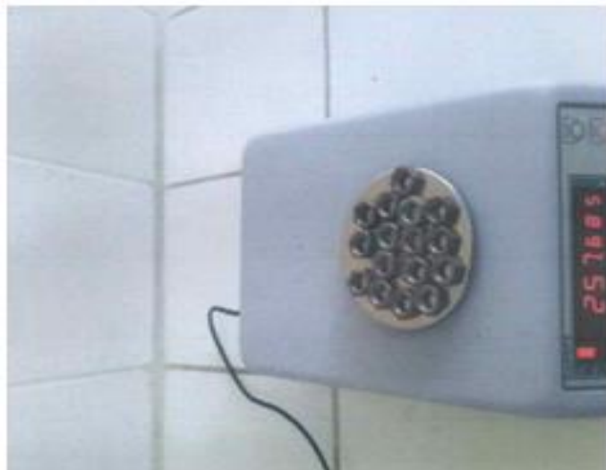
Figura 3- 8 Pesos utilizados para la prueba de resistencia del bioplástico obtenido
