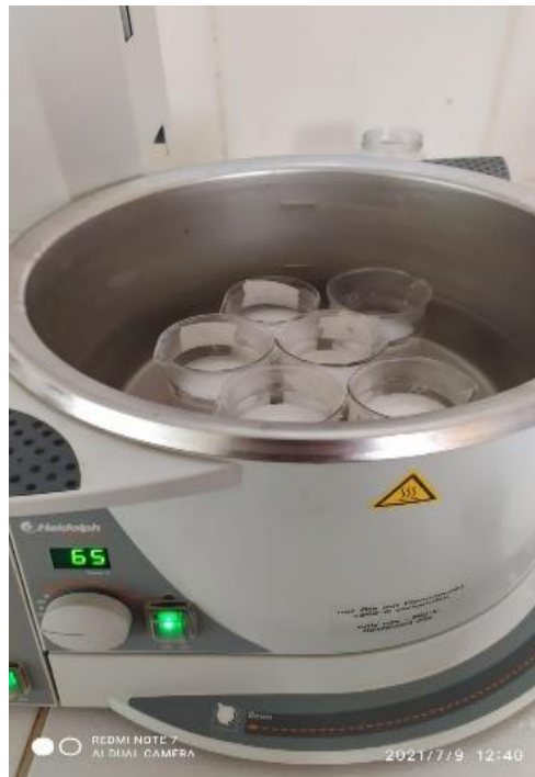
Figura 3- 3 Proceso de gelatinización
