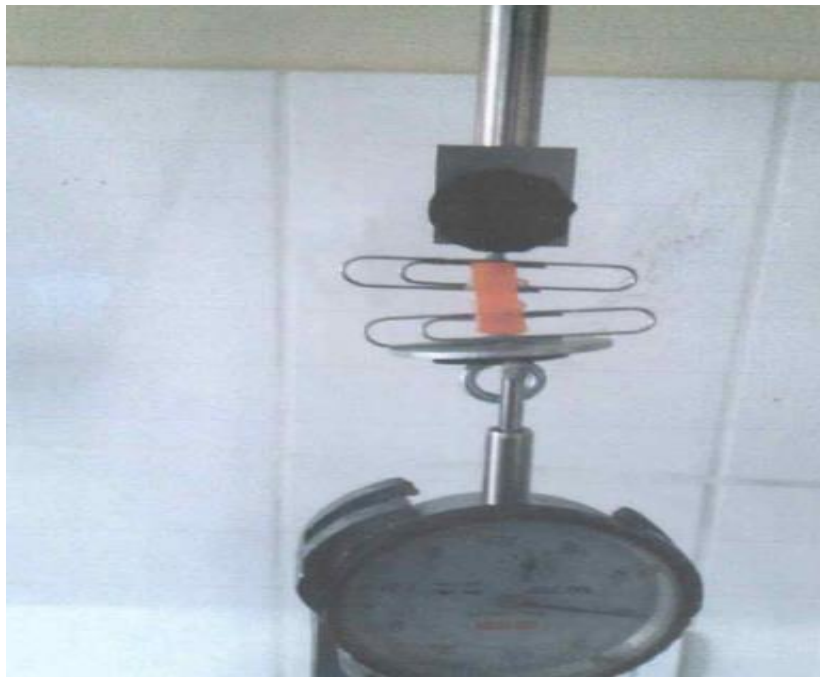
Figura 3- 9 Equipo utilizado para medir la resistencia del bioplástico obtenido
