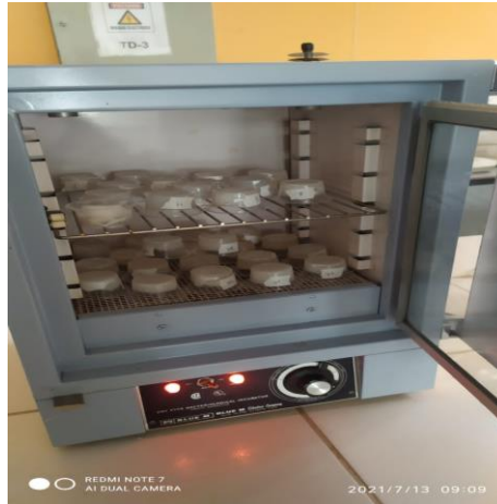
Figura 3- 6 Secado de las muestras de bioplástico
