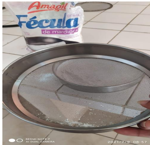
Figura 3- 2 Proceso de tamizado de la fécula de yuca
