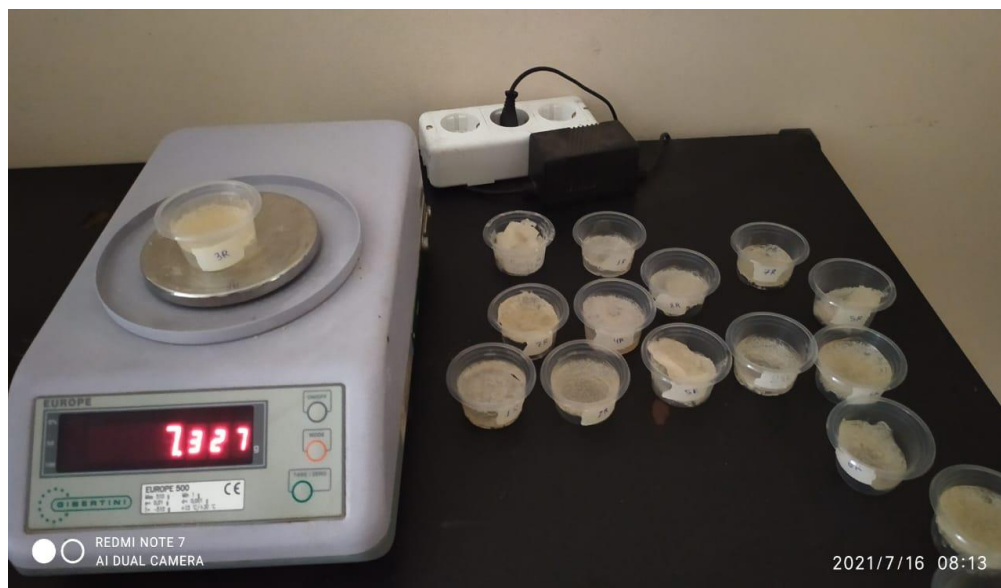
Figura 3- 5 Pesado de las muestras obtenidas de bioplástico
