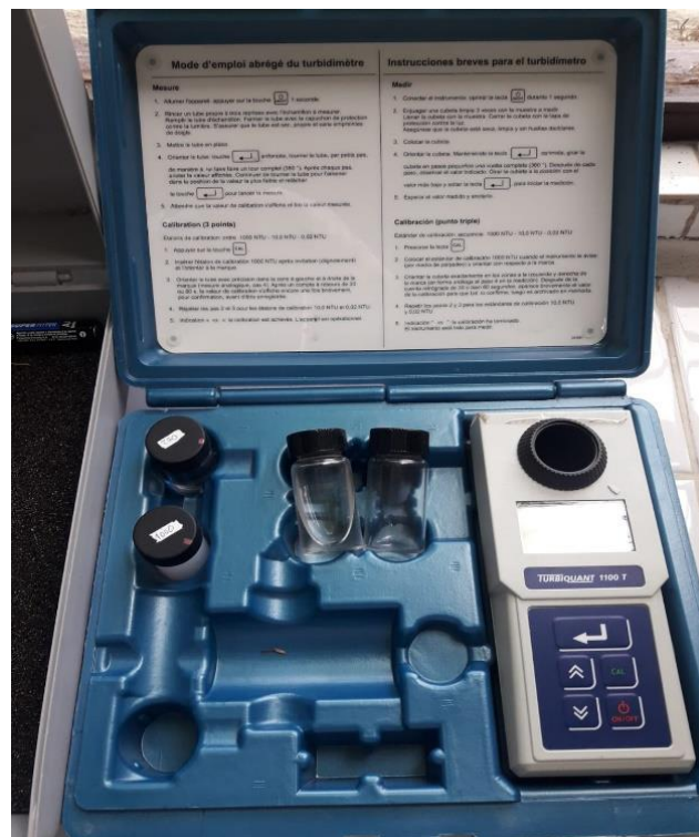
Figura 2- 29: Equipo Turbiquant 1100 T
