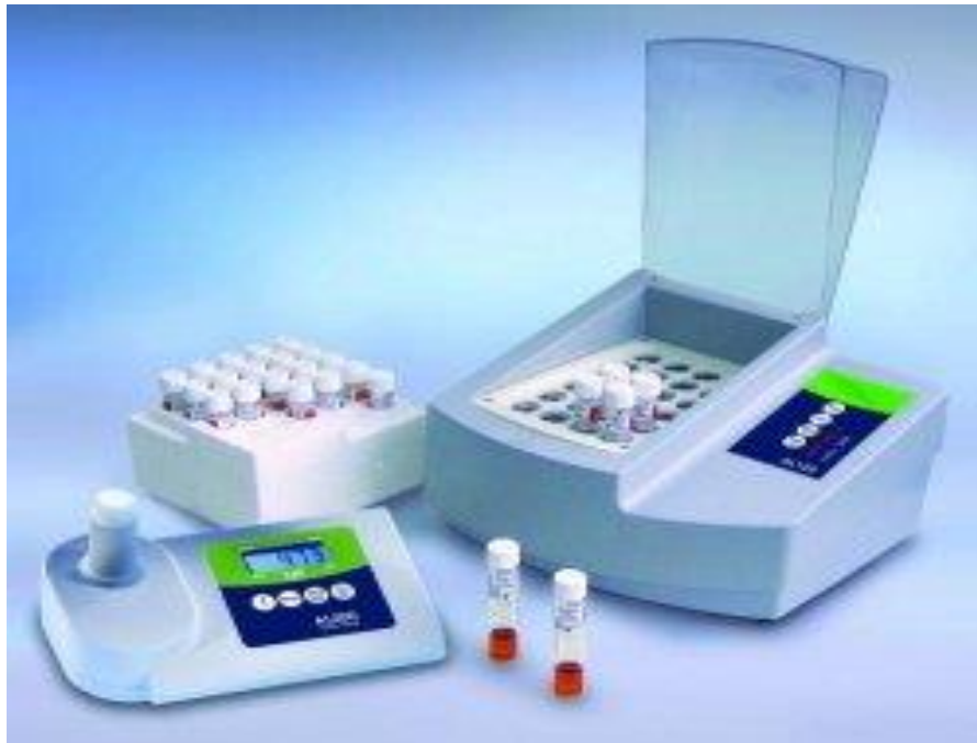
Figura 1- 18: medición de DQO
