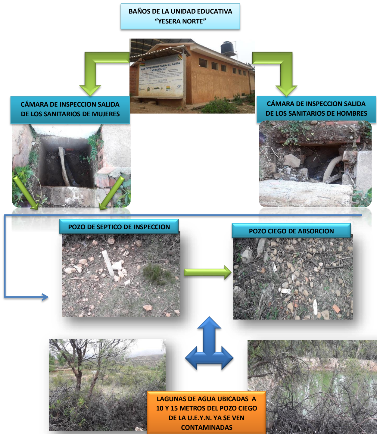
Figura 2- 13: Proceso actual de las aguas residuales generadas por los sanitarios de La Unidad Educativa “Yesera Norte”
