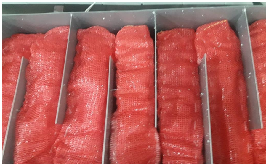
Figura 2- 20: Rellenado de las bolsas en el Biofiltro
