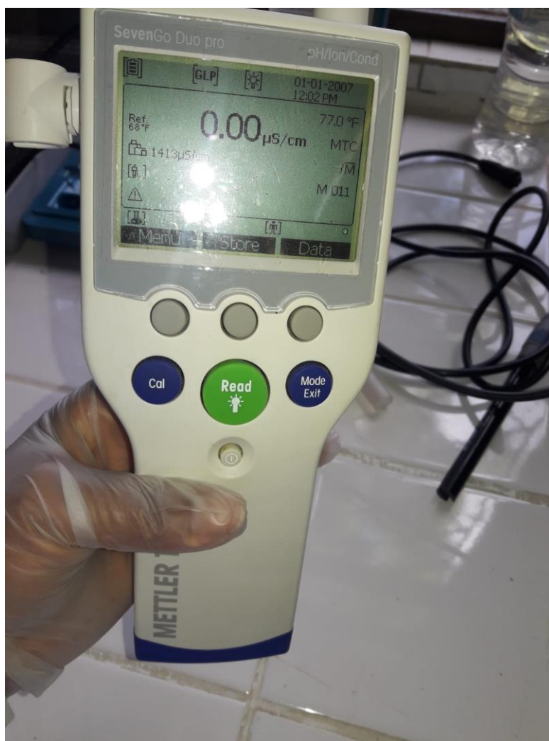
Figura 2- 31: Equipo de conductividad eléctrica
