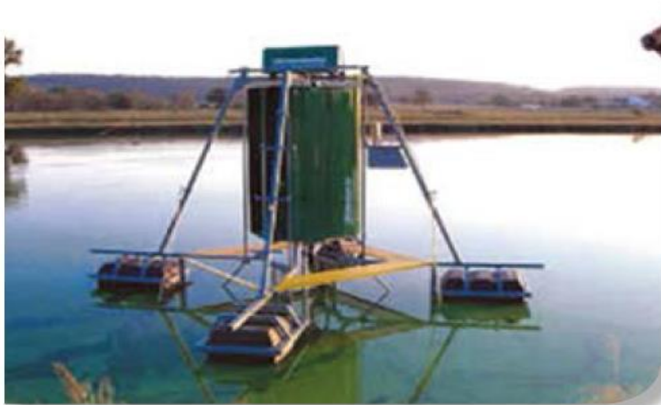
Figura 1- 10: Sistema de aireación superficial
