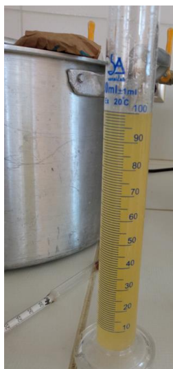
Figura Anexo 2-3 Medición de parámetros en la chicha antes de la destilación (°Baumé)
