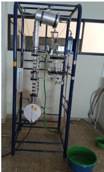
Figura Anexo 3-1 Torre de destilación
