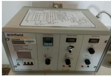
Figura Anexo 3-3 Controlador de la torre de destilación
