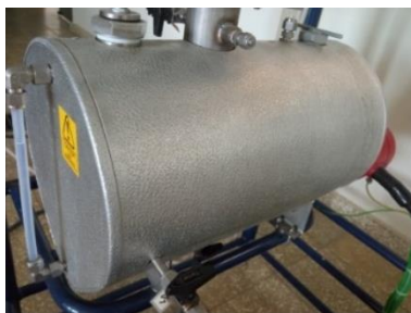
Figura Anexo 3-2 Reboiler
