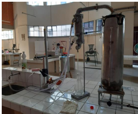
Figura III-8. Equipo: Destilador por arrastre de vapor y recolección de Aceite Esencial
