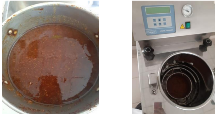
Figura III-12. Preparación de la materia para la hidrólisis hidrotérmica y el equipo utilizado
