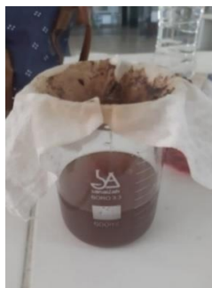
Figura III-17. Filtración con liencillo
