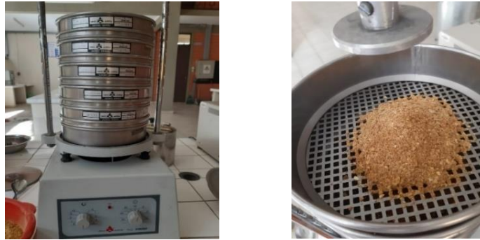
Figura III- 11. Tamizado de la materia prima
