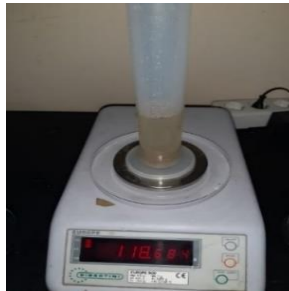
Figura III-16. Medida de Densidad de la dilución
