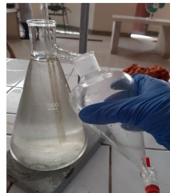
Figura III-8. Equipo: Destilador por arrastre de vapor y recolección de Aceite Esencial
