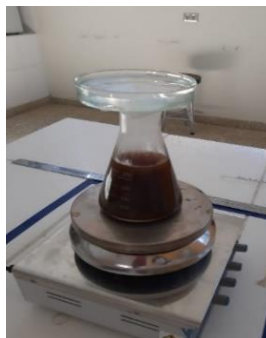
Figura III-14. Matraz Erlenmeyer con muestra en el equipo de agitación magnética
