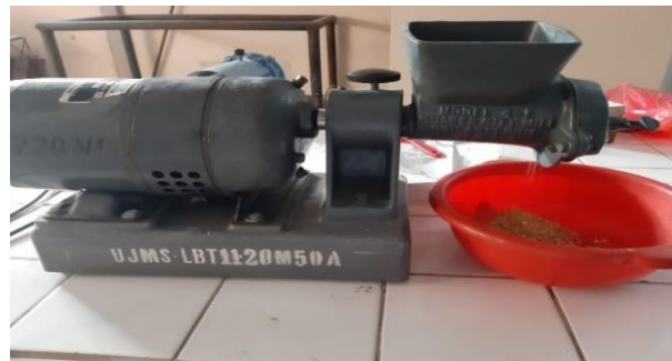
Figura III- 10. Equipo y trituración de la materia Prima
