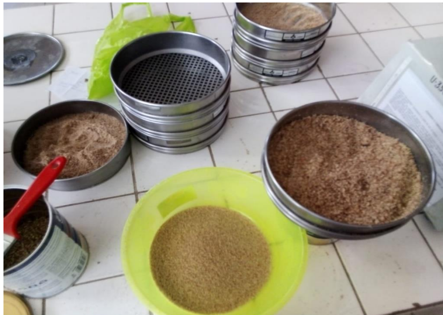
Figura 2-10 Tamizado de la Materia Prima
