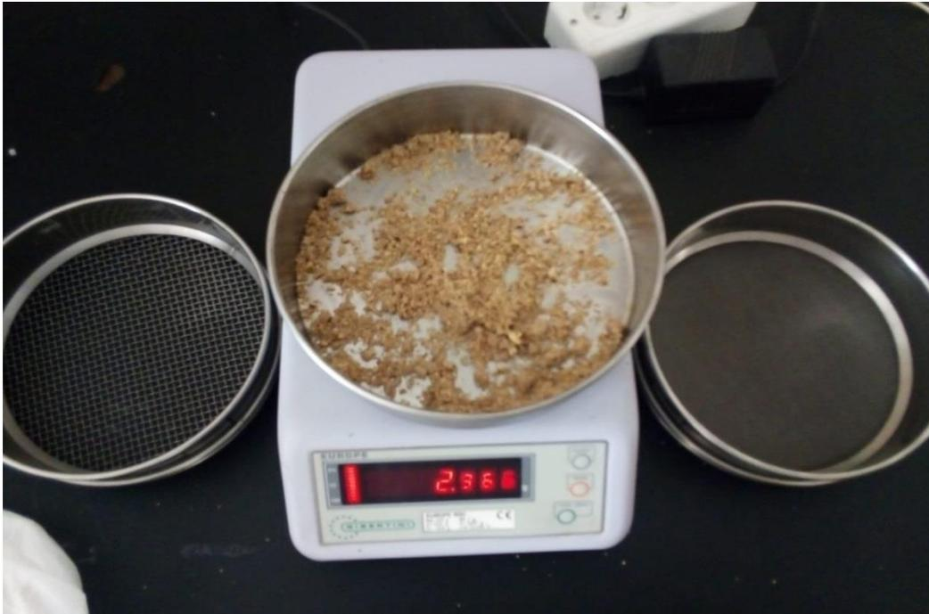
**Foto E-8** Clasificación y pesaje de los rechazos en cada malla para el análisis granulométrico
