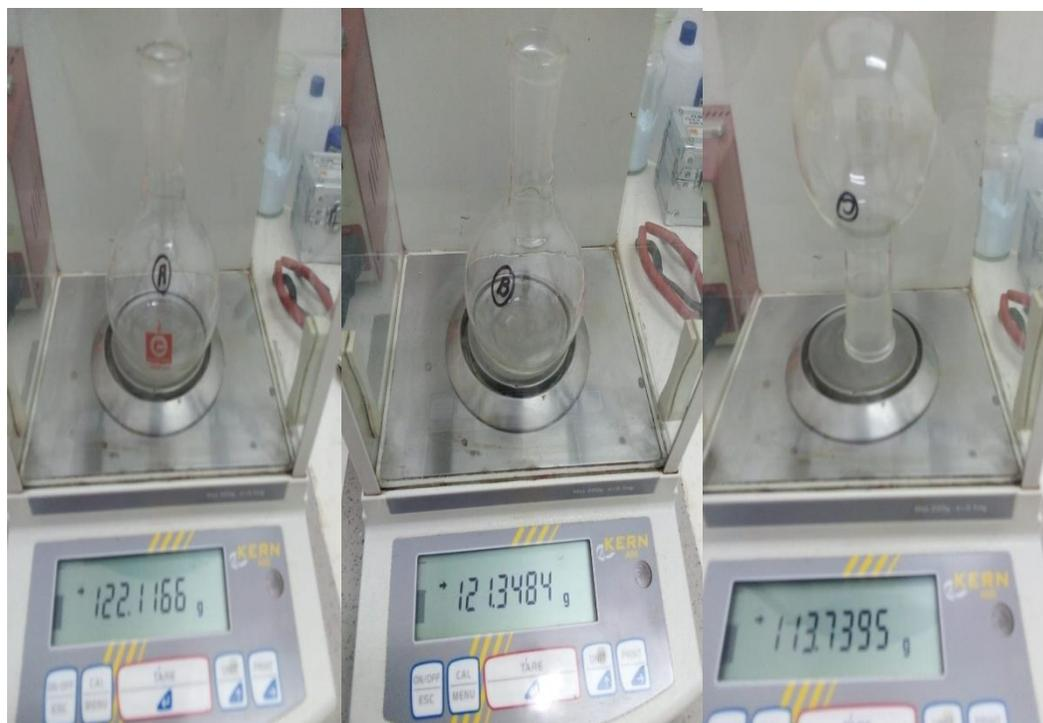
Fotos E-10, E-11, E-12 Material tarado y pesado listo para usar en la extracción
