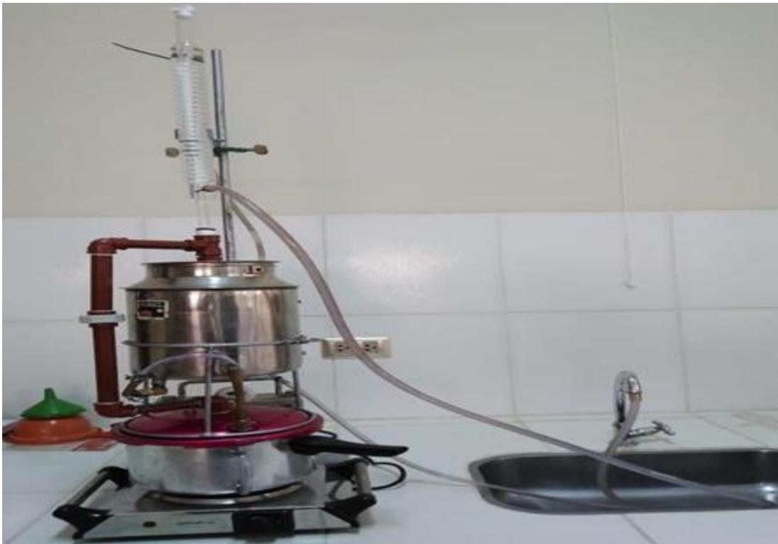
**Foto E-15** Extracción con el Soxhlet Industrial de Aceite Crudo de Nuez Pecan
