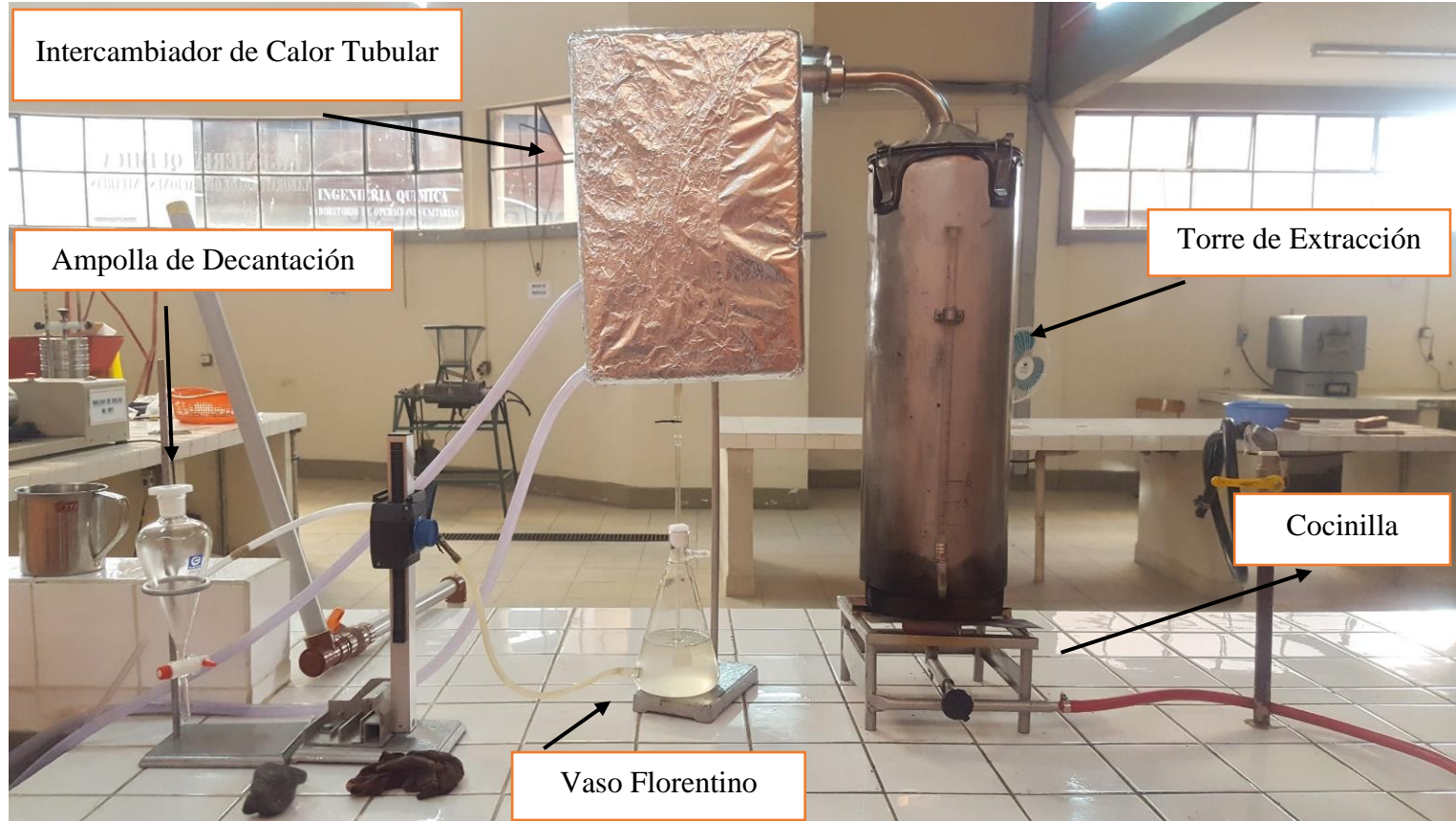
Fotografía 2- 20 Equipo de Destilación
