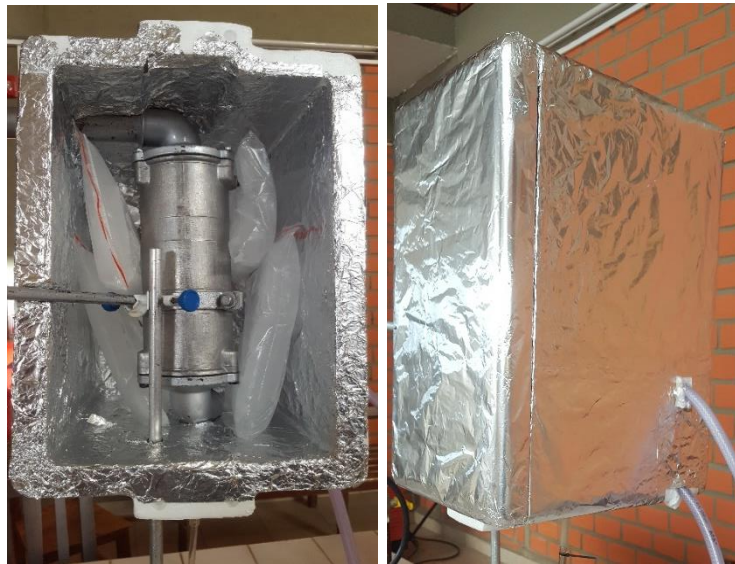
Fotografía 2- 19 Modificación del Intercambiador de Calor
