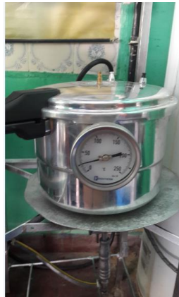
Imagen III - 14 Tanque de extracción
