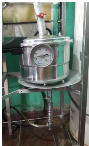
Imagen III - 13 Tanque generador de vapor
