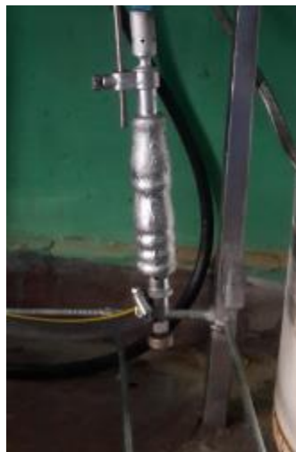
Imagen III - 12 Soplete conectado a gas natural.
