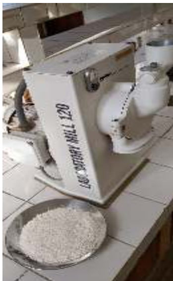
Figura 2.8 MOLIENDA DEL POROTO EN MOLINO DE MARTILLO
