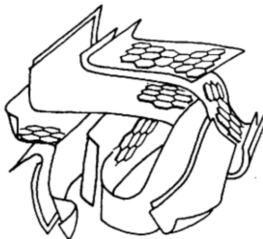
Ilustración I-3. Representación esquemática de la estructura de un carbón activado
