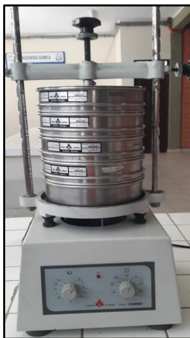
Ilustración II-19. Proceso de tamizado de las borras de café
