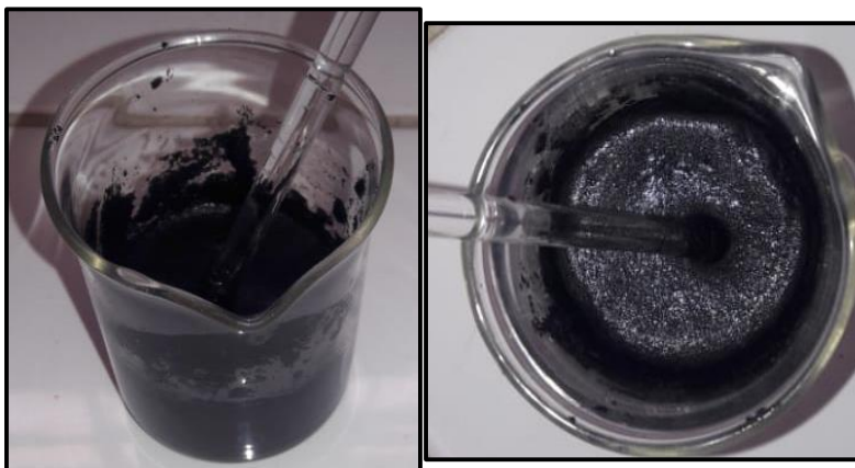
Ilustración II-22. Impregnación de las borras de café
